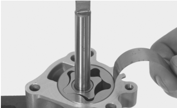
FOLGA ENTRE O ROTOR EXTERNO E A CARCAÇA DA BOMBA:
