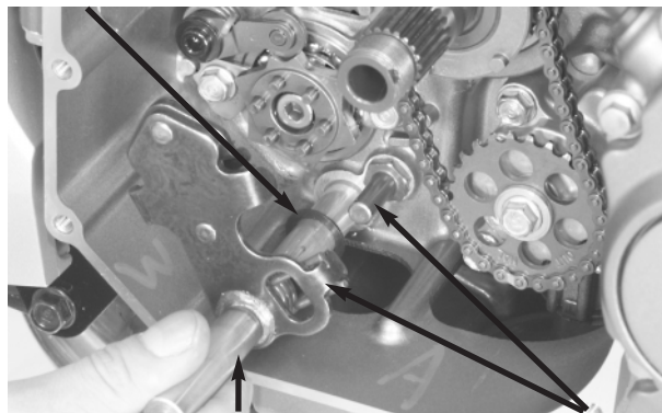
EIXO DE MUDANÇA DE MARCHAS ALINHE ARTICULAÇÃO DO PEDAL DE CÂMBIO PARAFUSO
