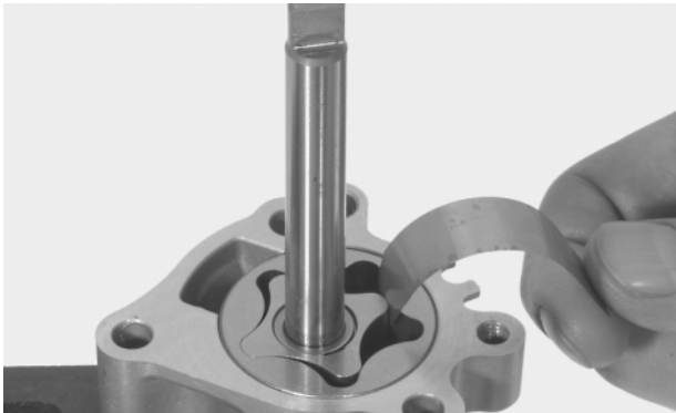
FOLGA ENTRE O ROTOR EXTERNO E A CARCAÇA DA BOMBA:
