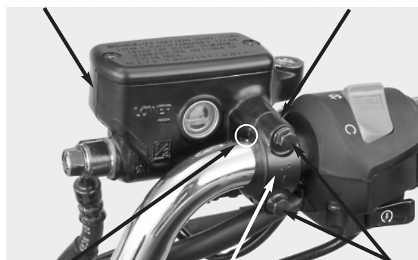
MARCA DE PUNÇÃO MARCA "UP" PARAFUSOS ESPELHOS RETROVISORES
