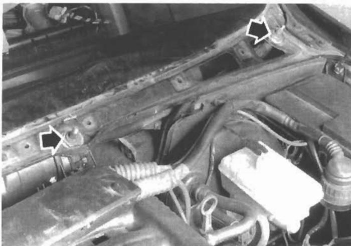
Tornillos de fijación del mecanismo de limpiaparabrisas.
