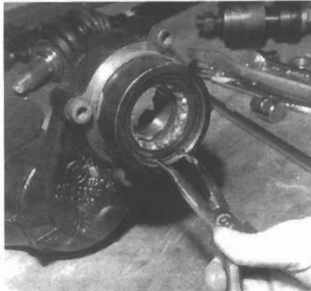
Desmontaje del anillo de sujeción del rodamiento.
