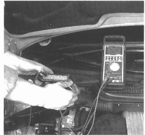
Medición en los bornes de la UC.
