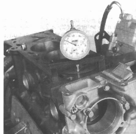
Medición de la altura de un pistón con un comparador.
