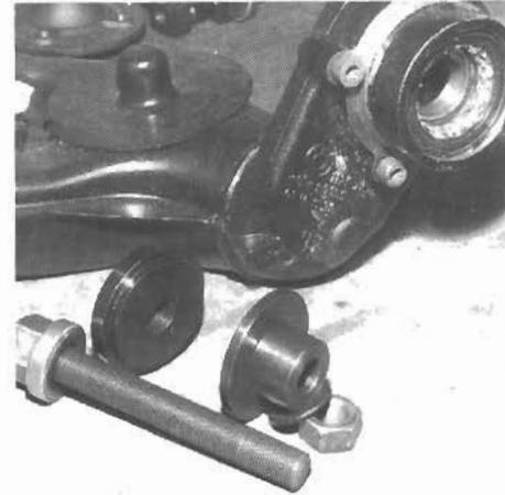
Colocación del rodamiento y vista del sistema de calado con tornillo.
