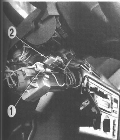
Desmontaje de la columna de dirección.
