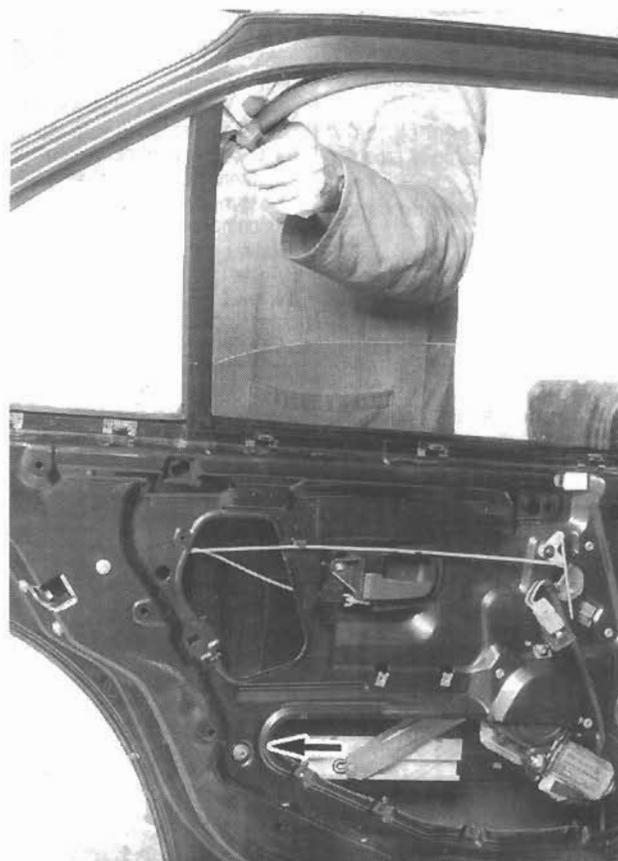
Desmontaje de una luna de puerta trasera. Quitar el tornillo de fijación del rail de guía y sacar la grapa.
