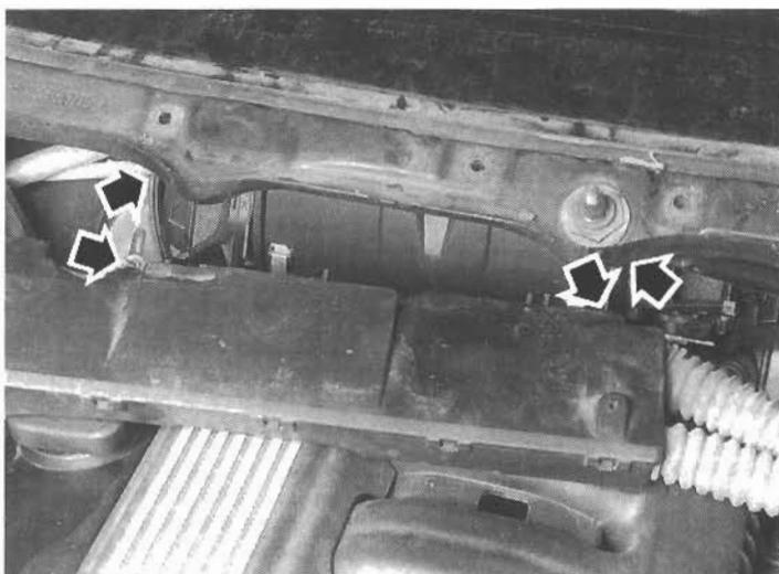
Tornillos de fijación del ventilador de calefacción.
