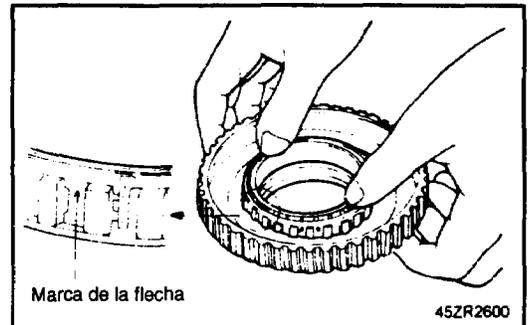
8. Aplicar gelatina de petróleo a la placa extremo del anillo exterior, para mantenerla en el anillo exterior. Instalar la placa extremo al embrague.
