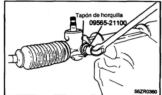
5. Quitar de la caja de engranajes el muelle de horquilla, goma amortiguadora y horquilla de soporte.
