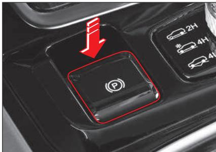
1. Libere el interruptor EPB con el interruptor de encendido en posición ON o el motor funcionando.
