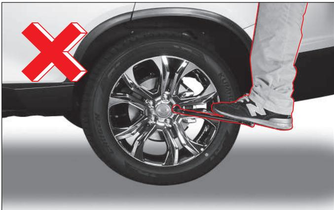
No ajuste demasiado las tuercas de la rueda porque podrían dañarse. No ajuste demasiado las tuercas de la rueda presionando la llave inglesa con el pie o utilizando un tubo.
