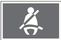
Esta luz de advertencia parpadea y la alarma suena durante 6 segundos cuando el interruptor de arranque se ajusta en posición "ON" a menos que los cinturones de seguridad del conductor y el pasajero (EU) estén bien abrochados. Esta operación de recordatorio se detiene cuando el conductor se ajusta el cinturón de seguridad incluso durante su período de operación.
