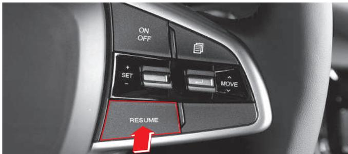
Si las condiciones de parada del cruceo automático se cumplen durante la activación del cruceo automático, la función del control de cruceo se desactiva. Sin embargo, la última velocidad establecida que está memorizada en la UCE, se reanudará al presionar el botón RES.
