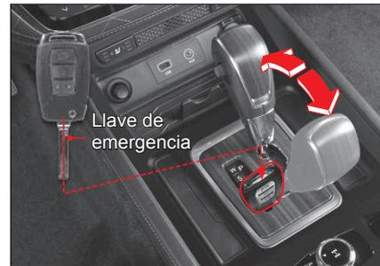
3. Ajuste la palanca de cambios en posición "N" luego de presionar el botón de liberación de bloqueo de la palanca mientras presiona el pedal de freno.
