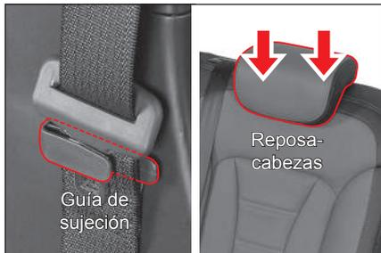
1. Para prevenir daños en el cinturón de seguridad, insértelo dentro de la guía de sujeción.
