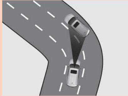
Durante la conducción en vías curvilíneas, el AEBS puede reconocer un vehículo en otro carril como un vehículo que va por delante y activar advertencias y fuerza de frenado innecesarias. Siempre tenga cuidado del tráfico y reduzca la velocidad del vehículo presionando el freno, si es necesario.
