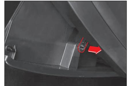
3. Desmonte el seguro de apertura en la parte inferior derecha de la guantera.
