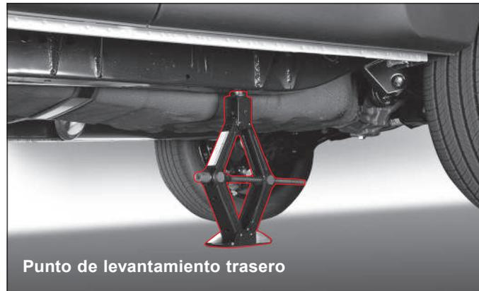
3. Coloque el gato directamente debajo de los puntos de levantamiento de tal modo que la parte superior del gato contacte el punto de levantamiento del vehículo.
