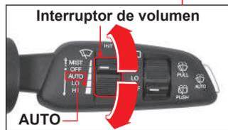
La velocidad de limpieza es ajustable mediante el interruptor de volumen con el interruptor de limpiaparabrisas en posición **AUTO**.
