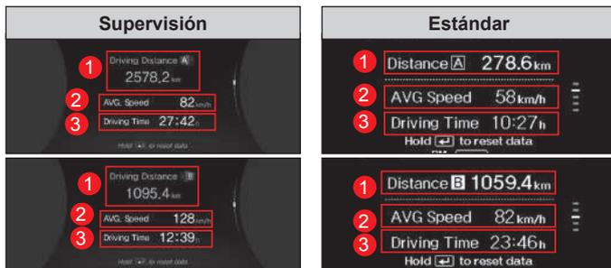
Se muestra la distancia recorrida individual (km), la velocidad promedio del vehículo (km/h), y la hora de conducción (hh:mm).
