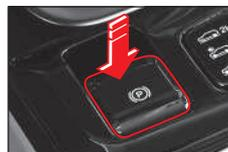
Pulse el interruptor EPB mientras presiona el pedal de freno.
