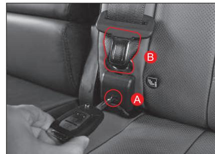
Inserte la llave de emergencia en el orificio del acople auxiliar (A) para pulsar el dispositivo de bloqueo. En este punto, cerciése de que el seguro auxiliar del cinturón de seguridad se (B) retracte lentamente.
