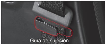
Si no está utilizando el cinturón de seguridad posterior o intenta plegar el asiento posterior, inserte el acople en la guía de fijación en la pared lateral.
