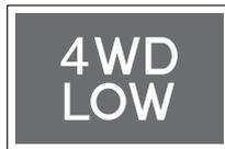
Al cambiar el modo de conducción a "4L", este indicador parpadea hasta que la operación de cambio está completa. Cuando la operación de cambio de modo a 4L está completa, el indicador se apaga.
