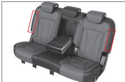
Los airbags laterales para asientos posteriores están incorporados en los lados de los respaldos del asiento. Este airbag se despliega ante una colisión lateral que cumpla las condiciones de despliegue del airbag para proteger a los ocupantes en los asientos posteriores.
