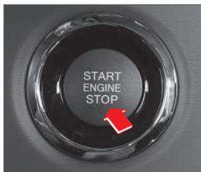
Si es necesario apagar el motor en una situación de emergencia o en un accidente, presione y sostenga el interruptor de encendido durante 3 o más segundos o presiónelo ligeramente 3 veces en un lapso de 1.5 segundos. El interruptor de encendido se ajustará en posición ACC.
