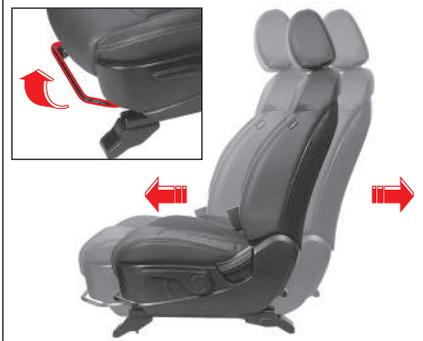
Para mover el asiento hacia adelante o hacia atrás, jale y sostenga la palanca de deslizamiento del asiento y mueva el asiento a la posición deseada. Luego, libere la palanca.
