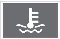
Cuando la temperatura del refrigerante del motor es anormalmente alta, la luz de advertencia de sobrecalentamiento del motor parpadea y suena la alarma. Cuando esto sucede, detenga el vehículo en un lugar seguro y espere a que se enfríe el motor. Para más información, refiérase al Capítulo 6 “Cuando el motor se sobrecalienta”.
