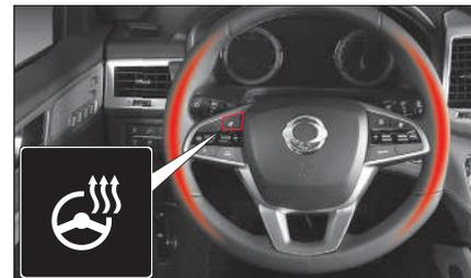
Al presionar este interruptor con el motor en funcionamiento se enciende el indicador en el panel de instrumentos y se activa la calefacción integrada en el volante. Al presionar nuevamente el interruptor se desactiva el indicador y la calefacción se apaga.
