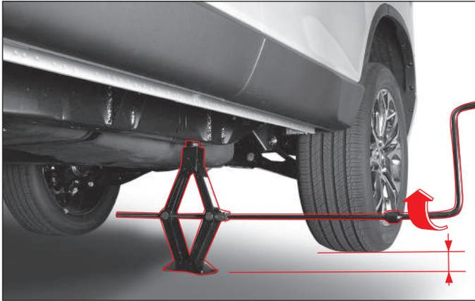
4. Combine el gato, la llave inglesa para tuercas de neumáticos y la conexión del gato como se muestra en la figura. Gire la llave combinada en sentido horario para levantar el vehículo hasta que el neumático esté a 3 cm del suelo.
