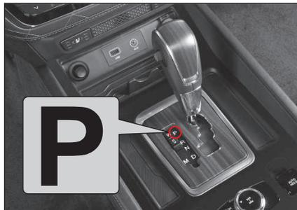
2. Apague el encendido con el pedal de freno presionado y la palanca de cambios en posición "P".
