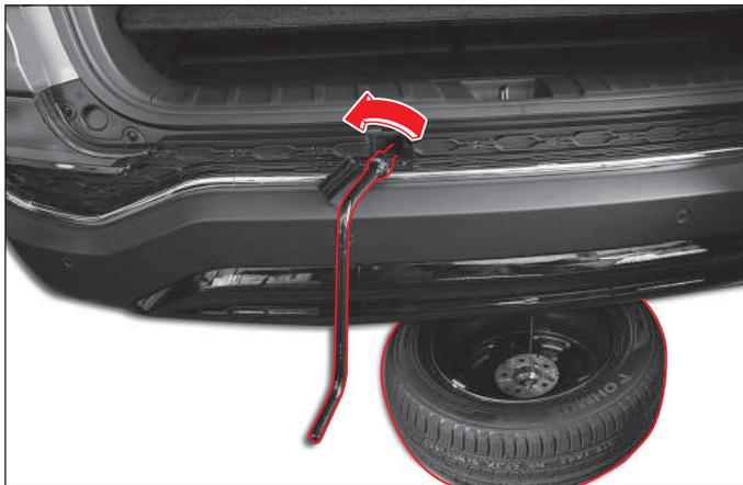
1. Inserte la barra de conexión en el orificio ubicado en la parte central superior del parachoques después de abrir la puerta trasera, y luego conecte la llave para tuercas de neumáticos.
