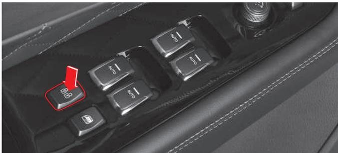
Al presionar el interruptor de BLOQUEO/DESBLOQUEO de puerta (botón tipo resorte) con todas las puertas, incluida la puerta trasera, bloqueadas, el estado de las puertas cambia entre desbloqueadas y bloqueadas cada vez que se presione el interruptor.
