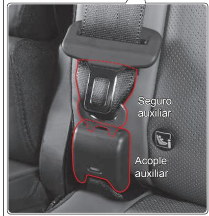
Asegúrese de que el seguro auxiliar del cinturón de seguridad central posterior quede insertado en el acople auxiliar cuando no lo utilice.
