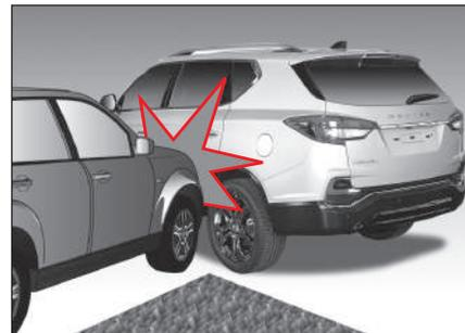
Es posible que las bolsas de aire delanteras no se inflen en una colisión lateral, porque los ocupantes se mueven en la dirección de la colisión y, por lo tanto, el despliegue de las bolsas de aire delanteras no proporciona la protección adecuada.
