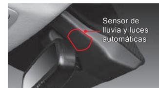
Es sensible a la cantidad de lluvia para hacer funcionar el limpiaparabrisas en forma automática (Para información detallada de la operación del limpiaparabrisas, haga referencia a la sección de perillas de limpiaparabrisas y del lavador de vidrios).
