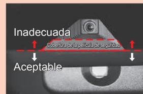
No instale películas de seguridad sobre el área de detección FCM. De lo contrario, podría ocasionar fallas de funcionamiento y operación anormal en los sistemas relacionados.
