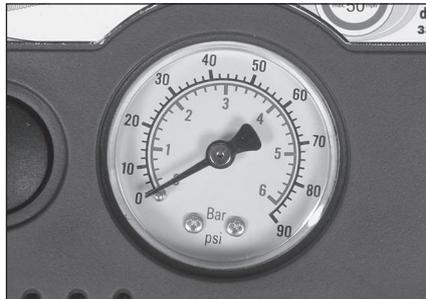
8. Espere hasta que la presión alcance el nivel especificado (34 PSI, 2.3 bar) mientras verifica la válvula de presión del kit de reparación.
