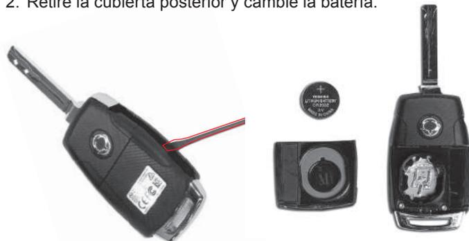
3. Utilice baterías de igual especificación únicamente (CR2032). Asegúrese de que la batería sea instalada con la polaridad correcta.
