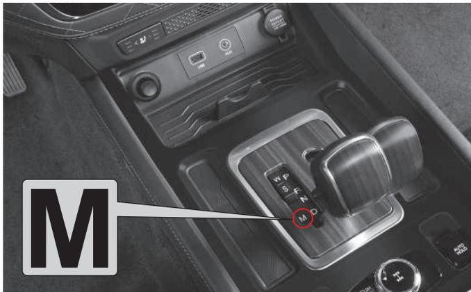
Si el selector de cambios está en ésta posición, puede realizar los cambios usando la punta del interruptor en la palanca y la punta cambia a los costados del volante.
