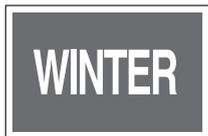
Al presionar dos veces el interruptor de modo (E → P → W) en el panel de interruptores del lado izquierdo, se activará el indicador de modo invierno.
