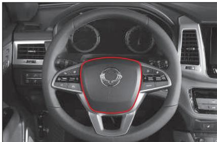
El airbag del conductor está ubicado en la parte central del volante. Este airbag protege la cabeza del conductor ante una colisión frontal.
