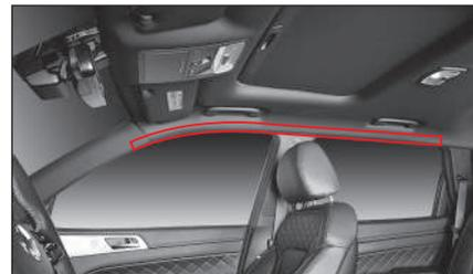
Los airbags de cortina están incorporados dentro del área sobre las puertas delanteras/posteriores, justo debajo de la sección inferior del techo en ambos lados. Este airbag se despliega ante una colisión lateral que cumpla las condiciones de despliegue del airbag para proteger a los ocupantes en los asientos posteriores.
