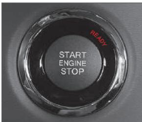
Para encender el motor, pulse el pedal de freno y presione el botón de encendido/parada del motor con la palanca de cambios en la posición P o N.
