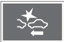
El indicador de advertencia AEBS se activa al girar el interruptor de encendido hacia la posición "ON". El indicador se muestra por un corto período de tiempo y luego se oculta.
