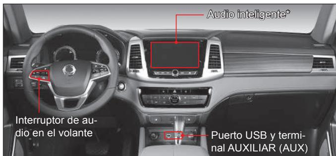
El sistema de audio inteligente tiene un panel táctil de 8 pulgadas y controles de audio en el volante. Puede conectar un dispositivo externo a este sistema utilizando las terminales USB (para iPod) y AUX. El sistema es compatible con tarjetas SD (para reproducir música)/cámaras de vista posterior/cámaras de vista circundante/compartir redes WiFi (para Android), y Bluetooth.
