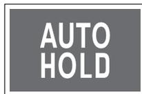
Al operar el interruptor de RETENCIÓN AUTOMÁTICA, el sistema de RETENCIÓN AUTOMÁTICA cambiará al modo LISTO y el indicador "AUTO HOLD" aparecerá en el panel de instrumentos en color blanco.
