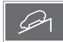
Al presionar una vez el interruptor HDC, la función HDC está lista para ser usada. El indicador HDC verde en el tablero de instrumentos se enciende. Al presionar nuevamente este botón, la función HDC se desactiva y el indicador se apaga.
