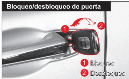
Inserte la llave de emergencia en el orificio para llave y gírela hacia la derecha para desbloquear la puerta.
