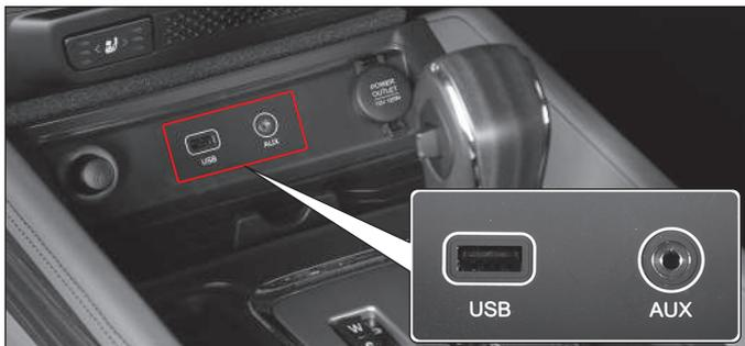
Puede conectar un dispositivo de audio externo incluido un reproductor MP3, CDP, unidades de almacenamiento USB y un iPod (dispositivo de almacenamiento multimedia) al vehículo para reproducir archivos de música o vídeo por medio del sistema de audio del vehículo.
