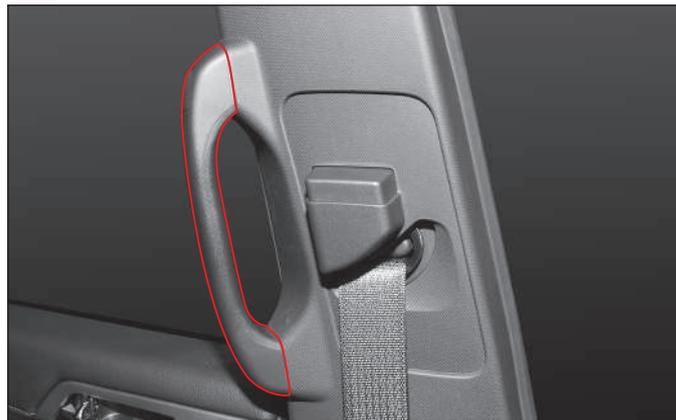
Hay manijas de sujeción en la parte delantera de los asientos posteriores para sujetarse al ingresar al vehículo.
