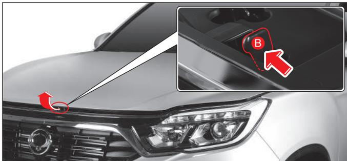
2. Sostenga el capó y ábralo un poco para accionar la palanca de cierre de seguridad (B) utilizando sus dedos y levante el capó por completo.
