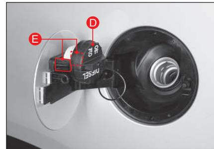
6. Ubique la tapa del depósito de combustible (D) sobre el sujetador (E) incorporado en la parte interna de la cubierta.
