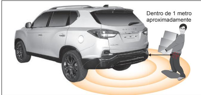
Si el conductor está dentro del área de alcance de la antena de la puerta trasera (dentro de 1 metro de radio desde la parte posterior del vehículo) por 3 segundos, o más, portando una llave inteligente con el modo antirrobo activado, se activará la función de apertura/cierre inteligente de puerta trasera junto con la alarma en las siguientes etapas:
