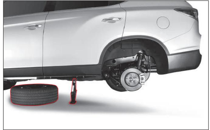
6. Extraiga el neumático y colóquelo debajo de la carrocería del vehículo. Esto minimiza el peligro en caso de que el gato se corra de su posición.
