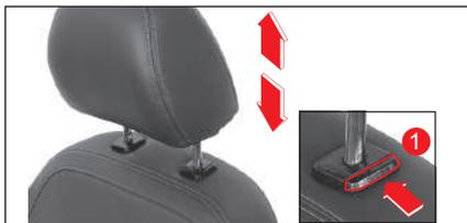
Para levantar el apoyacabeza, jale hacia arriba sin presionar el botón de liberación. Para bajar el apoyacabezas, presione el botón ① de liberación en la parte superior del respaldo del asiento y empuje el apoyacabezas hacia abajo.
