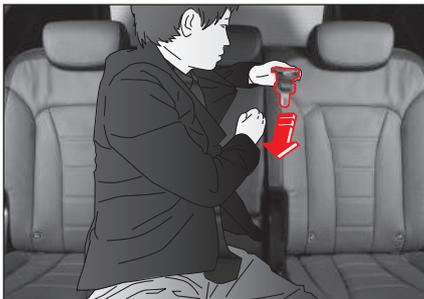
1. Jale hacia fuera la placa del seguro del retractor. Si el cinturón de seguridad está trabado cuando jala hacia afuera, rebobínelo completamente en el retractor, luego jale hacia afuera hasta alcanzar el largo deseado.
