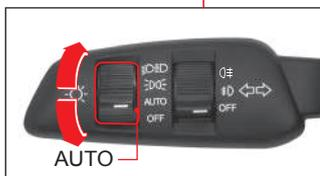
El sensor de lluvia y luz automática percibe la intensidad de iluminación natural para determinar la secuencia de encendido o apagado de los faros delanteros y traseros en forma automática, cuando el interruptor de luces está en la posición "AUTO".
