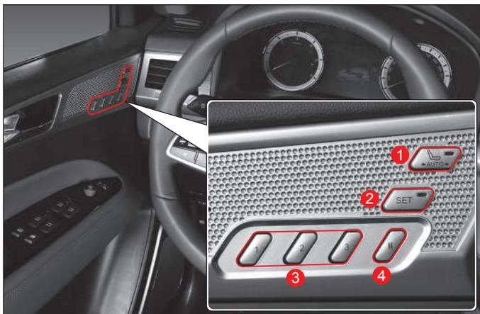
1. Interruptor de encendido/apagado de los controles de acceso fácil para el conductor
