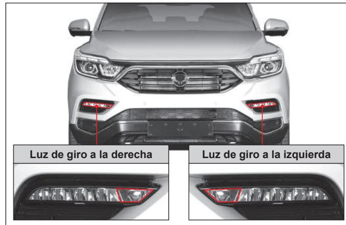
Las luces de giro se encienden automáticamente cuando el vehículo realiza un giro a la izquierda o derecha para mejorar la visibilidad en los lados del vehículo durante la conducción nocturna.
