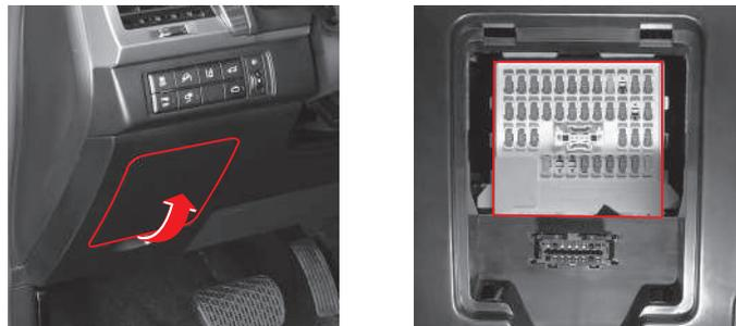
La caja de fusibles está ubicada en la parte derecha del tablero de instrumentos. Para acceder al interior de la caja de fusibles, abra la puerta del conductor y extraiga la tapa de la caja de fusibles con sus dedos.
