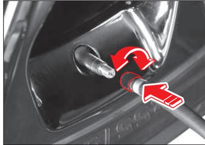
3. Retire la tapa de la válvula de la rueda, en la cual se agregará aire.
