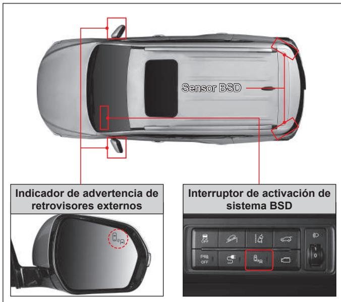
El sistema BSD (Detección de puntos ciegos) detecta un objeto que se aproxima desde el punto ciego izquierdo/derecho posterior donde el conductor no logra ver a través de los espejos retrovisores utilizando los sensores incorporados en las esquinas de los parachoques en ambos lados. El sistema alerta al conductor utilizando advertencias visibles y audibles.
