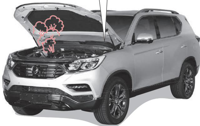
Cuando el motor se sobrecalienta, puede salir vapor o humo del compartimiento del motor. O cuando el medidor de temperatura del refrigerante se acerca a "H". Si esto sucede, se encenderá la luz de advertencia de sobrecalentamiento del motor y sonará una alarma. Detenga el vehículo inmediatamente en un lugar seguro.
