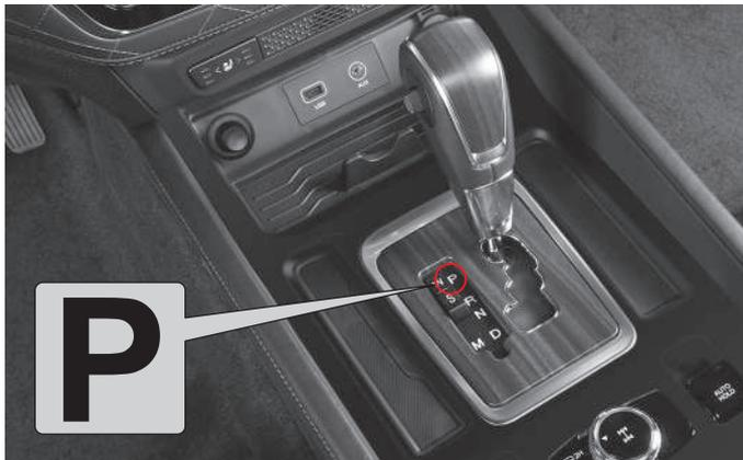
Utilice esta posición para estacionar el vehículo, arrancar el motor, calentar el motor o permanecer en un lugar durante un período de tiempo prolongado.
