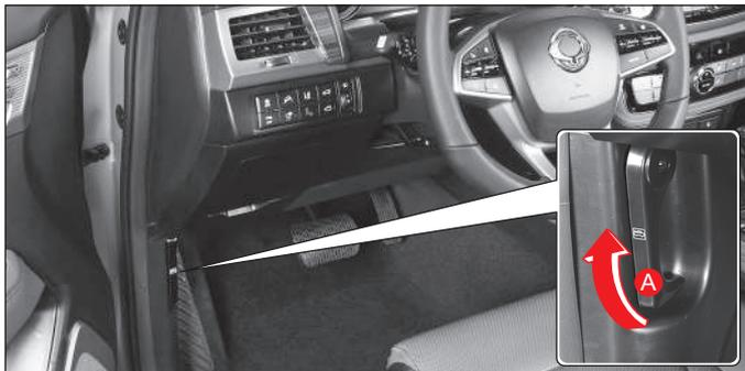
1. Hale la palanca de apertura (A) al lado izquierdo inferior del volante para descorrer el pestillo de la tapa del motor.
