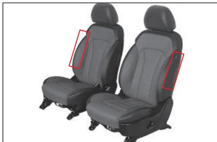
Los airbags laterales para asientos frontales están incorporados al lado del espaldar del asiento del conductor y el espaldar del asiento del pasajero. Este airbag se despliega ante una colisión lateral que cumpla las condiciones de despliegue del airbag para proteger a los ocupantes en los asientos delanteros.
