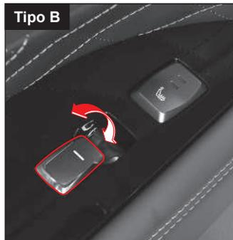
El conductor puede abrir las ventanas utilizando este interruptor de la misma manera que opera el interruptor de ventanas AUTOMÁTICO del conductor/pasajero.
