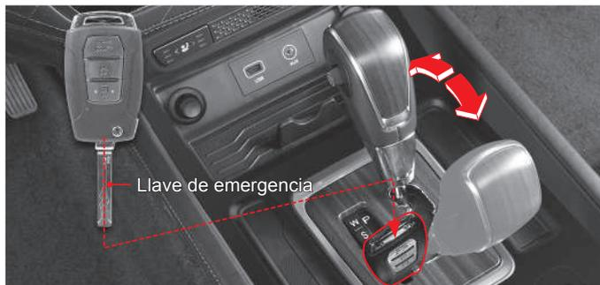
Para pasar de la posición “P” a otra posición, el interruptor de arranque debe estar en la posición ON y el pedal de frenos oprimido. Si no puede cambiar la posición “P” con el interruptor de arranque en la posición ON y el pedal de frenos oprimido:
