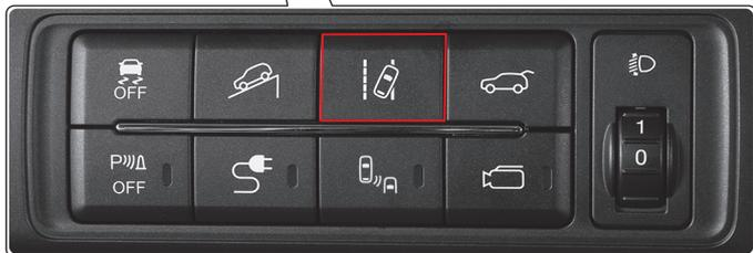
El sistema es activado presionando el interruptor con el estado "ON" definido. Una vez activado el sistema, el indicador LDWS se ilumina en el panel de instrumentos.
