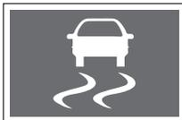
La luz se enciende cuando el interruptor de encendido se ajusta en "ON" y se apaga al transcurrir 4 segundos.
