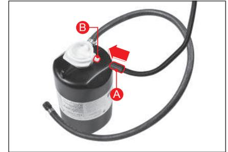
3. Conecte la manguera de aire (A) del kit de reparación a la unidad de reparación con el recipiente del sellante (B).
