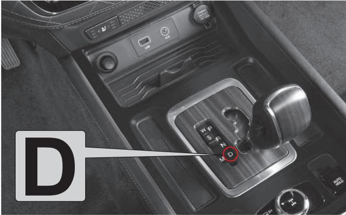
Utilice esta posición para conducción normal. La transmisión se cambia automáticamente del primer cambio hasta el sexto de acuerdo al nivel de presión en el acelerador y la velocidad del vehículo.
