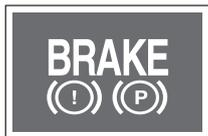
Esta luz indicadora se enciende cuando se aplica el freno de mano y/o el nivel de líquido de frenos es inferior al nivel especificado.
