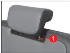
Para levantar el apoyacabeza, jale hacia arriba sin presionar el botón de liberación. Para bajar el apoyacabezas, presione el botón de liberación (1) en la parte superior del respaldo del asiento y empuje el apoyacabezas hacia abajo.
