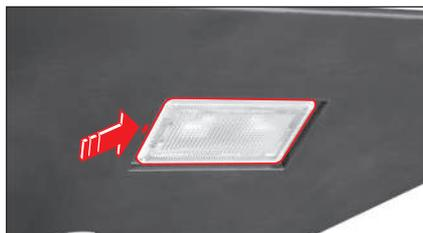
1. Desconecte el cable negativo de la batería y extraiga la cubierta utilizando un destornillador de cabeza plana.
