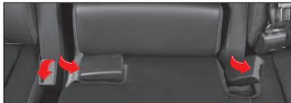
Cuando no utilice el cinturón de seguridad posterior, inserte la hebilla en el acople de almacenamiento tal como se muestra en la imagen.
