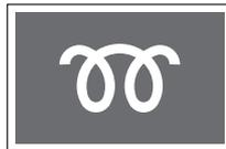
Este indicador se enciende cuando el interruptor de arranque se coloca en la posición "ON" y se mantiene encendido por un corto período de tiempo o se apaga inmediatamente. Cuando las bujías de arranque están suficientemente calientes, la luz se apagará. En los vehículos equipados con motor de tipo inyección directa, este indicador puede encenderse por períodos muy breves o no encenderse.
