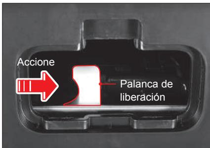
Su vehículo está equipado con una palanca de liberación de emergencia de la puerta trasera en la parte inferior de la puerta trasera. Cuando alguien queda atorado involuntariamente en el compartimiento de equipaje.
