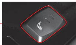
Presione el interruptor de calefacción de asientos con el motor operando para seleccionar uno de 3 niveles en la secuencia siguiente: OFF → Nivel 2 → Nivel 1 → OFF. El indicador correspondiente al nivel seleccionado se iluminará en color amarillo.
