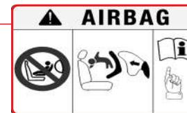
La etiqueta de seguridad del airbag está ubicada en ambos lados del visor solar lateral de los pasajeros indicando al ocupante para que comprenda la peligrosidad de los airbags. Lea y siga las instrucciones e información de seguridad antes de conducir.
