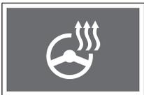
La luz de advertencia de calefacción en el volante se activa o desactiva al encender o apagar el interruptor de calefacción en el volante con el encendido en posición "ON", o el motor funcionando.
