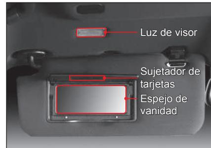
Abra el visor y deslice la cubierta para revelar el espejo. La luz del visor se activa al deslizar la cubierta.
