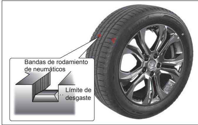
Los neumáticos en su vehículo tienen instalados indicadores de desgaste de bandas de rodamiento entre las ranuras de las bandas. El neumático debería ser reemplazado cuando el indicador de desgaste aparece en dos o más ranuras adyacentes.
