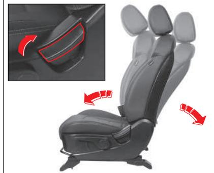
Para cambiar el ángulo de inclinación del respaldo del asiento, inclínese un poco hacia delante y levante la palanca. Luego, reclínese hacia atrás y libere la palanca en la posición deseada. Después de realizar este ajuste, asegúrese de que la palanca vuelva a su posición original y que el respaldo del asiento quede bloqueado.
