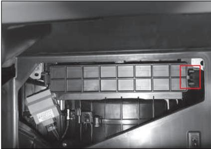
4. Extraiga la cubierta del filtro de aire presionando la parte lateral derecha de la cubierta.
