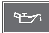
Este indicador de advertencia se activa cuando la presión del aceite se reduce debido a un bajo nivel de aceite del motor.
