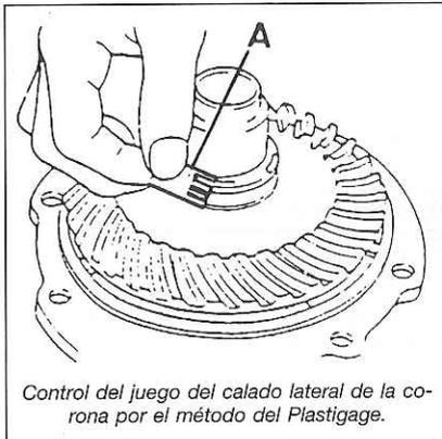
**DESARMADO Y SUSTITUCION DE LOS RODAMIENTOS DEL PAR CONICO**
