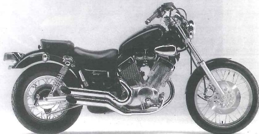
*A partir de la versión 89, la XV 535 incorpora un depósito propiamente dicho, permaneciendo el depósito de debajo del sillín. El disco delantero tiene su pista de rozamiento taladrada y el anagrama Virago aparece en las tapas laterales. Está disponible en dos versiones: con manillar inclinado y curvado o con manillar horizontal.*
