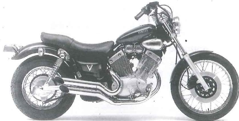
*La XV 535 modelo 88 aún no lleva el anagrama Virago en sus tapas laterales. Este primer modelo va equipado con un falso depósito. El disco delantero macizo es otra de sus particularidades.*
