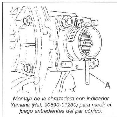
Montaje de la abrazadera con indicador Yamaha (Ref. 90890-01230) para medir el juego entredientes del par cónico.
