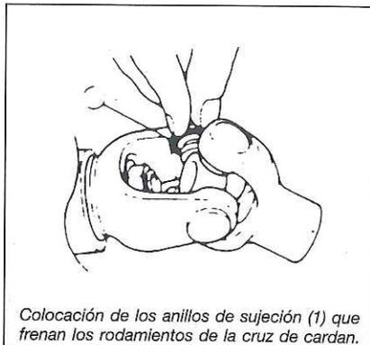
Colocación de los anillos de sujeción (1) que frenan los rodamientos de la cruz de cardan.
