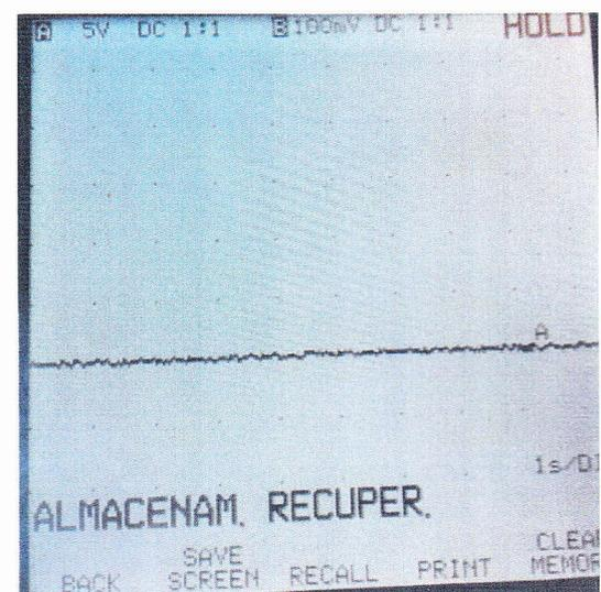
**CONTROL MEDIANTE OSCILOSCOPIO (REFERENCIA)****SONDA LAMBDA 1****Terminales módulo**
