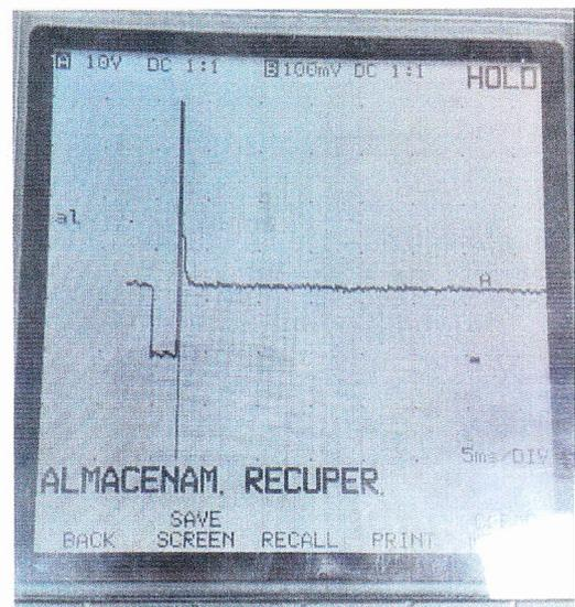
**SEÑAL (-) CANISTER****Terminales módulo**
