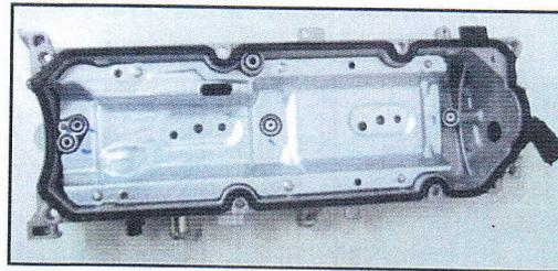
En el motor 1.4 EVO FIRE, el canal de aceite del variador de fase se abre para el flujo de aceite que emite la primera tapa del cojinete del árbol de levas. Todo el control de envío y retorno está integrado en la tapa.
