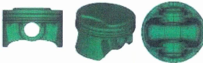
Los pistones presentan tres clases "A, B, C" con medidas diferentes, de esa forma habrá mayor control del espacio de montaje entre cilindro y pistón y mejor NVH – *Noise, Vibration, Harshness* (Ruido, vibración y aspereza). La identificación de las clases en el pistón se realiza mediante grabación en la cabeza del mismo. En el block, otra identificación representa la clase del cilindro correspondiente al pistón.
