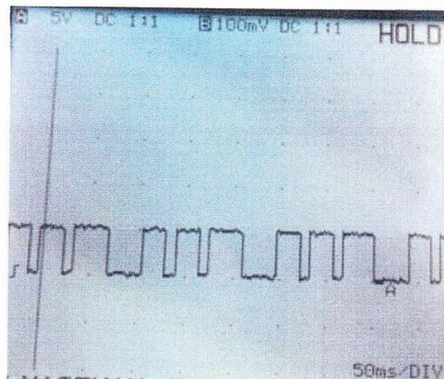
**CONTROL MEDIANTE OSCILOSCOPIO (REFERENCIA)****CONTROL (-) INYECTOR****Terminales módulo**
