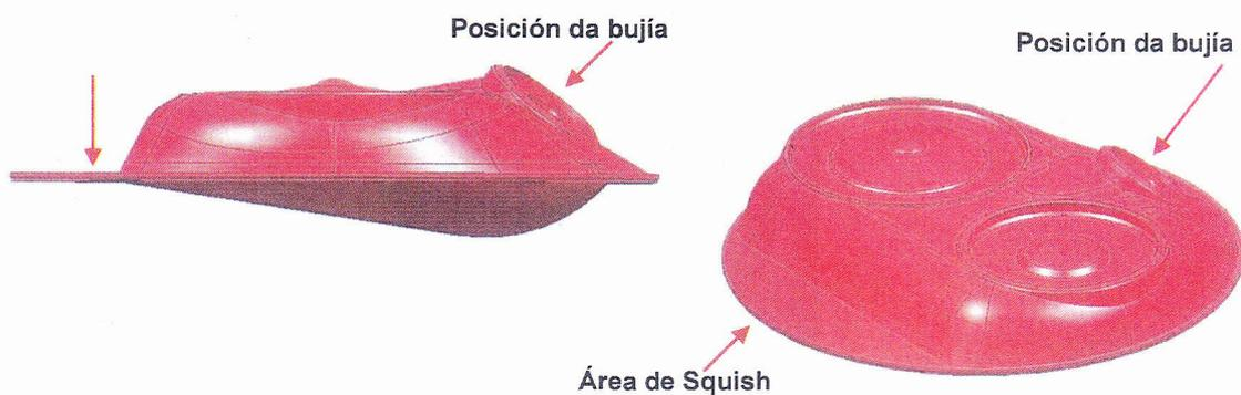
La posición del área de *squish*, en el lado opuesto de la bujía privilegia la regularidad de la combustión en marcha lenta. El diseño de la nueva cámara de combustión tiene el máximo volumen debajo de la bujía de ignición, permitiendo mayor velocidad en la combustión.
