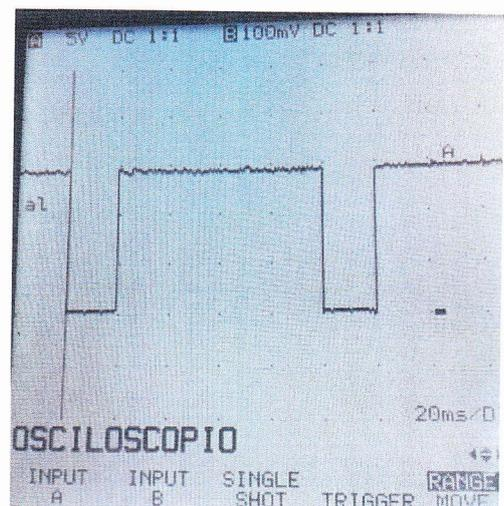
**CONTROL MEDIANTE OSCILOSCOPIO (REFERENCIA)****SONDA LAMBDA 2****Terminales módulo**
