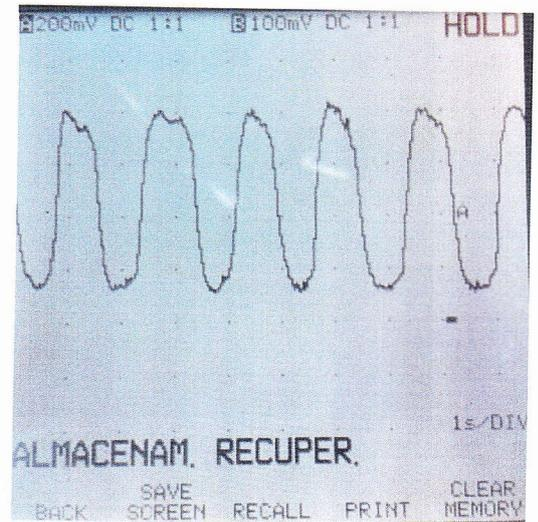
**MASA DEL CALEFACTOR SONDA 2****Terminales módulo**
