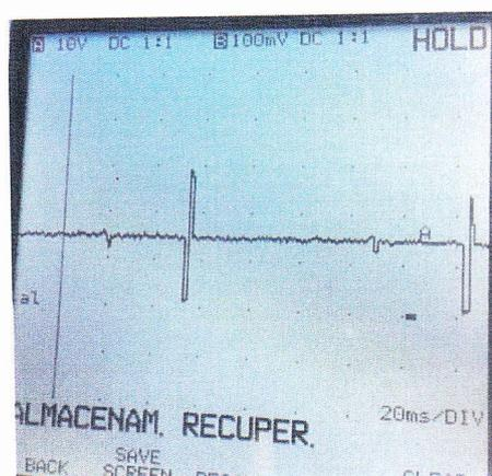
**SEÑAL CKP (+) (Sensor de RPM's)****Terminales módulo**
