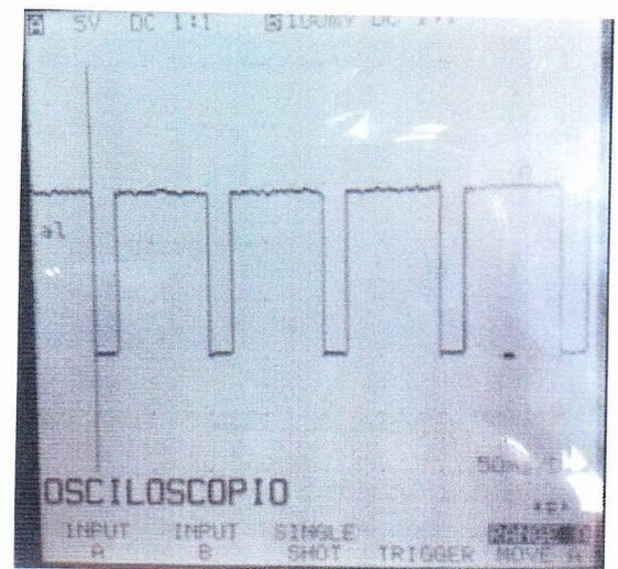
**CONTROL MEDIANTE OSCILOSCOPIO (REFERENCIA)****BOBINA DE IGNICIÓN (-)****Terminales módulo**
