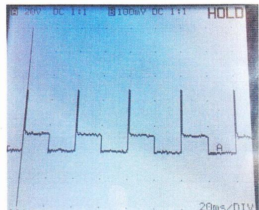
**CONTROL MEDIANTE OSCILOSCOPIO (REFERENCIA)****C CAN ALTO****Terminales módulo**
