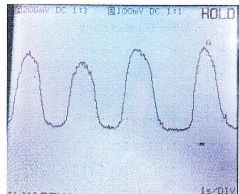
**MASA DEL CALEFACTOR SONDA 1****Terminales módulo**
