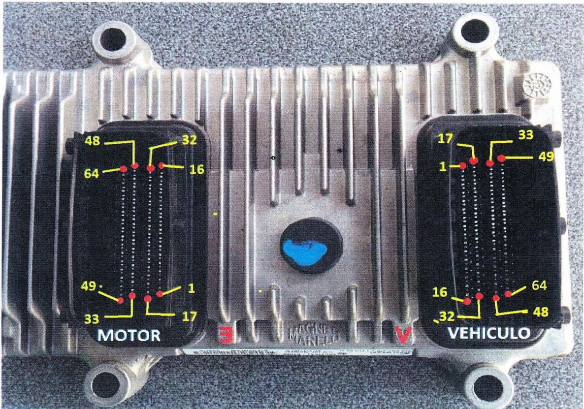
**TABLA DE INSPECCIÓN DE MODULO DE CONTROL DE MOTOR**
