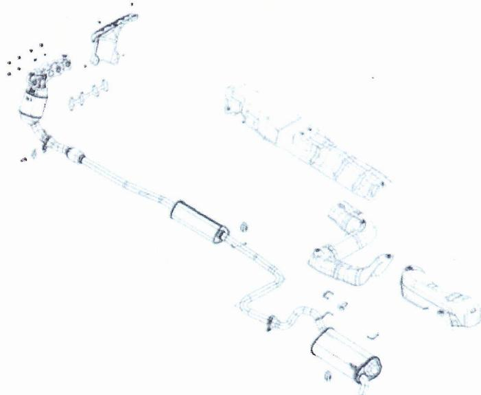
Este sistema está compuesto de un silenciador central y uno posterior, mediante el cual garantiza la comodidad acústica y atiende los niveles más bajos de emisiones de contaminantes, de acuerdo con la legislación vigente.
