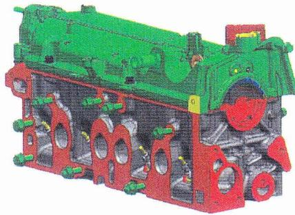
La cámara de combustión cuenta con conductos especiales, los que fueron proyectados para posibilitar alta turbulencia dentro de la cámara.
