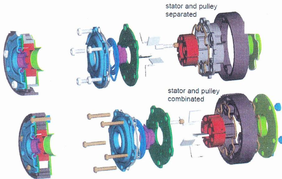
El CVCP es un sistema electro-hidráulico controlado por el módulo de control electrónico del motor que posibilita un régimen de funcionamiento especial del motor en cargas parciales. En él, el eje mando trabaja extremadamente retrasado, proporcionando el control de la cantidad de aire que entra en el motor y, consecuentemente, de la potencia producida por el mismo.
