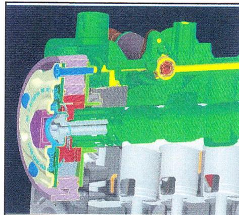
El CVCP, o variador de fase continuo, se trata de un nuevo sistema de distribución que permite una variación en la fase entre el único árbol de levas y cigüeñal de forma continua.
