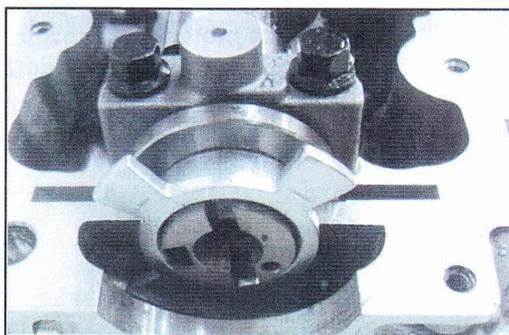
**Atención:** El motor 1.4 EVO FIRE requiere de herramientas de puesta en fase para la distribución. La puesta en fase se realiza con los pistones a media altura.
