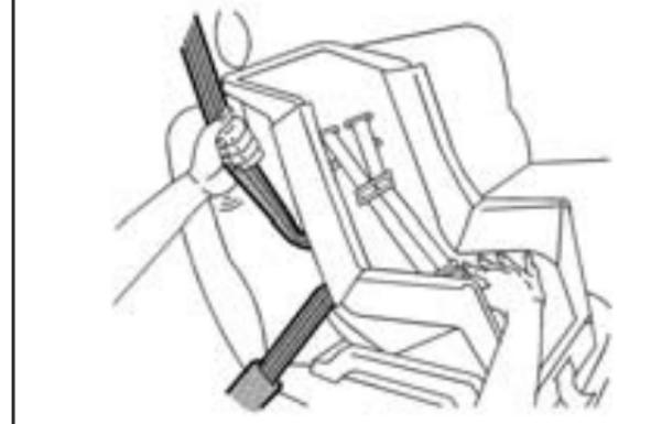
5. Para apretar el cinturón, empuje hacia abajo la sujeción de niños, jale la parte de tórax del cinturón lo cual aprieta la parte de la cadera y enrolle la parte de tórax en el retractor. Si utiliza una silla para niños con vista hacia delante, use su rodilla para empujar hacia abajo el asiento mientras aprieta el cinturón.
