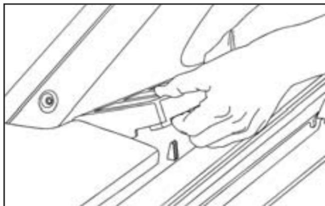
2. Sujete los extremos de la rejilla y jale, extrayéndola del vehículo. Lave el desagüe con agua limpia.
