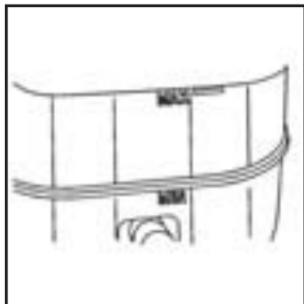
El nivel de aceite debe estar arriba de MIN. Si no lo está, mande revisar el sistema de frenos hidráulicos para ver si hay una fuga.
