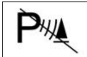
Se puede apagar el sistema presionando el botón de cancelación de asistencia de estacionamiento en reversa junto al radio. Se enciende la luz indicadora para mostrar que el sistema está apagado.
