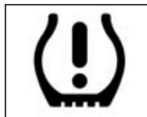
Cuando se detecta presión baja en una llanta, el sistema de monitoreo enciende una luz de advertencia de llantas bajas ubicada en el grupo de instrumentos.
