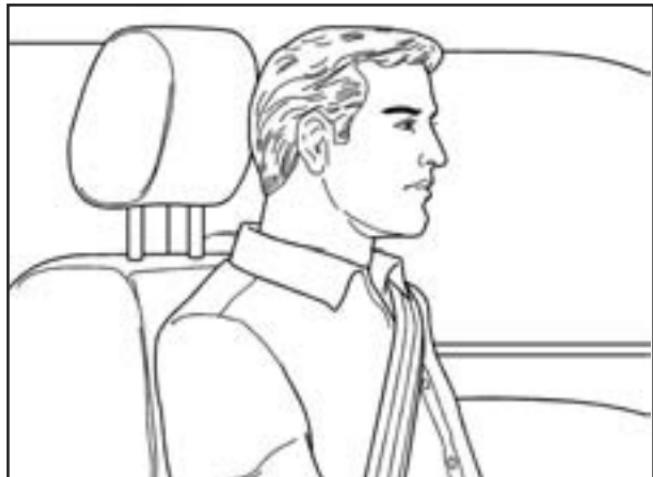
Ajuste la cabecera de manera que quede a la misma altura que la parte superior de la cabeza del ocupante. En esta posición se reduce la probabilidad de sufrir lesiones en el cuello en caso de un accidente.
