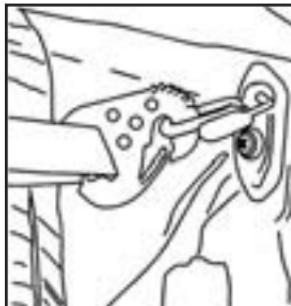
1. Fije el sistema de bandas en el área de carga fijando los seis pasadores del sistema a los puntos de amarre en uno de los lados del área de carga.
