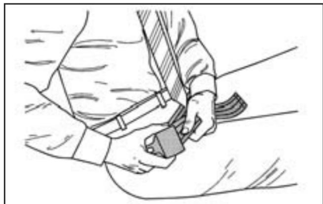
Para alargar el cinturón, incline la chapa y recórrala sobre el cinturón.
