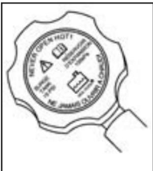
1. Puede quitar el tapón de presión del tanque de recuperación del refrigerante cuando el sistema de refrigeración, incluyendo el tapón de presión del tanque y la manguera superior del radiador, ya no estén calientes.
