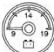
Cuando el motor no está funcionando, pero el encendido está conectado, este indicador le indica el estado de carga de la batería en voltios CD.
