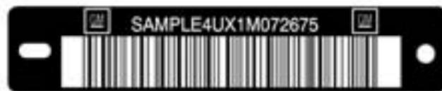
Este es el identificador legal para el vehículo. Aparece en una placa colocada en la esquina delantera del tablero de instrumentos, del lado del conductor. Usted lo puede ver si mira a través del parabrisas desde afuera del vehículo. El VIN también aparece en las etiquetas de certificación y de llantas y partes de servicio, así como en los certificados de título y registro.
