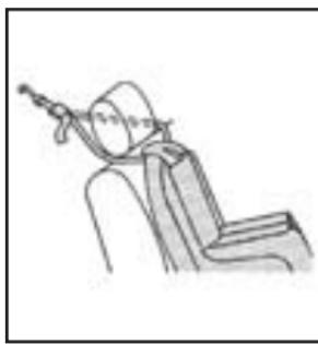
Si la posición que está usando tiene una cabecera ajustable y usted está utilizando una correa doble, pase la correa alrededor de la cabecera.
