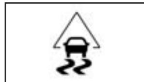
La luz del sistema StabiliTrak® parpadea en el tablero de instrumentos cuando el sistema está encendido y activo.
