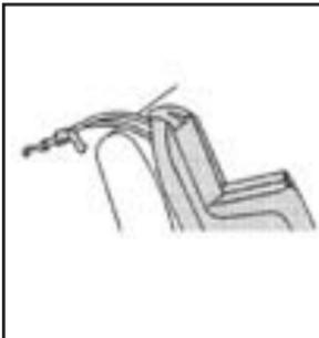
Si la posición que está usando no tiene cabecera y usted está utilizando doble banda, pase la banda sobre el respaldo.
