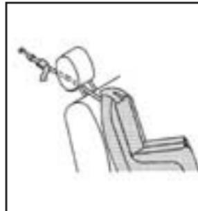
Si la posición que está usando tiene cabecera ajustable y se utiliza una correa única, levante la cabecera y pase la correa bajo la cabecera y entre los postes de ésta.
