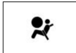
Una luz con el símbolo de bolsa de aire en el tablero de instrumentos indica que las bolsas de aire están listas para funcionar.
