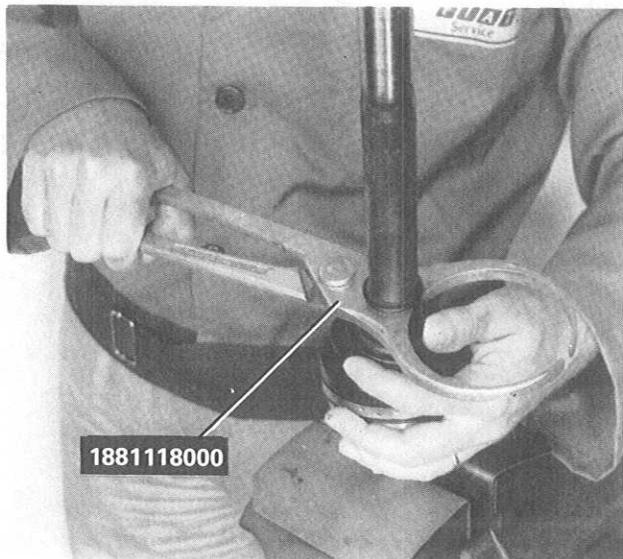
Einsetzen der Manschette des Gleichlaufgelenks
