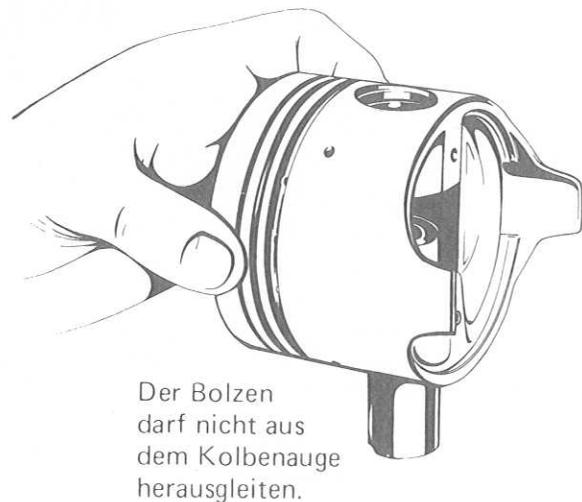
Bedingungen für eine korrekte Passung zwischen Bolzen und Kolben
