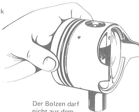
Der Bolzen darf nicht aus dem Kolbenauge herausgleiten.
