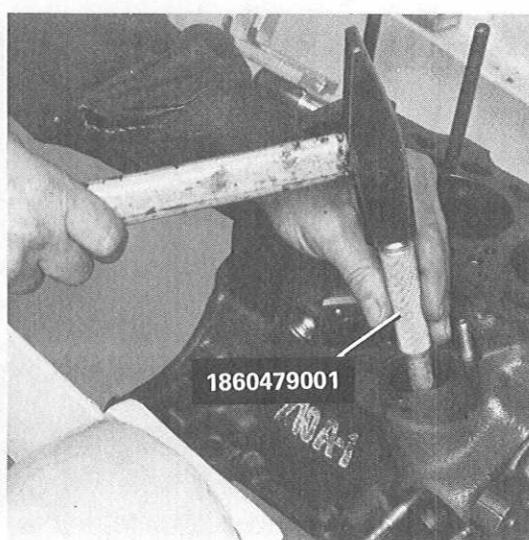
Ausbau der Buchse für das Antriebszahnrad der Ölpumpe und des Zündverteilers
