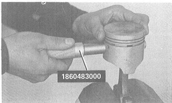
Einsetzen des Kolbenbolzens in die Baugruppe Pleuelstange - Kolben
