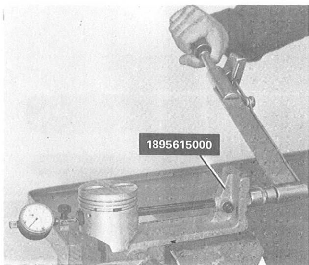
Prüfung der Passung des Kolbenbolzens mit dem Drehmomentschlüssel, der auf ein Anzugsmoment von 1,27 daNm gleich einer Axiallast von 392,4 daN eingestellt ist.
