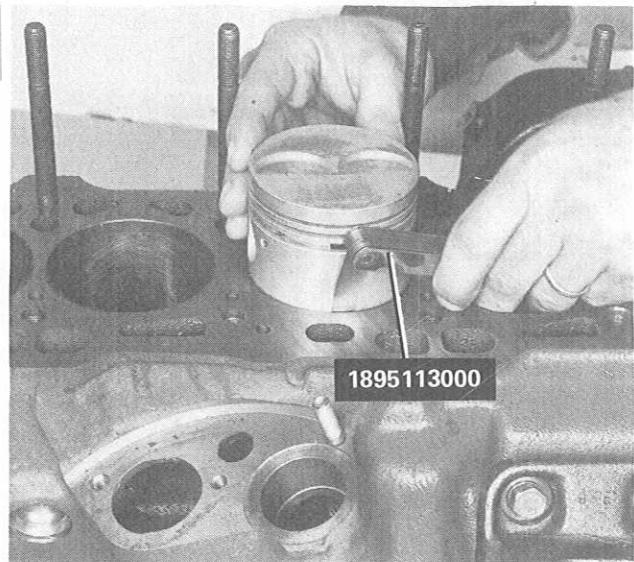
Kontrolle des Passungsspiels zwischen Kolben und Zylinderlaufbuchse
