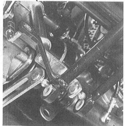
HINWEIS: Die Achswellen befestigen, um zu verhindern, dass sie aus dem Ausgleichgehäuse herausgleiten.
