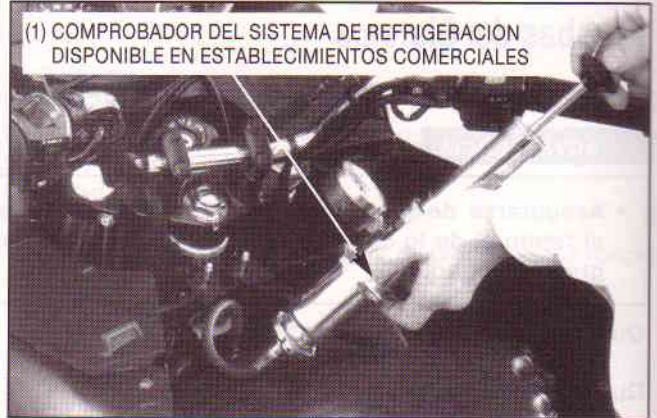
(1) COMPROBADOR DEL SISTEMA DE REFRIGERACION DISPONIBLE EN ESTABLECIMIENTOS COMERCIALES
