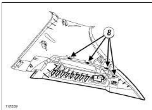
Soltar utilizando un destornillador plano el guarnecido de la bandeja trasera en (8) .
