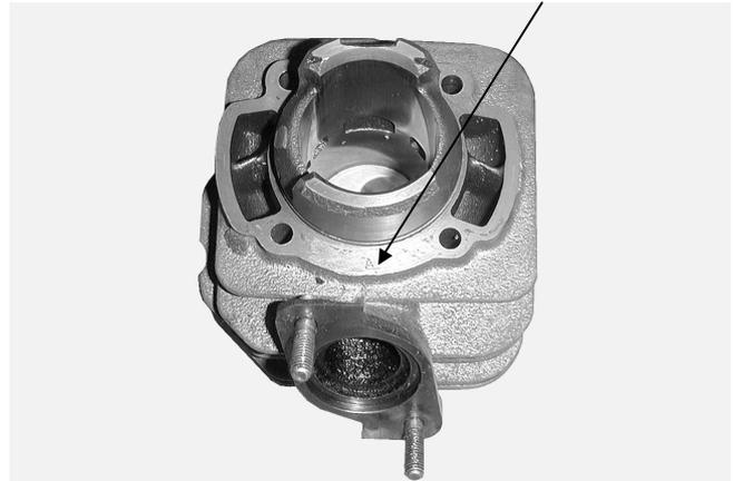
Mida el diámetro exterior del pistón en un punto a 5mm de la parte inferior de la falda.
