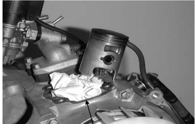
Junta de la base del cilindro
