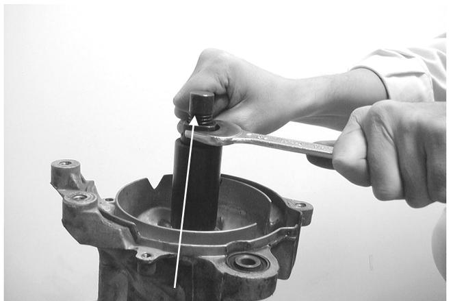
Herramienta ensamblaje cárteres
