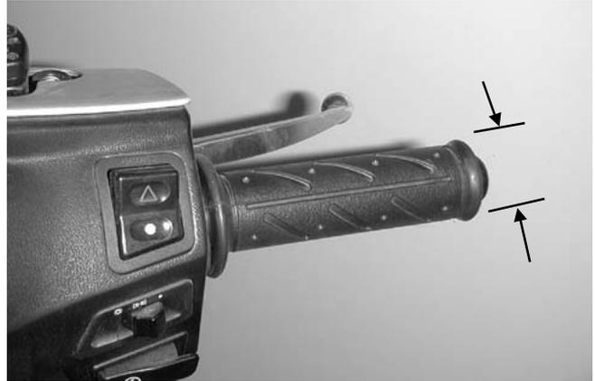
Si la empuñadura del acelerador no tiene este juego, ajústelo aflojando la contratuerca y girando el tensor.
