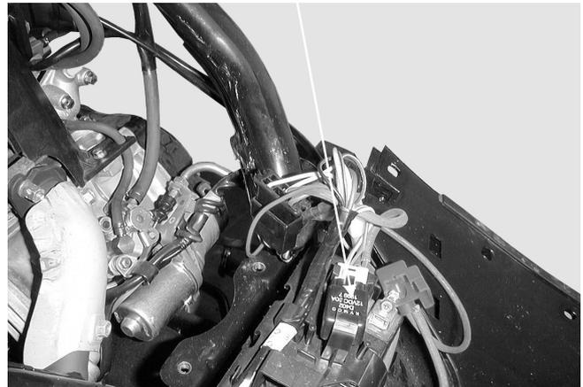
Conecte el terminal verde/amarillo del relé de arranque al borne positivo (+) de la batería de 12V y el terminal amarillo/rojo al borne negativo (-). Compruebe la continuidad entre los terminales rojo/blanco del relé. El relé está bien si hay continuidad.
