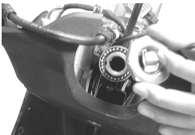
Retire la pista cónica superior y el eje de la dirección.
