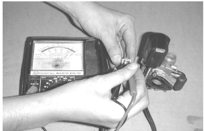
Después de parar el motor 30 minutos, conecte un tubo al circuito de enriquecimiento de gasolina y sople con la boca.
