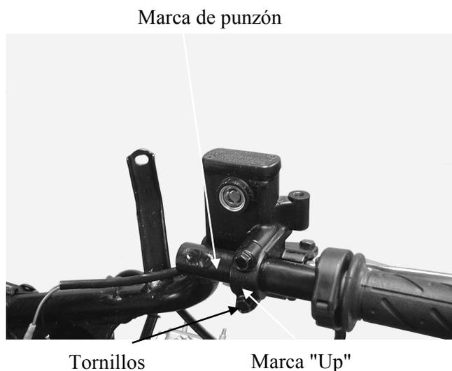
Monte el latiguillo con el tornillo que lo fija y las dos arandelas.
