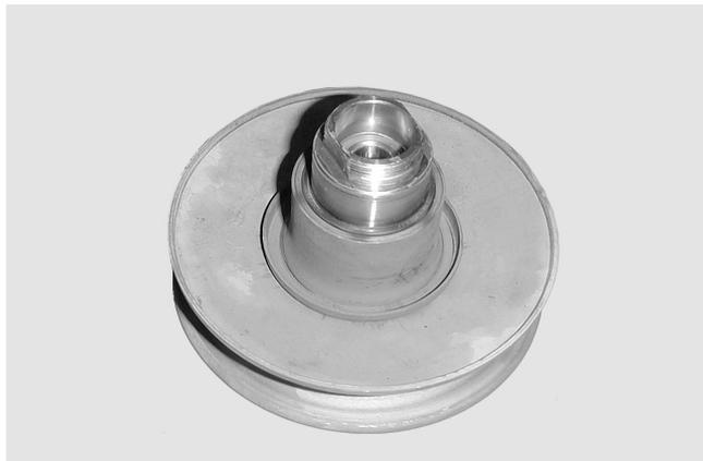
Saque los tetones de los rodillos guía de la polea conducida y luego retire las juntas tóricas y el retén.
