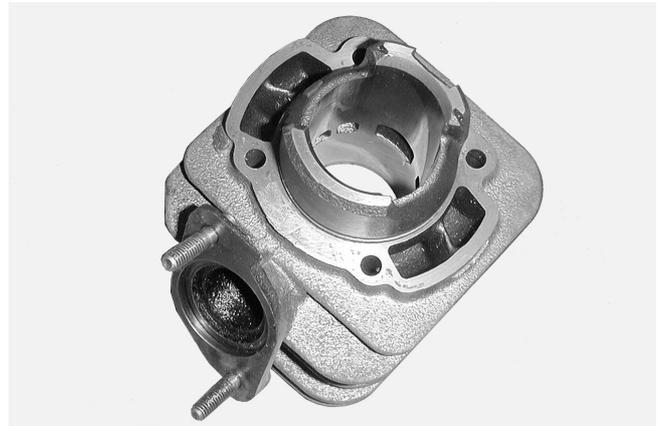
Mida el diámetro del cilindro en los tres niveles A, B y C tanto en la dirección X como en la Y. Evite la ventana de escape. Tome la medida máxima de las seis para determinar el diámetro del cilindro.
