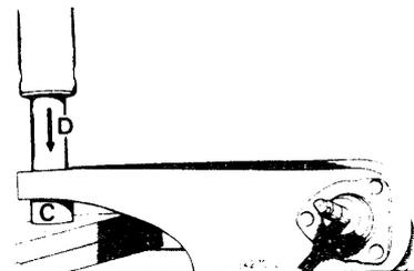
**NOTA.-** Es necesario sustituir los cojinetes elásticos, uno tras otro, para conservar el centrado de éstos respecto del eje del brazo.
