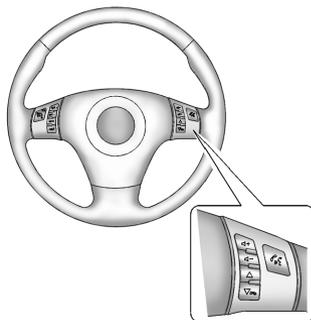
Si está equipado, algunos controles de audio pueden ajustarse usando los controles del lado derecho del volante.
