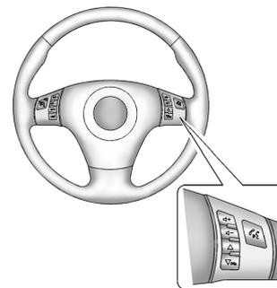
Los vehículos con controles de audio al volante pueden diferir dependiendo de las opciones del vehículo. Algunos controles de audio se pueden ajustar al volante.
