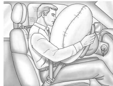
La bolsa de aire frontal del conductor está en medio del volante.
