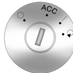
El interruptor de encendido tiene cuatro posiciones diferentes.
