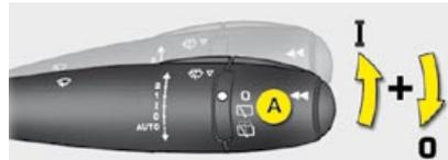
Accionada manualmente por el conductor desplazando la palanca **A** hacia arriba y volviéndola a poner en la posición "**0**".
