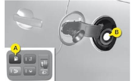
Pulse el mando **A** situado en el tablero de a bordo a la izquierda del puesto de conducción. La trampa se abre automáticamente y por completo.
