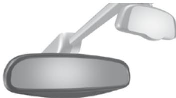
Para evitar el deslumbramiento, el espejo del retrovisor interior se ensombrece automáticamente en función de la intensidad luminosa proveniente de la parte de atrás.
