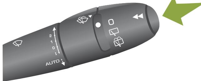
Cada pulsación del botón situado en el extremo del mando del limpiaparabrisas permite mostrar sucesivamente los distintos datos del ordenador de a bordo, en función de la pantalla.
