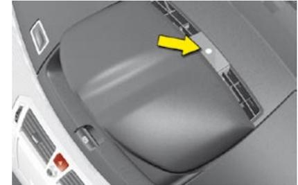
La regulación automática del aire acondicionado, en el interior del habitáculo, utiliza varios sensores (sensor solar, sonda de temperatura exterior...) que le permiten no tener que intervenir a menudo sobre las consignas de reglaje fuera de la temperatura indicada.
