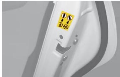
Para bloquear las puertas traseras, bascular la palanca situada en el canto de la puerta (ranura oblicua).
