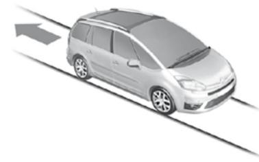
**En bajada, con el vehículo parado y la marcha atrás introducida, el vehículo se mantiene un momento cuando usted suelta el pedal del freno.**
