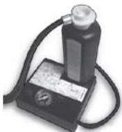
Según el equipamiento, el kit está situado en la cubeta del maletero o en el compartimento situado a los pies del pasajero izquierdo de la segunda fila (la trampilla se abre girando el tornillo un cuarto de vuelta). Este kit es un sistema completo para realizar una reparación provisional. Está compuesto por un compresor y un producto de sellado incorporado.
