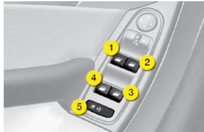
1. Mando de elevalunas eléctrico del conductor.
