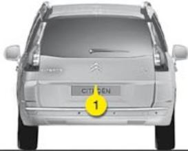
Después del desbloqueo total del vehículo con el telemando o con la llave, con la luneta trasera cerrada, tire de la empuñadura **1** y levante el portón de maletero.
