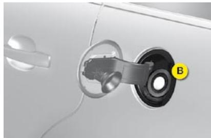
La apertura del tapón puede generar un ruido de aspiración de aire. La estanqueidad del circuito de carburante provoca una depresión, que es completamente normal.
