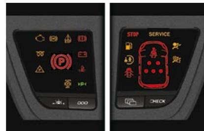
Con el motor en marcha o el vehículo en circulación, el encendido de uno de los testigos siguientes indica la aparición de un defecto que requiere la intervención del conductor.
