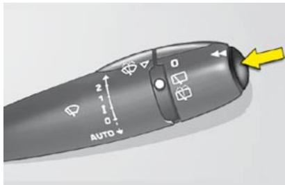
☞ Pulse el botón situado en el extremo del **mando del limpia-parabrisas** para visualizar sucesivamente los diferentes datos del ordenador de a bordo.
