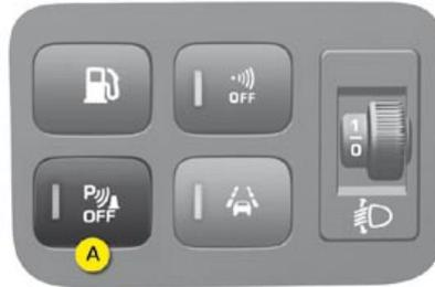
☞ Pulse de nuevo el botón **A**; el testigo se apaga y el sistema se reactiva.
