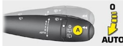
Se activa manualmente por el conductor accionando la palanca **A** hacia la posición "**AUTO**".
