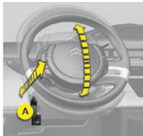
El volante puede regularse en altura y en profundidad.
