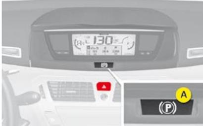
En caso de que falle el sistema de frenos principal o en situaciones excepcionales (ejemplo: mal estar del conductor, conducción acompañada...), tirar de forma continua del mando **A** permite detener el vehículo. El control dinámico de estabilidad (ESP) garantiza la estabilidad durante el frenado dinámico de emergencia.
