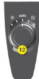
Por defecto, en la posición **AUTO**, el reglaje del caudal de aire está ajustado en la ventilación delantera.
