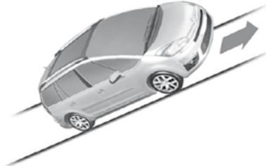
**En subida, con el vehículo parado, éste se mantiene un momento cuando usted suelta el pedal del freno:**
