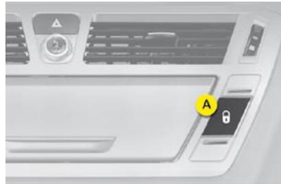
La pulsación del mando **A** permite accionar el cierre y la apertura centralizados eléctricos.
