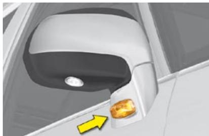
Para cambiar el repetidor, apriete con firmeza hacia abajo, en la zona indicada por la flecha y tire del repetidor.
