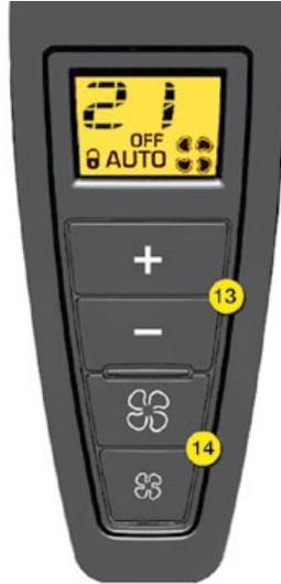
El aire acondicionado adicional permite optimizar el confort térmico en condiciones estivales. Produce aire frío suplementario y lo distribuye a través de los aireadores traseros. Con este sistema no es posible la distribución de aire caliente por los aireadores traseros.
