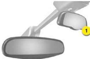
Realiza automáticamente y de manera progresiva el cambio entre los modos día y noche.
