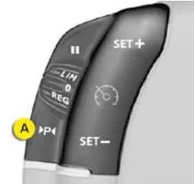
Puede seleccionar la función de medida de plaza disponible pulsando el mando **A**. El encendido fijo del testigo indica la selección de la función.
