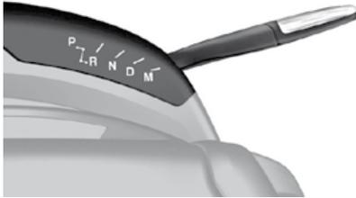
Posición de la palanca para cambiar de marcha manualmente.
