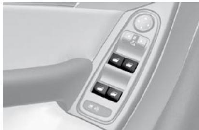
Desde el puesto del conductor, los mandos situados en la puerta permiten accionar los elevelunas eléctricos del vehículo.
