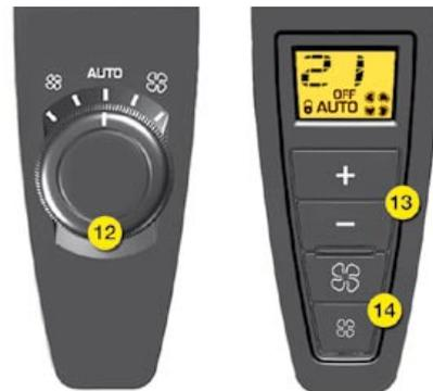
12. Regulación de la velocidad del impulsor de aire.
