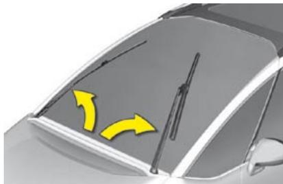
En el minuto siguiente a cortar el contacto, cualquier acción en el mando del limpiaparabrisas posiciona las escobillas en el centro del parabrisas.
