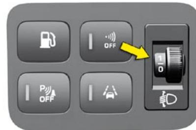
Para no molestar a los demás conductores, los faros con lámparas halógenas deben regularse en altura, en función de la carga del vehículo. Para ello, gire el mando, situado bajo el tablero de a bordo a la izquierda del conductor, en la posición adecuada:
