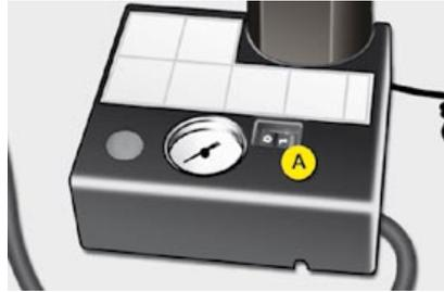
Si al cabo de aproximadamente tres minutos no ha alcanzado dicha presión, significa que el neumático no se puede reparar; consulte con la red CITROËN para el remolcado del vehículo.
