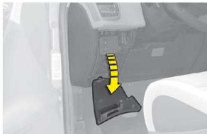
**Después de realizar cualquier intervención en los fusibles, verifique que la tapa de la caja está correctamente colocada para garantizar la estanqueidad.**
