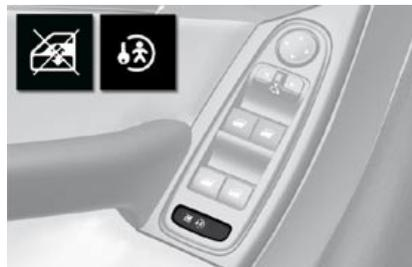
La manipulación de los elevallunas eléctricos y la apertura de las puertas traseras pueden neutralizarse pulsando el mando correspondiente.
