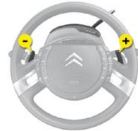
Accionar las manetas "+" o "-" le permite temporalmente cambiar de marcha de forma manual. La petición de cambio de marcha se toma en cuenta, aunque se conserva el modo automático. El testigo **D** permanece encendido en el cuadro de a bordo.
