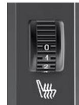
Con el motor en funcionamiento, los asientos delanteros pueden calentarse por separado.
