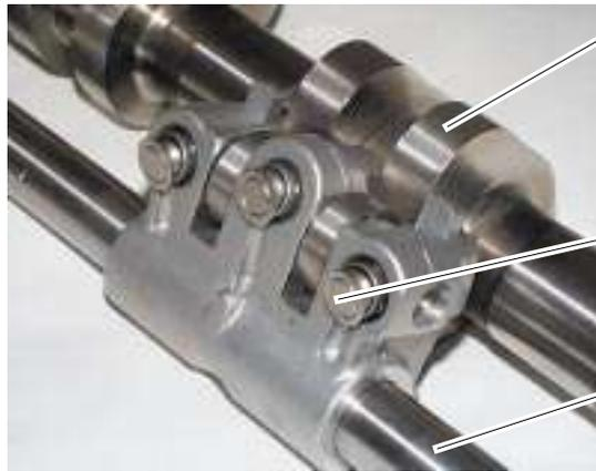
Balancín de triple brazo oscilante con rodillos
