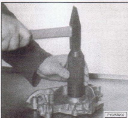
Las operaciones de desmontaje y montaje se efectúan con un botador normal.
