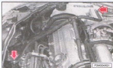
Aflojar las abrazaderas y desconectar los tubos del radiador y del depósito de expansión.
