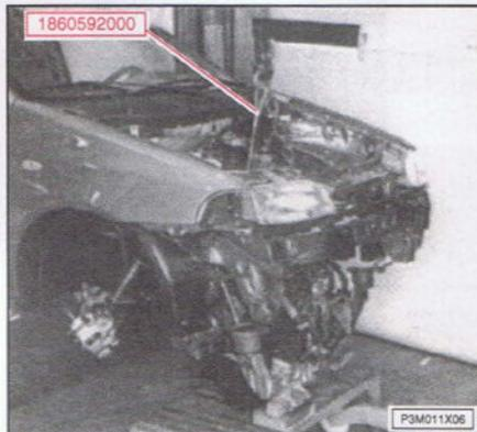
Sacar el grupo motopropulsor del compartimento del motor, maniobrando la jirafa de forma adecuada, y colocarlo en la tarima.
