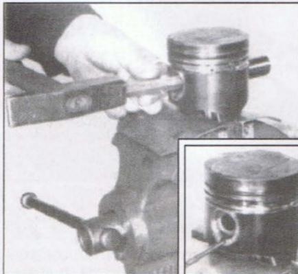
Retirar los segmentos con el útil 1860183000. Retirar el anillo de retención del bulón y con ayuda de un botador sacar el bulón de su empujamiento.
