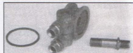
Sección del soporte del filtro de aceite y de la válvula termostática
