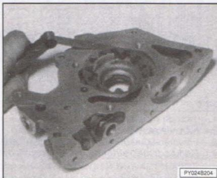
La válvula termostática tiene la siguiente función:
