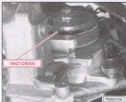
Montar el útil 1842128000 sobre la polea de mando de la bomba de inyección. Bloquear la rotación de la polea con el tornillo específico indicado en la figura.
