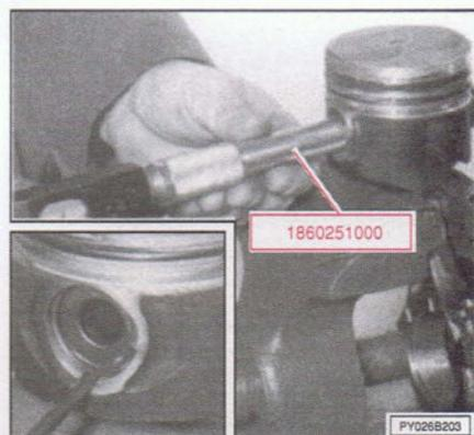
Retirar el anillo de retención del bulón del pistón y sacar el bulón con el útil 1860251000.
