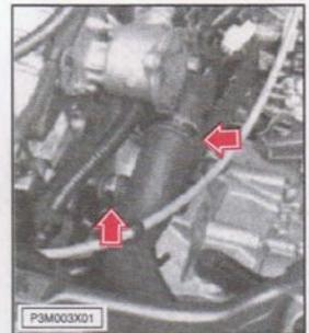
Aflojar las abrazaderas y separar los tubos de conexión del termostato al radiador y de la bomba al calefactor.
