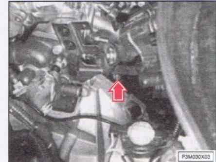
Aflojar el tornillo indicado en la figura y quitar el tubo de retorno de la bomba de líquido refrigerante.
