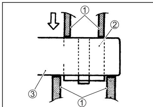
**INSTALACIÓN DE CASQUILLOS DE MONTAJE DEL MOTOR**
