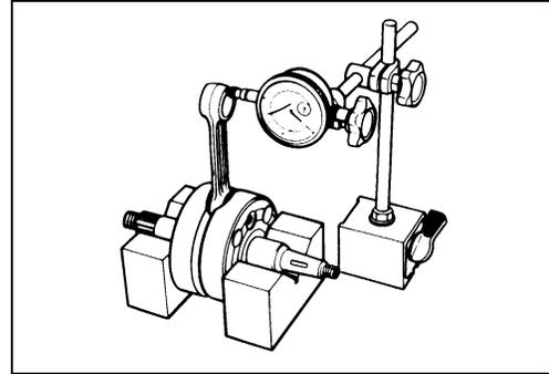
**INSPECCIÓN DEL DESCENTRAMIENTO DEL CIGÜEÑAL**
