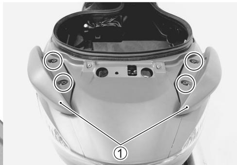
**CUBIERTA INFERIOR DEL BASTIDOR****EXTRACCIÓN**
