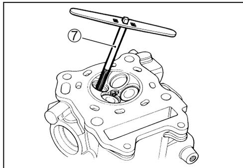
**INSPECCIÓN DE ANCHURA DE ASIENTOS DE VÁLVULAS**
