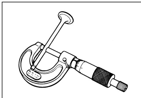
**MANTENIMIENTO DE GUÍAS DE VÁLVULAS**
