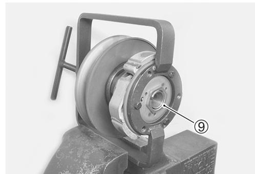
**Tuerca de la zapata de embrague: 80 N·m (8,0 kgf-m)****EMBRAGUE DEL ARRANQUE
