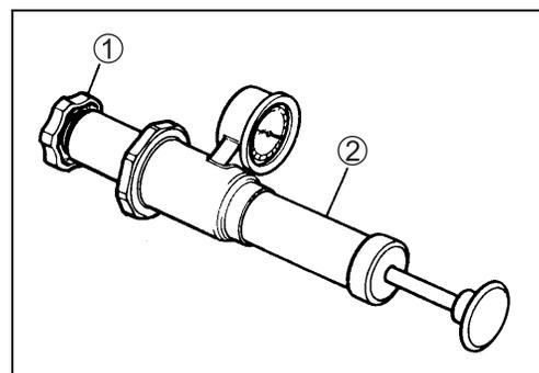
**DATA** Presión de liberación de la válvula del tapón del radiador: 98,2 – 122,7 kPa (1,00 – 1,25 kgf/cm<sup>2</sup>)
