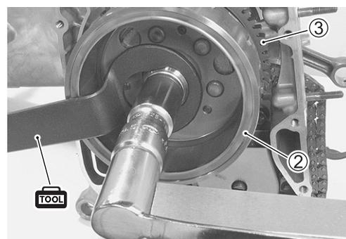
**Tuerca del rotor del generador: 95 N·m (9,5 kgf-m)**
