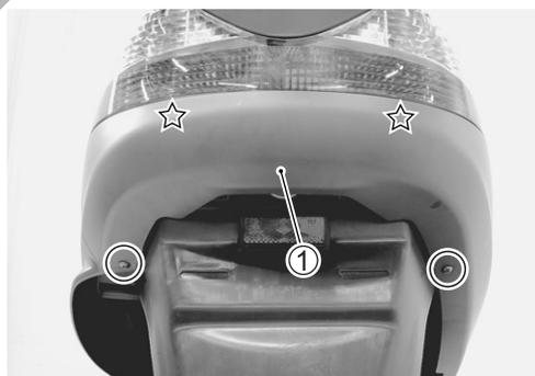
**CUBIERTA DEL BASTIDOR****EXTRACCIÓN**
