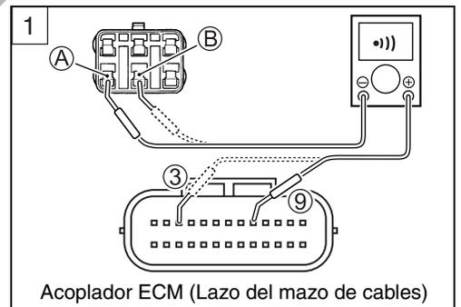
**DATA Continuidad del cable del sensor de TO:****Continuidad (•••)**
