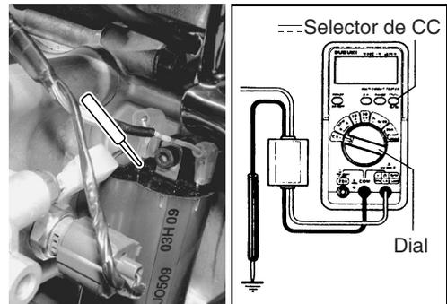
Si la tensión de pico es inferior a los valores especificados, inspeccione la bobina de encendido. (☞ 9-25)
