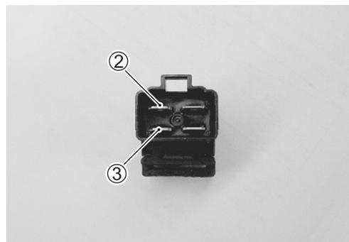
Compruebe que haya continuidad entre los terminales ② y ③ cuando se aplique tensión de batería de 12 V; positivo al terminal ④ y negativo al terminal ⑤. Si no se nota continuidad, el relé deberá ser reemplazado.
