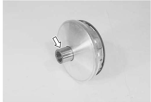
**REVISIÓN DE LA SEMIPOLEA CONDUCTORA MÓVIL**
