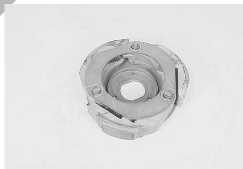
Mida el grosor de la zapata del embrague en su punto medio. Si el grosor es menor que el límite de funcionamiento, cambie el conjunto zapata del embrague por uno nuevo.
