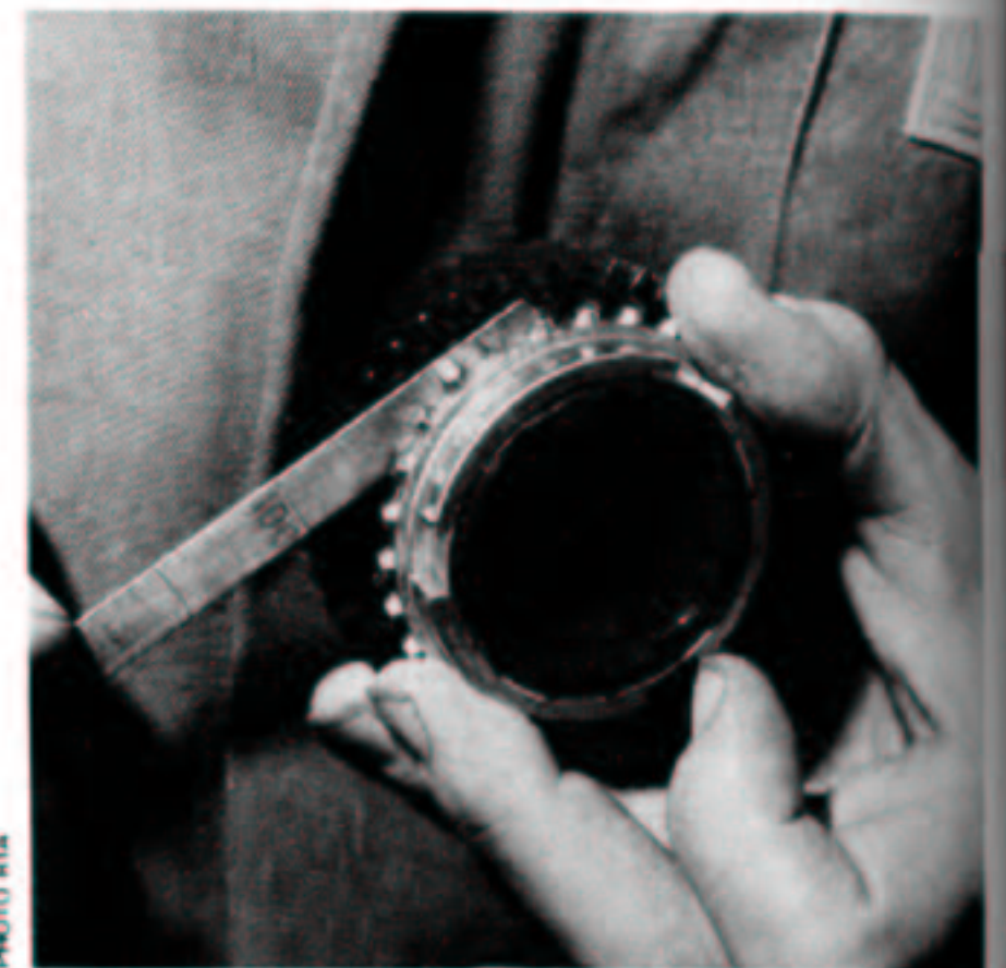
Mesure du jeu d'une bague de synchroniseur.
