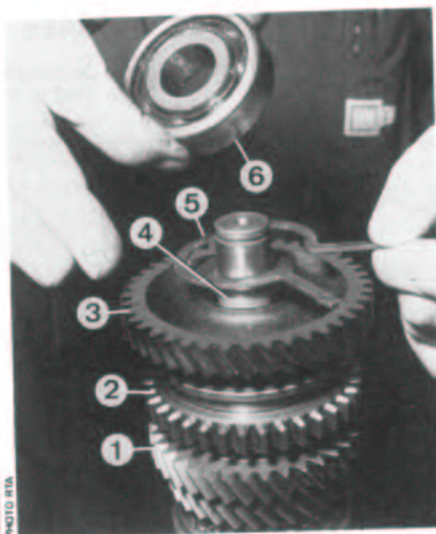
Remontage de l'arbre secondaire (partie courte).
