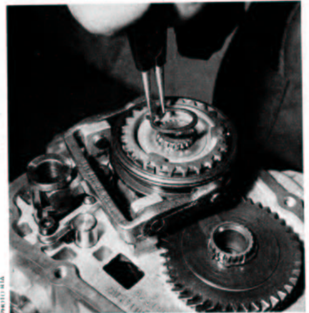
Mise en place du clip d'arrêt du synchroniseur de 5 e .
