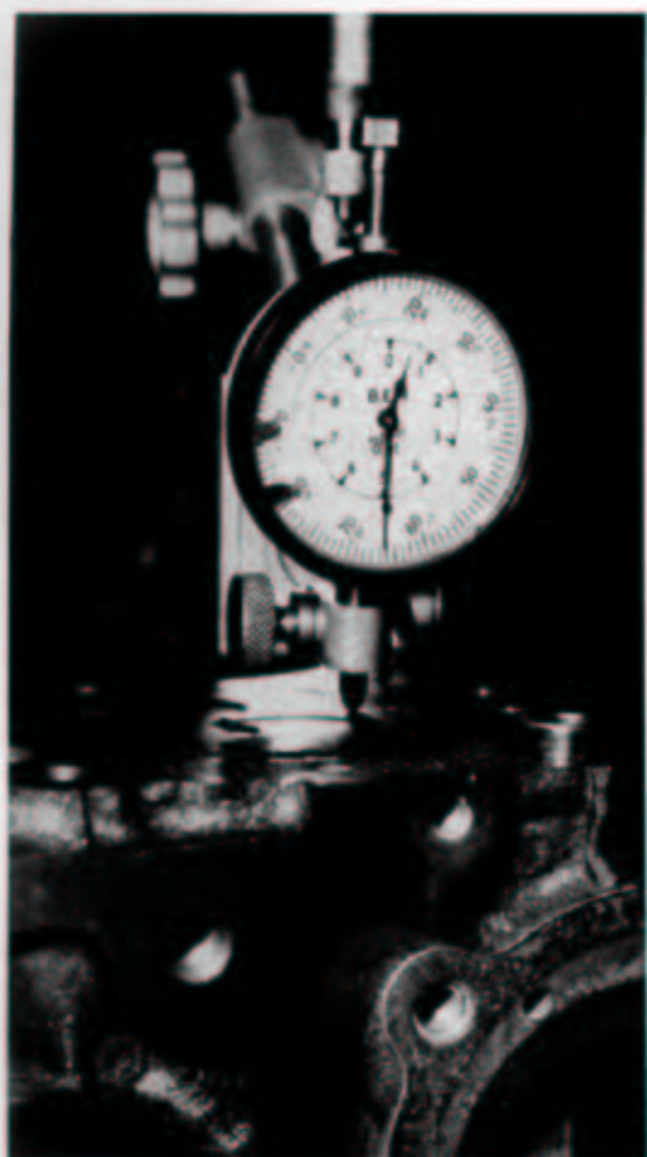
Mesure du dépassement des pistons pour le choix du joint de culasse.
