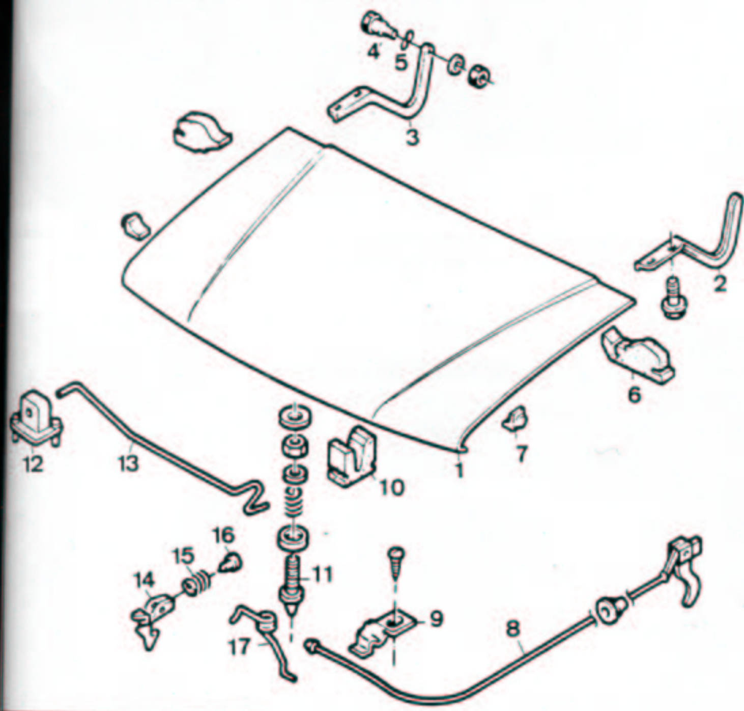
A l'aide d'une clef plate et d'un gros tournevis, régler les jeux d'ouverture en hauteur du capot moteur.
