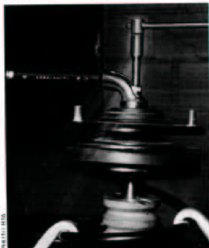
Desserrage de l'écrou de tige d'amortisseur.
