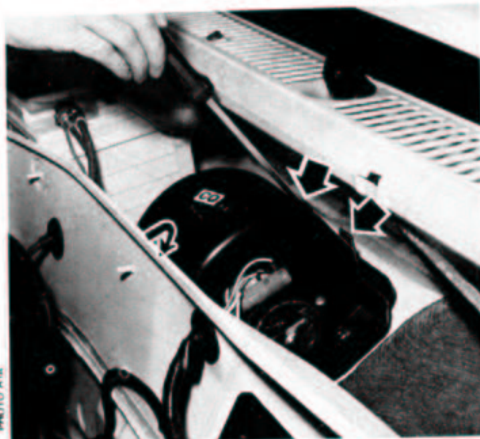
Dépose du couvercle de boîtier de soufflerie.
