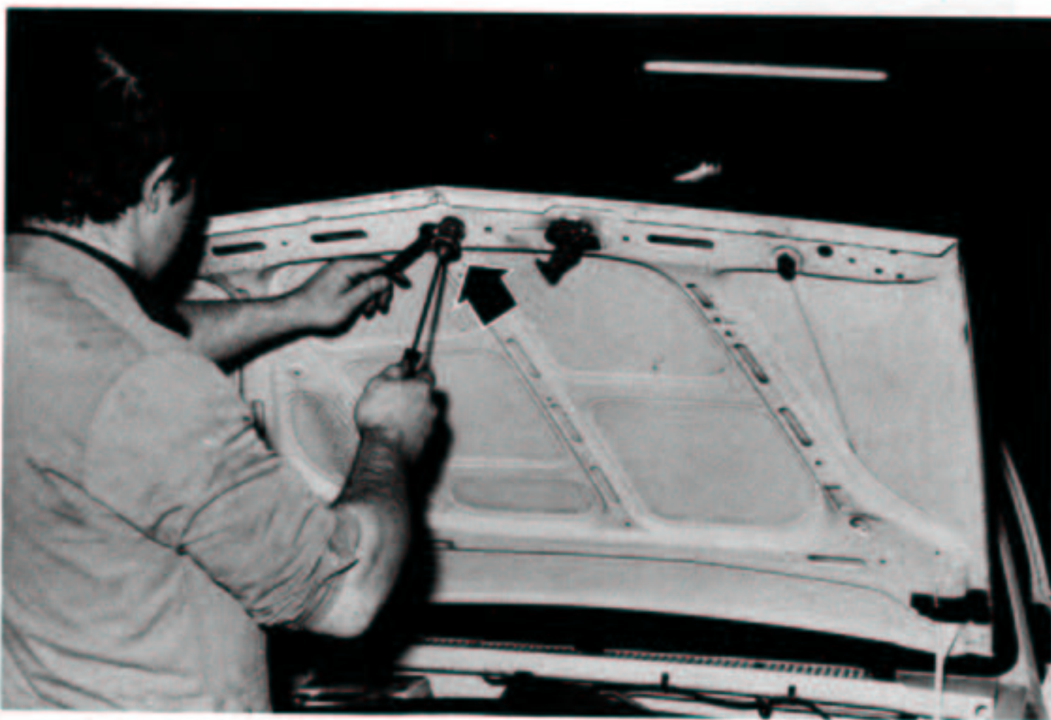
A l'aide d'une clef plate et d'un gros tournevis, régler les jeux d'ouverture en hauteur du capot moteur.
