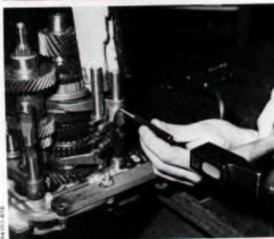
Dépose des goupilles de fourchettes.
