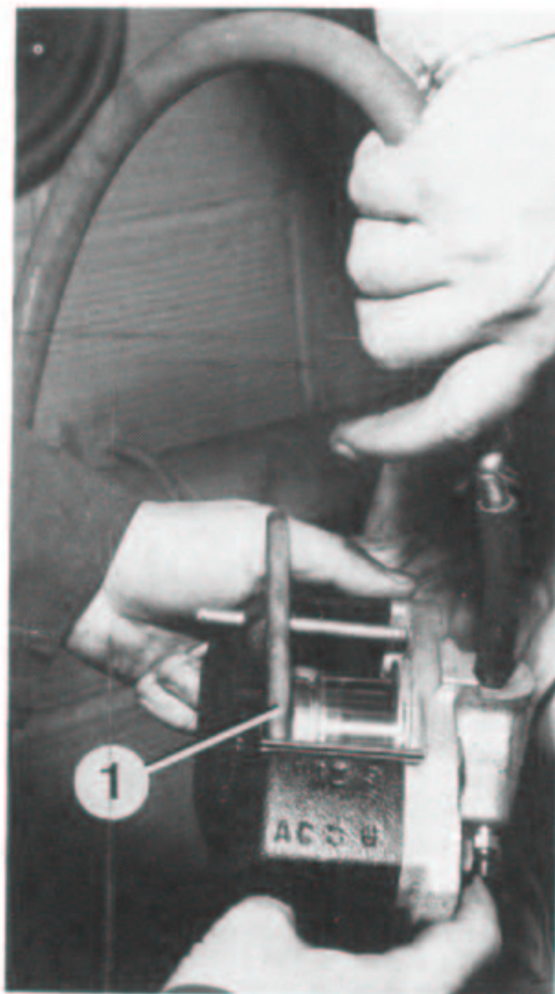
Extraction du piston à l'aide de l'air comprimé. 1. Cale en bois.
