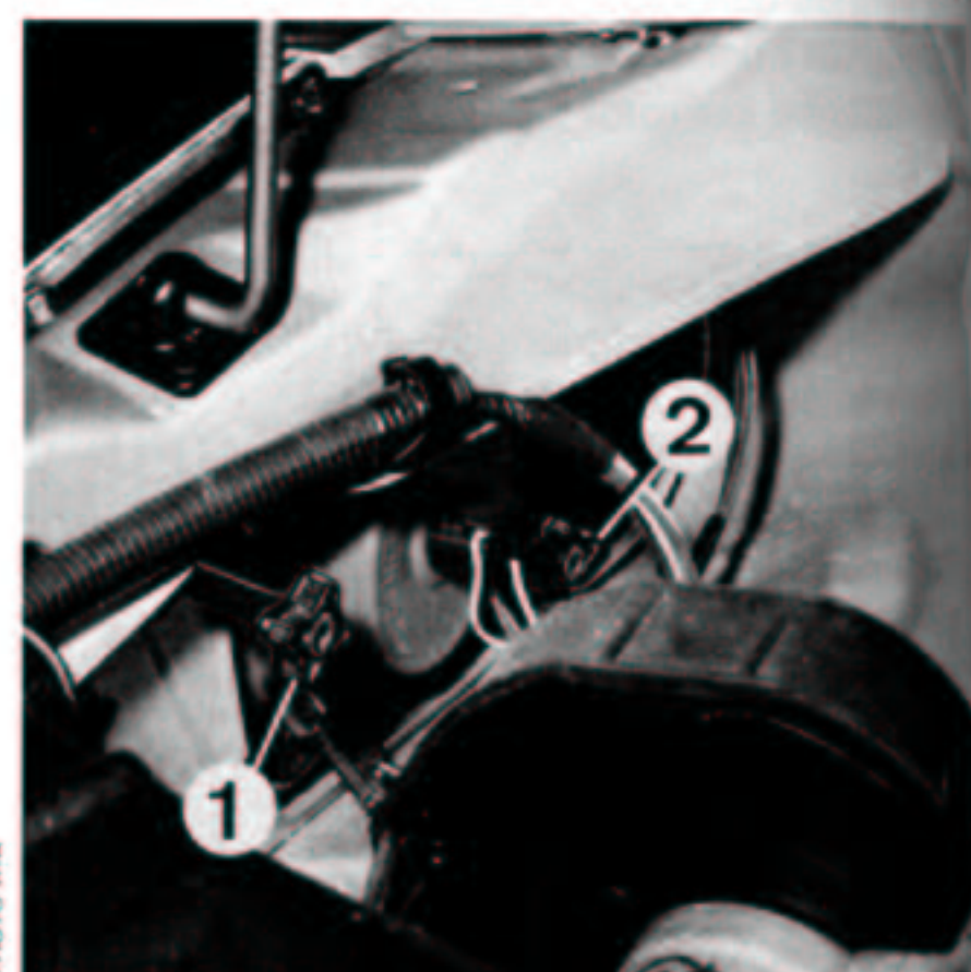
Réglage des projecteurs 1. Vis de hauteur - 2. Vis de direction.
