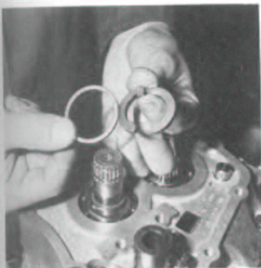
Rondelle de maintien et demi-lune de butée sur l'arbre secondaire.
