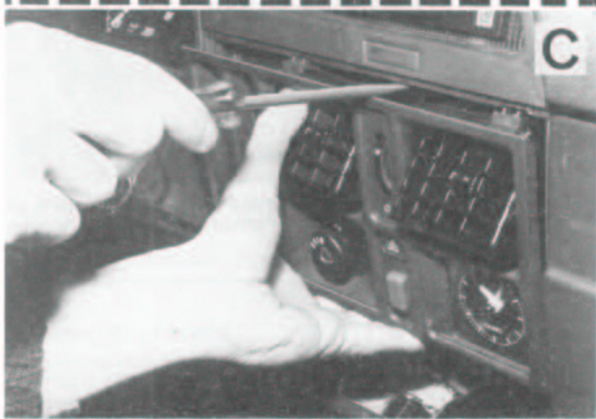
Dépose du cache de console et des commandes de chauffage.
