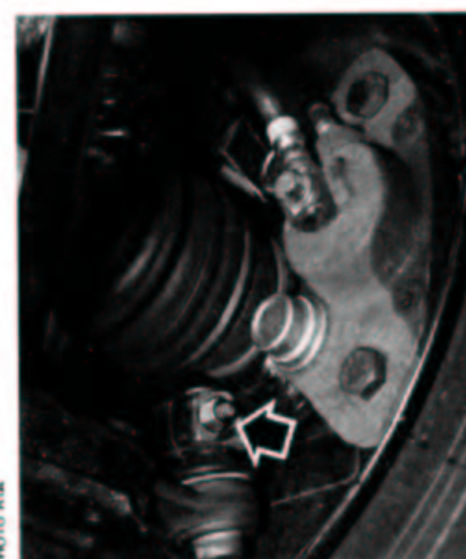
Vis clavette de fixation de la rotule inférieure sur le pivot.
