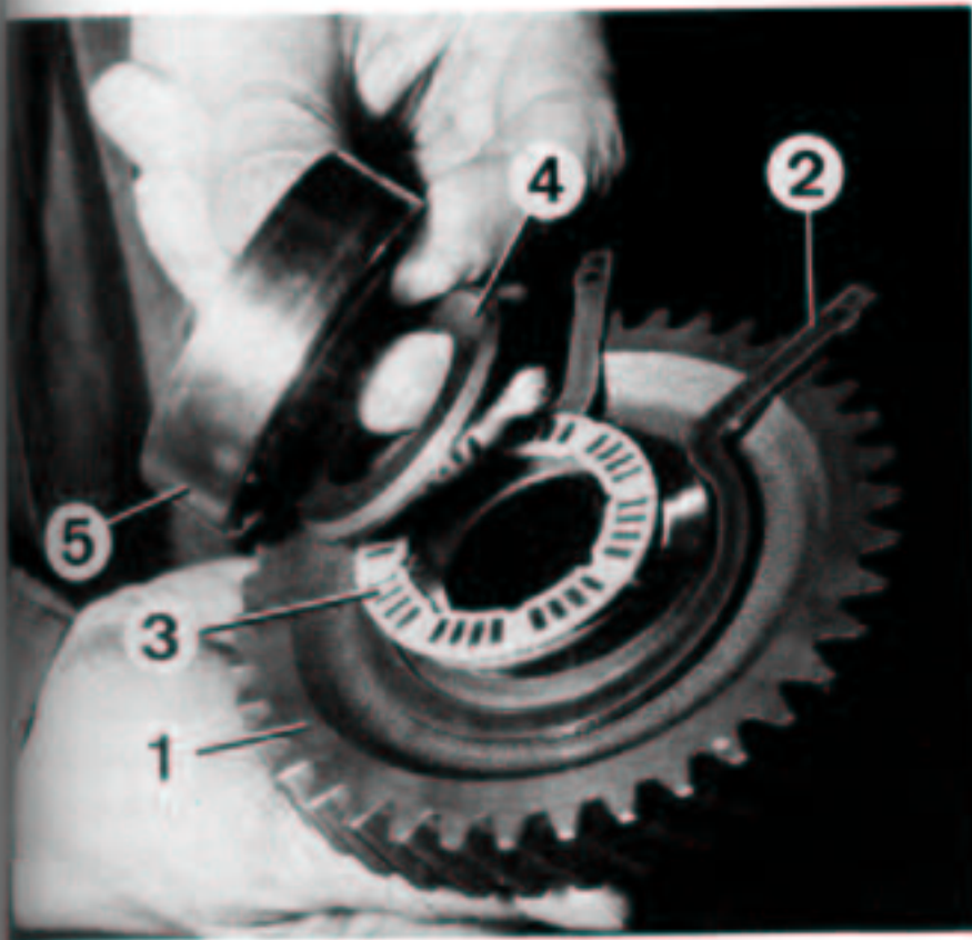
Repose du pignon de 1 er Pignon fou de 1 er - 2. Clip d'arrêt - 3. Butée à rouleaux 4. Rondelle d'appui - 5. Roulement - Noter l'orientation du chanfrein de la rondelle d'appui vers le roulement à billes.
