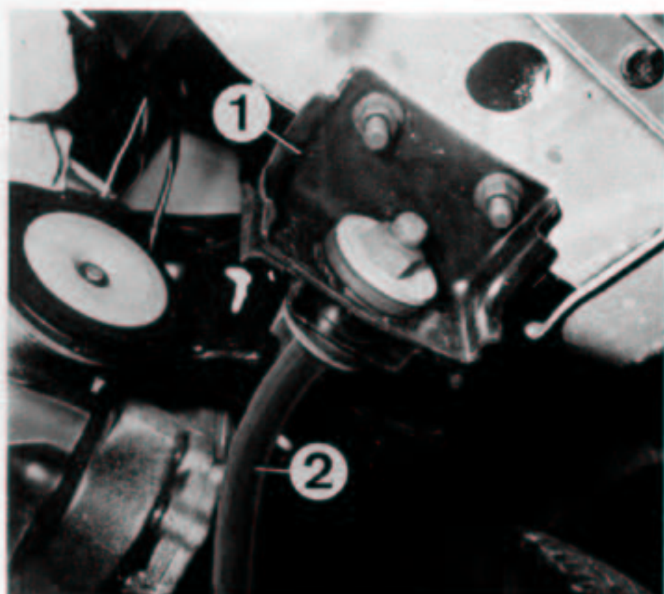
Fixation du tirant de chasse sur la caisse 1. Support - 2. Tirant.
