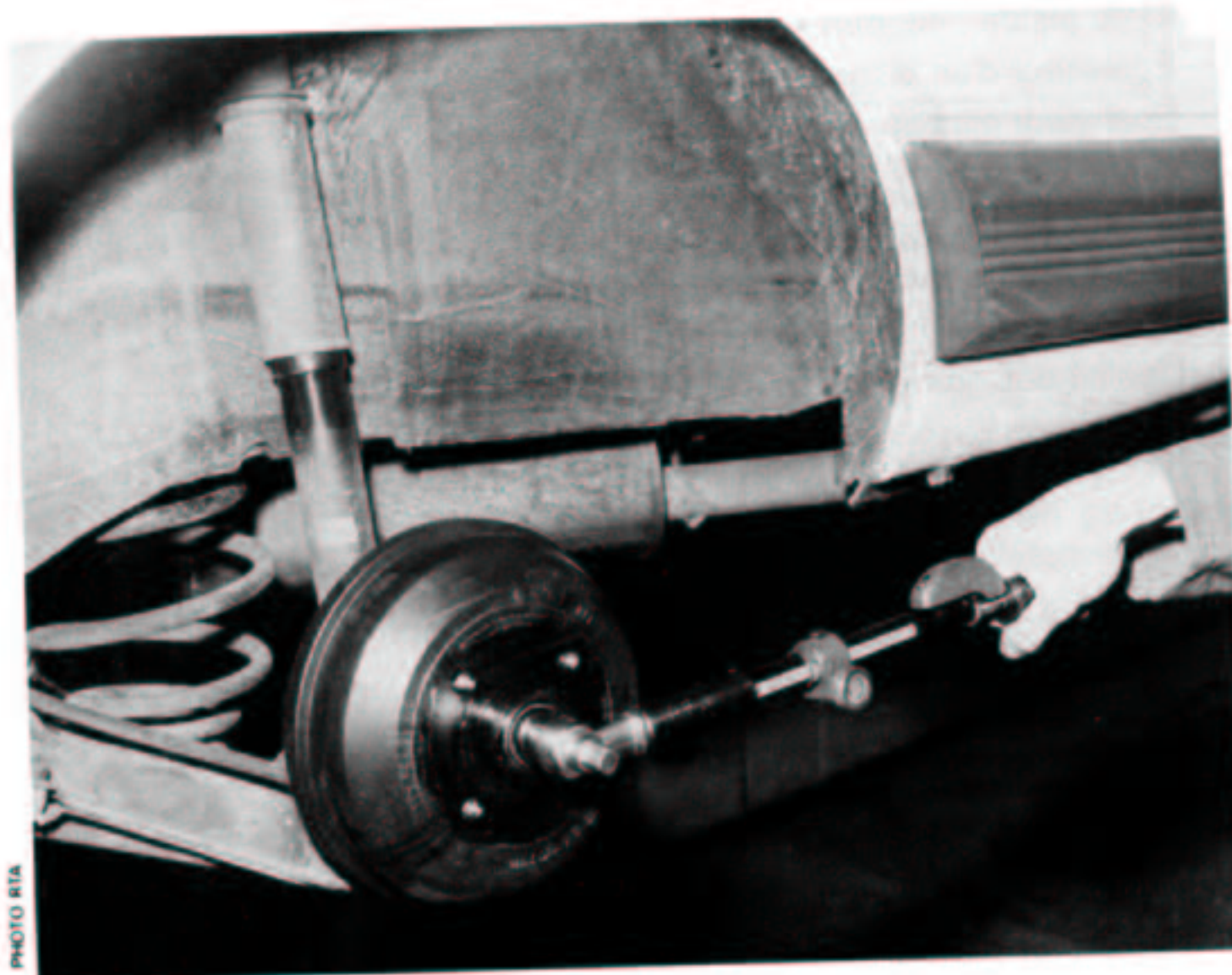
Réglage du roulement de moyeux arrière.
