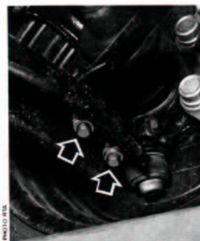
Boulons de fixation du tirant de chasse et de la rotule intérieure sur le bras.
