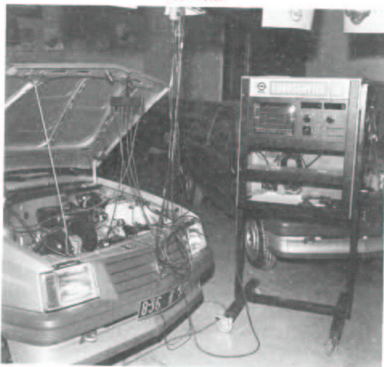
Contrôle de l'allumage à l'aide d'un banc de contrôle.
