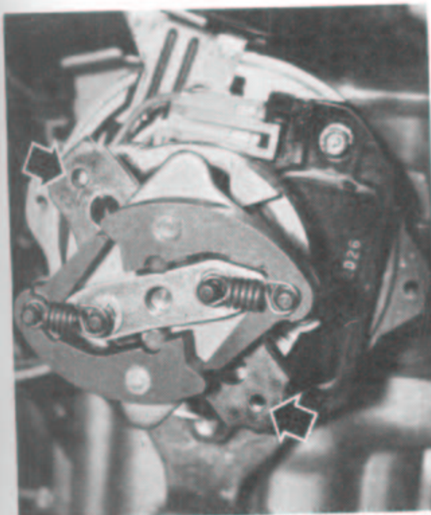
Le système d'avance centrifuge est situé sous le doigt. Flèches : emplacement des vis de fixation du doigt.
