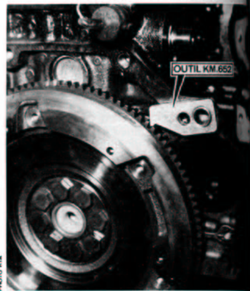
Blocage du volant moteur à l'aide de l'outil spécial.
