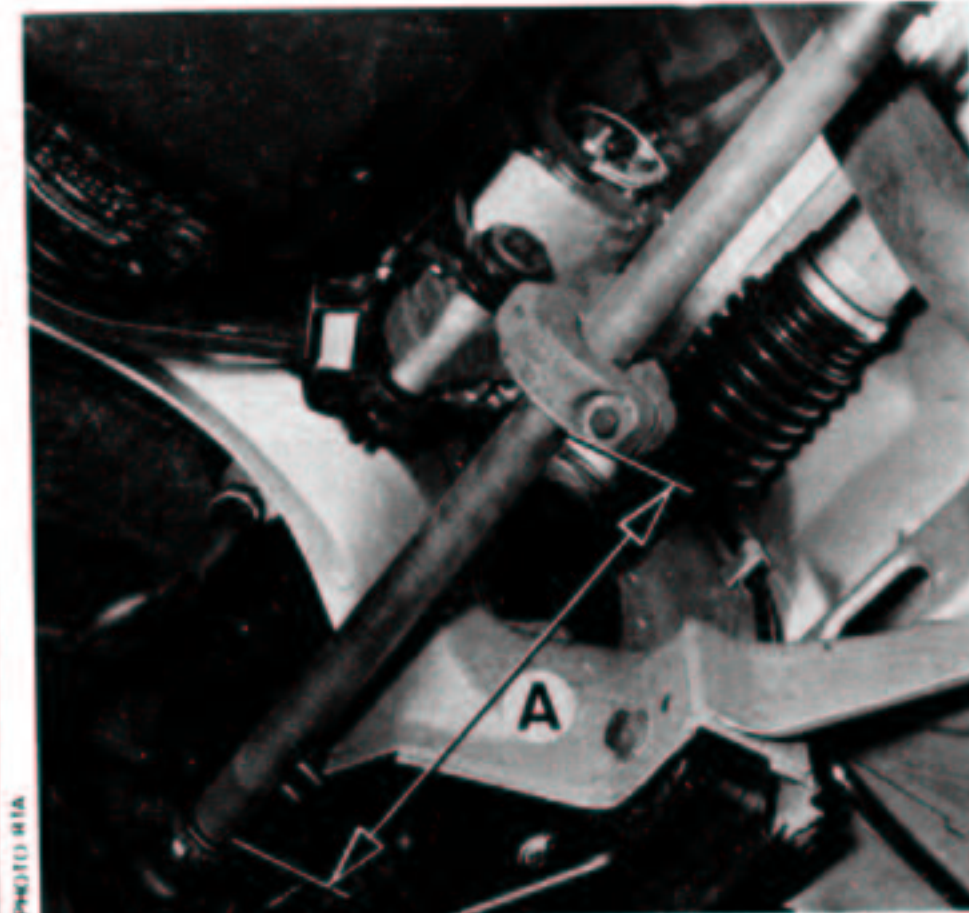
Position de la masse d'équilibrage sur l'arbre droit A. 130 mm.
