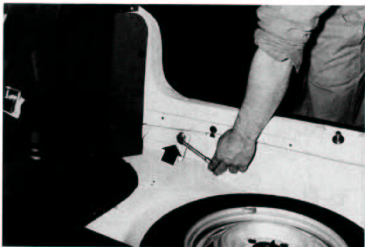
Ouvrir le hayon arrière pour accéder aux fixations du bouclier.
