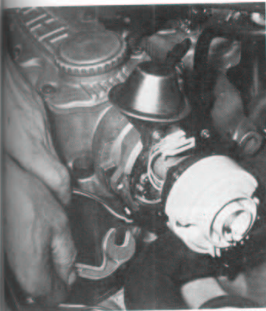
Desserrage de l'écrou de fixation de l'allumeur à l'aide d'une clé coudée (tête déposée).
