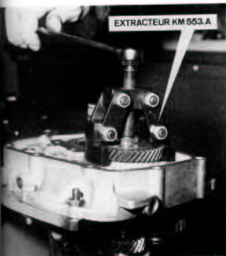
Dépose du pignon de 5 e de l'arbre primaire.
