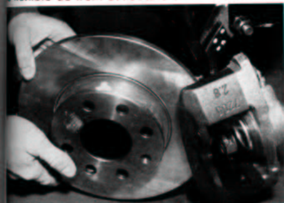
Dépose d'un disque de frein étrier en place.
