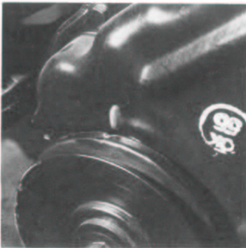
Repères de calage de l'allumeur : repère sur poulie face au bombé sur carter de distribution.
