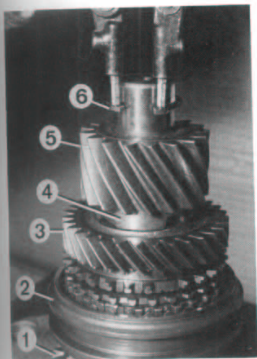
Remontage de l'arbre secondaire (partie longue).
