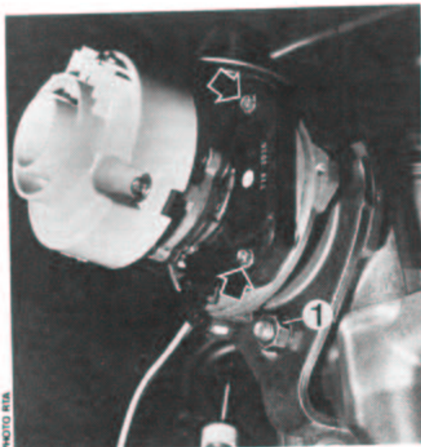
1. Ecrou de fixation de l'allumeur. Flèches : vis de fixation du module.
