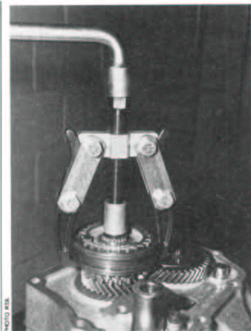
Dépose du synchroniseur de 5 e avec l'extracteur KM 161 A et les crochets KM 161-2.
