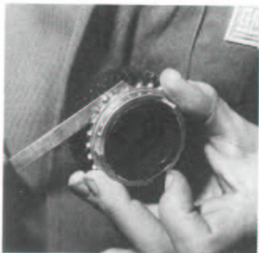
Contrôle du jeu d'une bague de synchronisation.
