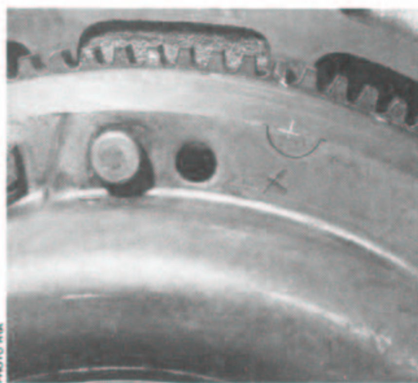
Repérage volant moteur-encoche sur mécanisme.
