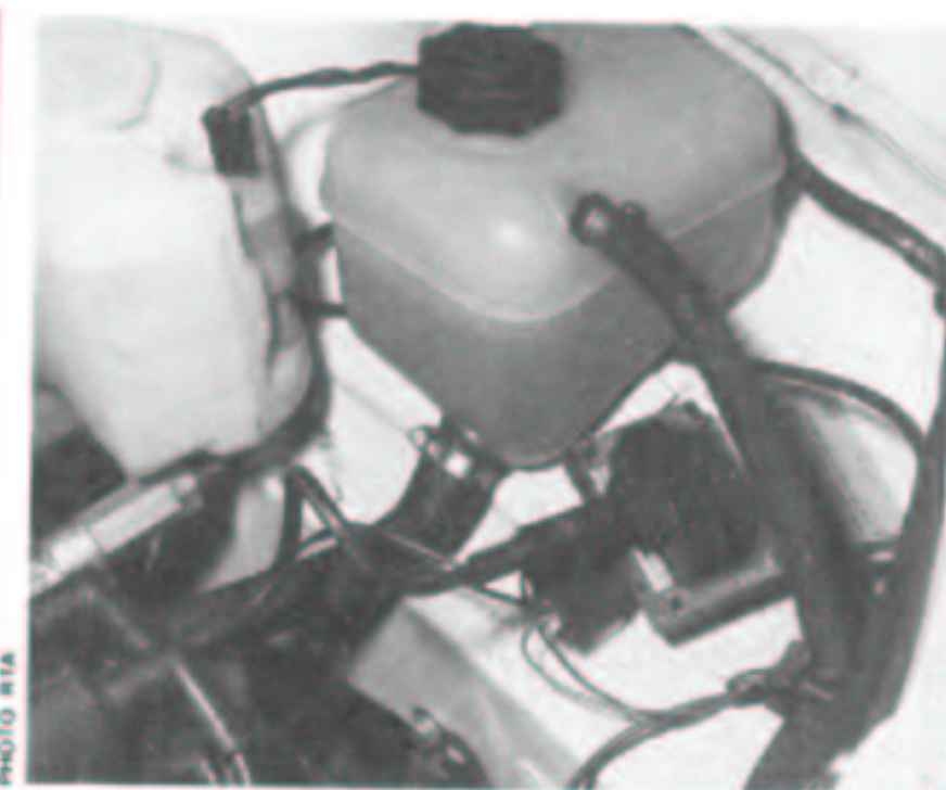
Emplacement de la bobine sur doublure d'aile avant gauche.
