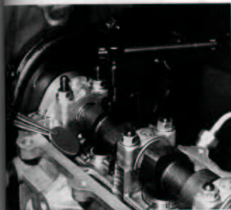
Compression d'un pous- soir à l'aide de l'outil KM-650 et extraction d'une pastille.
