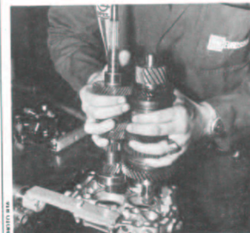
Dépose des arbres primaire et secondaire du support palier.
