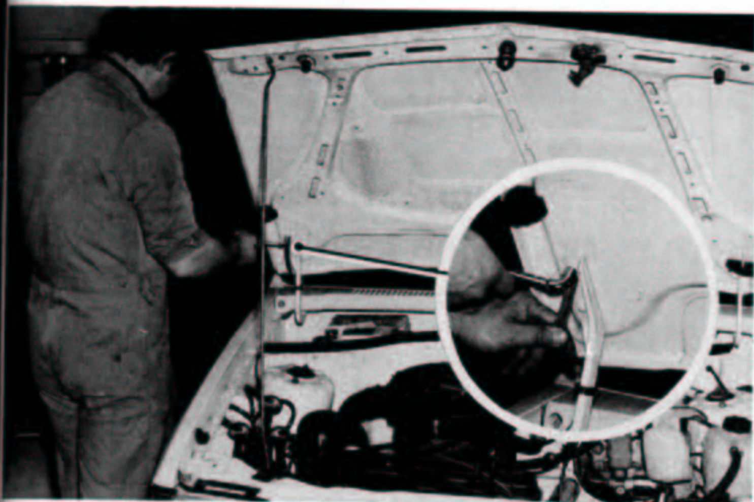
Placer les 2 fixations des compas de capot et régler les jeux d'ouverture.
