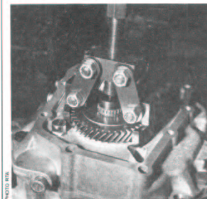
Dépose du pignon de 5 e sur l'arbre primaire avec l'extracteur KM 553.
