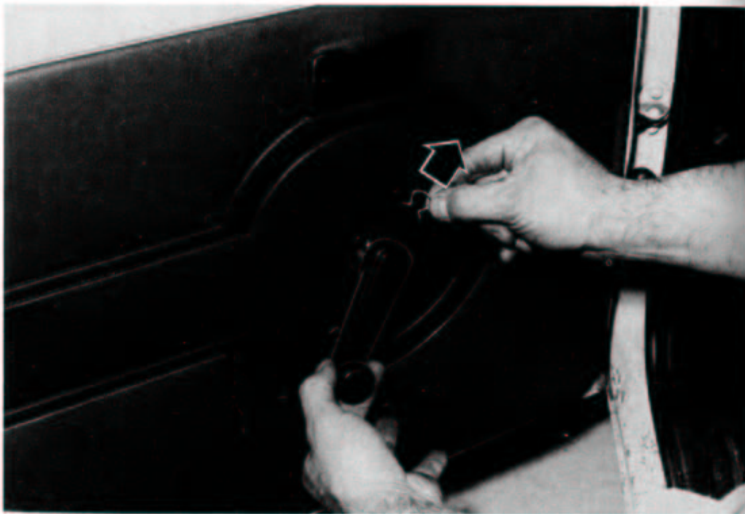
A l'aide d'un petit crochet réalisé dans un fil d'acier dégager le clip de maintien de la poignée d'ouverture de glace.
