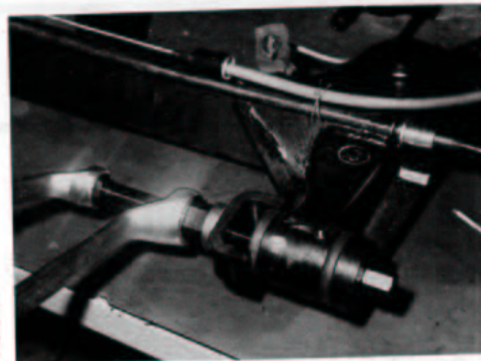
Repose d'un silentbloc de bras arrière (outillage KM 548-3 et 548-4).
