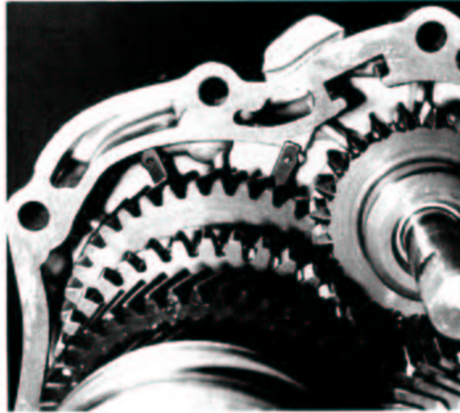
Positionnement du clip d'arrêt de l'arbre secondaire.
