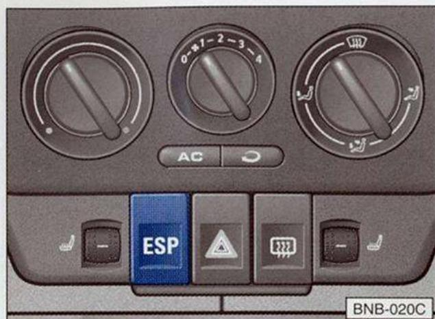
Los vehículos dotados del sistema antibloqueo de frenos (ABS)\* pueden ir equipados adicionalmente con un programa electrónico de estabilidad\* (ESP) y una regulación del resbalamiento de la tracción\* (ASR).
