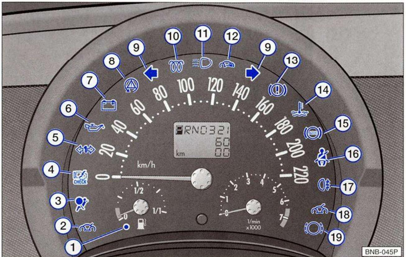
La disposición de los testigos luminosos depende de la versión del modelo y del motor. Los símbolos de los testigos luminosos se verán únicamente cuando se enciendan estos últimos.
