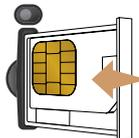
Instale la tarjeta SIM en el soporte e insértela a continuación en la trampa.
