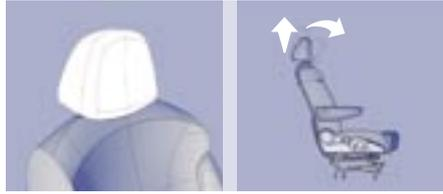
**5 - Reglaje en altura y en inclinación de los reposacabezas (manual)**
