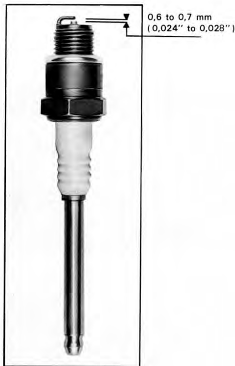
Fig. 48 - Electrode gap
