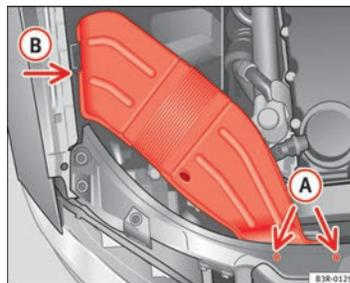
Fig. 193 Conducción de ventilación en el lado derecho del vehículo
