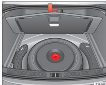
Fig. 183 Rueda de repuesto con llanta de acero
