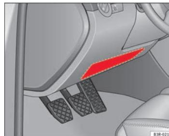
Fig. 21 Airbag de rodilla del conductor
