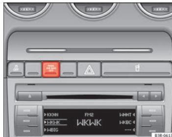
Fig. 28 Testigo de control de la desactivación del airbag del acompañante
