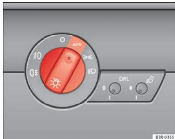
Fig. 85 Detalle del tablero de instrumentos: Conmutador de las luces
