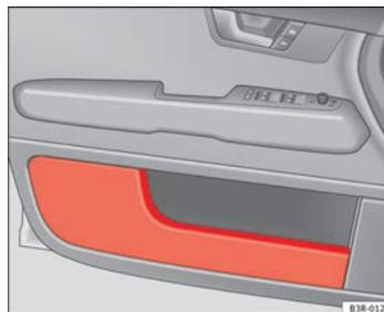
Fig. 128 Revestimiento de la puerta con portaobjetos
