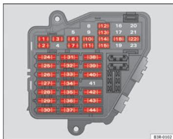
Fig. 191 Ilustración básica del portafusibles en la cubierta delantera izquierda del tablero de instrumentos: Fusibles (sin la tapa de los fusibles)
