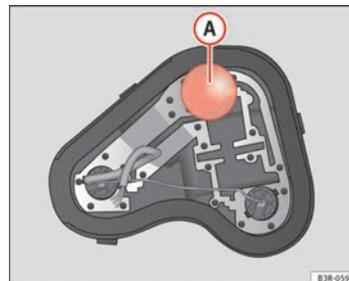
Fig. 215 Ubicación de la lámpara de incandescencia en el portalámparas. Ejemplo: Piloto posterior izquierdo en la aleta.
