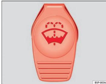
Fig. 174 Tapón del depósito del lavacristales en el vano motor.
