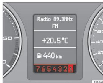
Fig. 152 Pantalla: Cambiar las marchas manualmente (modo tiptronic) ▶
