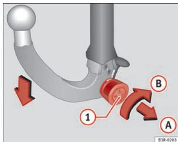
Fig. 164 Dispositivo desmontable para remolque: Desmontar la rótula
