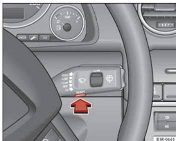
Fig. 61 Palanca del limpiaparabrisas: Tecla de manejo para seleccionar menús
