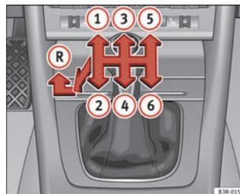
Fig. 147 Detalle de la consola central: esquema de un cambio manual de 6 marchas
