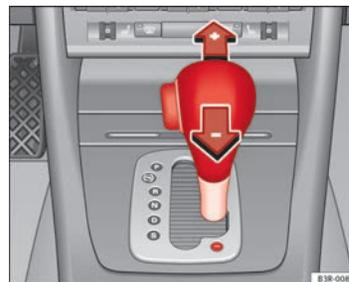
Fig. 151 Consola central: Cambiar las marchas manualmente (modo tiptronic)
