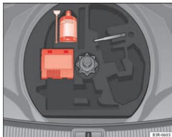
Fig. 182 Juego para reparación de neumáticos (tire mobility system) debajo de la superficie de carga del maletero
