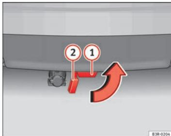
Fig. 165 Parachoques trasero: colocar el tapón
