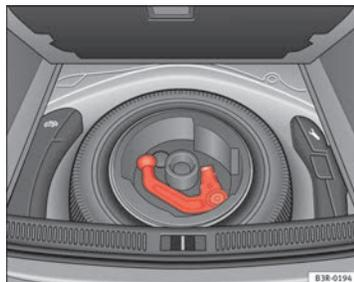
**Fig. 156** Maletero: Rueda de repuesto con dispositivo para remolque
