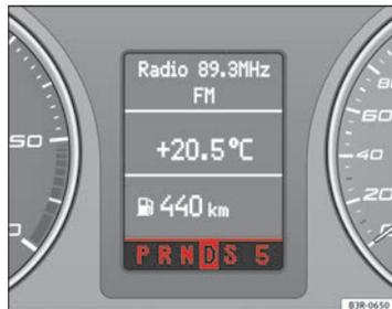
Fig. 149 Pantalla: Posiciones de la palanca selectora
