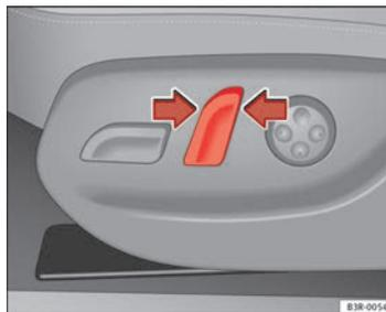
Fig. 108 Asiento delantero: Mando para la inclinación del respaldo
