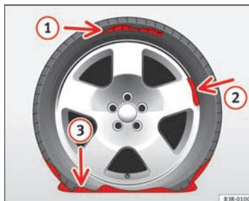
Fig. 188 Pinchazos para los que no se adecua el sistema tire mobility system
