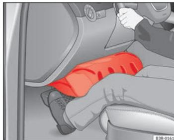
**Fig. 22** Los airbags hinchados protegen en una colisión frontal
