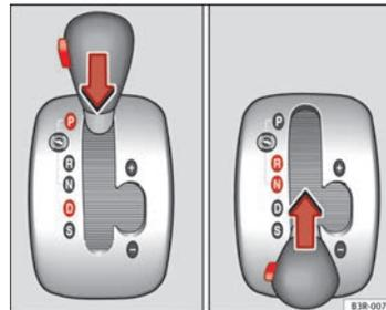
Fig. 150 Bloqueo de la palanca selectora
