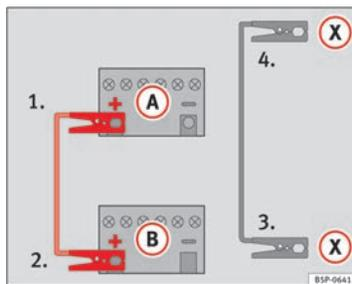
Fig. 232 Esquema para conectar los cables de emergencia en el caso de que el vehículo que suministra la corriente disponga del sistema Start-Stop: batería descargada (A) y batería que suministra la corriente (B).
