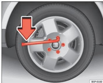
Fig. 184 Cambio de rueda: Aflojar los tornillos de la rueda
