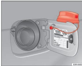
Fig. 168 Tapa del depósito con el tapón encajado
