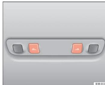
Fig. 95 Detalle del revestimiento del techo: Luces de lectura traseras
