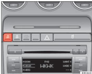
Fig. 154 Consola central con el interruptor del ESC
