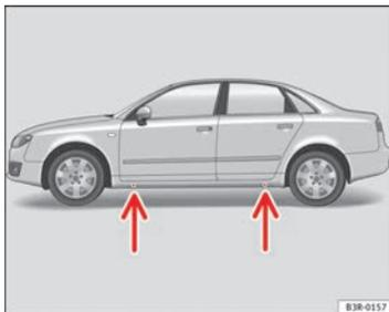
Fig. 185 Cambio de rueda: Puntos de apoyo del gato
