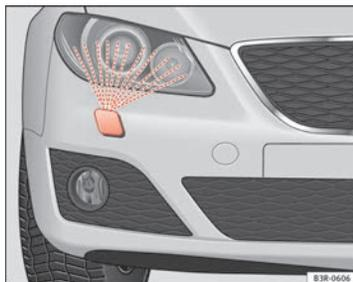
Fig. 102 Faro con eyector de lavado desplegado
