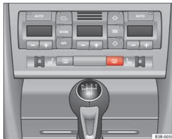
Fig. 97 Interruptor para luneta térmica
