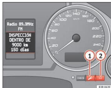
Fig. 52 Detalle del cuadro de instrumentos: Indicación de intervalo de servicio
