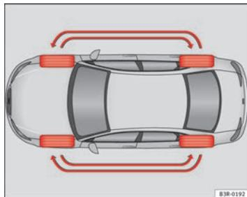
Fig. 180 Esquema para el cambio de ruedas
