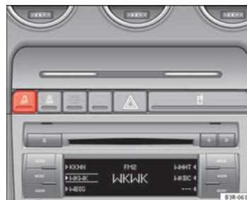
Fig. 135 Detalle de la consola central: tecla ESC ►
