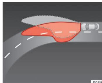
Fig. 90 Faros autodireccionables al conducir ▶
