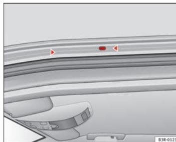
Fig. 119 Puntos de fijación para soportes básicos
