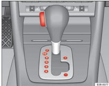
Fig. 148 Detalle de la consola central: Palanca selectora con tecla de bloqueo
