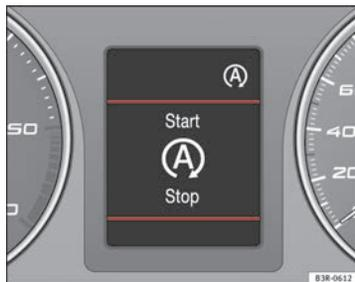
Fig. 139 Indicación en la pantalla del cuadro de instrumentos durante el funcionamiento Start-Stop.
