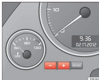
**Fig. 41 Iluminación de los instrumentos**
