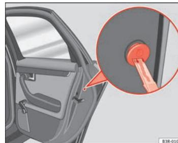
Fig. 72 Dispositivo de bloqueo de emergencia
