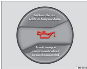
**Fig. 172 Tapón de la boca de llenado de aceite del motor en el vano motor**
