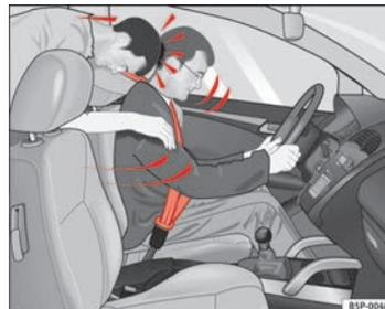
**Fig. 9** El ocupante del asiento trasero que no lleve puesto el cinturón de seguridad se verá lanzado hacia adelante sobre el conductor que sí lleva el cinturón.
