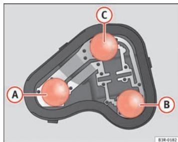
Fig. 214 Ubicación de las lámparas de incandescencia en el portalámparas. Ejemplo: Piloto posterior izquierdo en la aleta.
