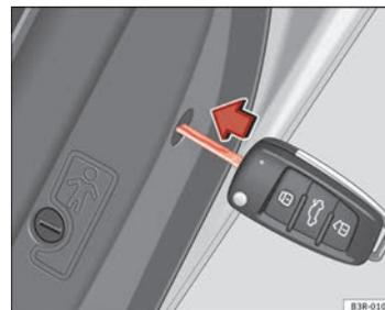
Fig. 73 Activar el bloqueo de emergencia ▶
