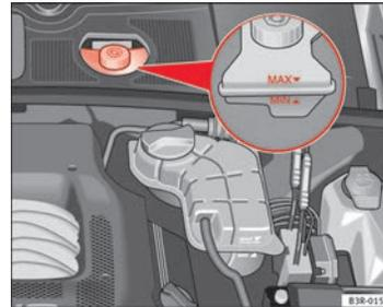
Fig. 177 Compartimento del motor: marcas en el depósito del líquido de frenos
