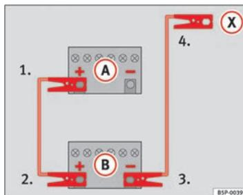
Fig. 231 Esquema para conectar los cables de emergencia en el caso de que el vehículo que suministra la corriente no disponga del sistema Start-Stop: batería descargada (A) y batería que suministra la corriente (B).
