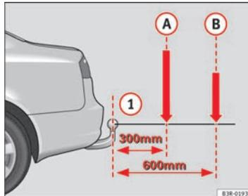
Fig. 155 Representación básica de la distribución de la carga de piezas accesorias y accesorios
