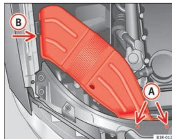
Fig. 205 Conducción de ventilación en el lado derecho del vehículo
