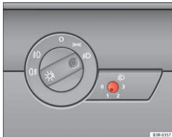
**Fig. 88** Regulación del alcance de las luces
