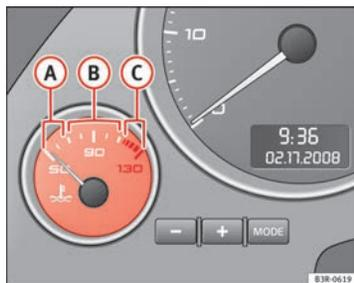
Fig. 38 Indicador de la temperatura del líquido refrigerante del motor
