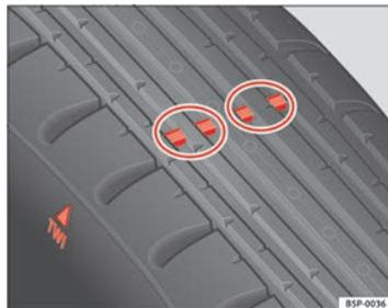
Fig. 179 Indicadores de desgaste del perfil del neumático
