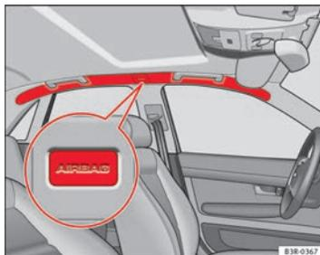
**Fig. 25** Ubicación de los airbags para la cabeza en el lado izquierdo del vehículo
