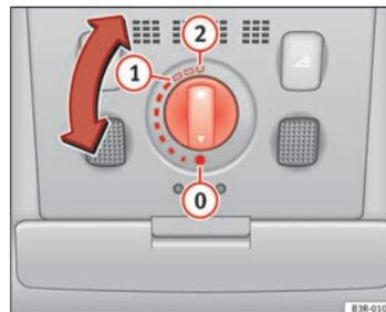
Fig. 81 Detalle del revestimiento del techo: Mando giratorio para el techo corredizo/deflector
