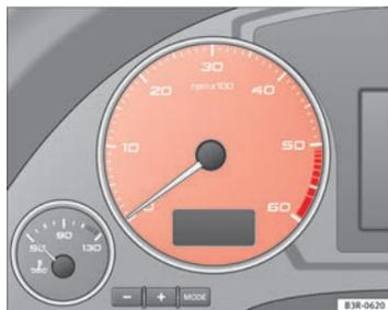
Fig. 39 Detalle del cuadro de instrumentos. Cuentarrevoluciones
