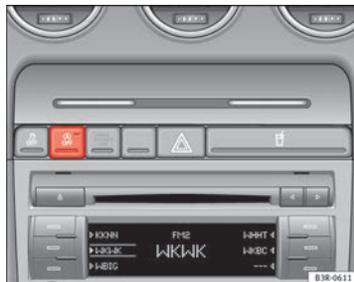
Fig. 138 Detalle del pulsador del funcionamiento Start-Stop.
