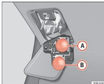
Fig. 222 Ubicación de las lámparas de incandescencia en el portalámparas. Ejemplo: Luces posteriores en el portón del maletero
