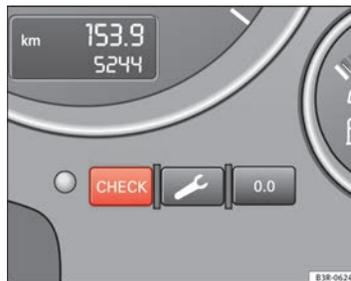
Fig. 53 Cuadro de instrumentos: Tecla CHECK
