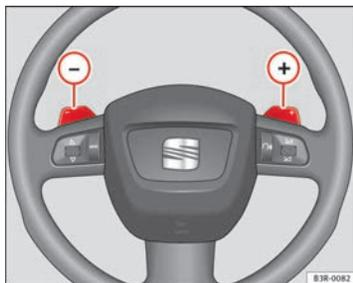
Fig. 153 Volante: Mandos del tiptronic
