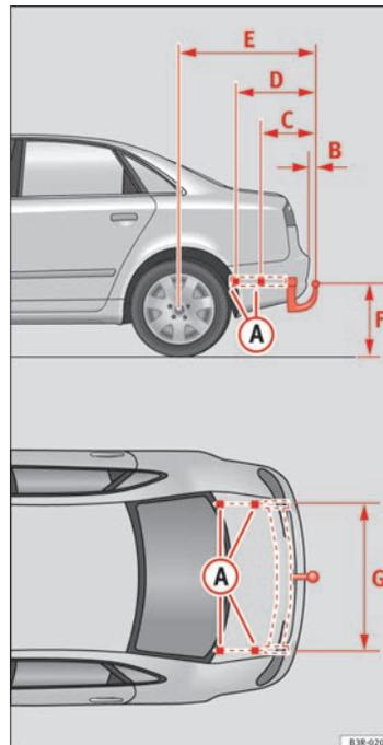
Fig. 166 Puntos de fijación del dispositivo de remolque ▶
