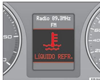
Fig. 54 Pantalla: Aviso sobre el nivel del líquido refrigerante
