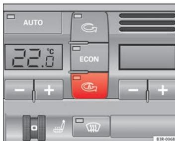
**Fig. 131** Tecla para la recirculación de aire automática
