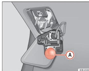
Fig. 223 Ubicación de la lámpara de incandescencia en el portalámparas. Ejemplo: Luces posteriores en el portón del maletero
