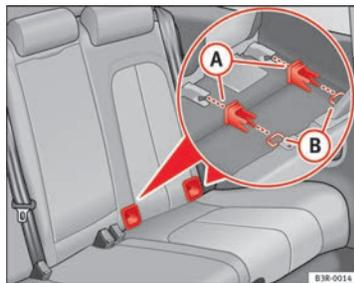
Fig. 32 Posición de los anclajes ISOFIX del asiento posterior lateral
