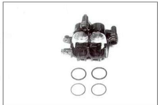
**INSPECCIÓN DE LA PINZA DEL FRENO**
