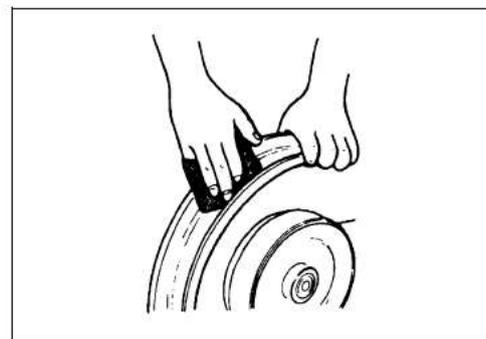
**DATA** Descentramiento (radial y axial) de la llanta de la rueda
