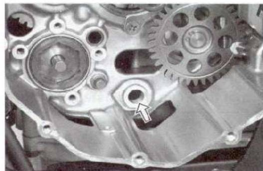
**REENSAMBLAJE DEL EJE DE CAMBIO DE MARCHAS**
