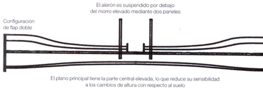
**Figura 4.18.** Vista frontal de un alerón delantero complejo.
