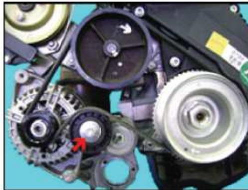
Soporte de fijación de bomba de dirección hidráulica para tensionar correa
