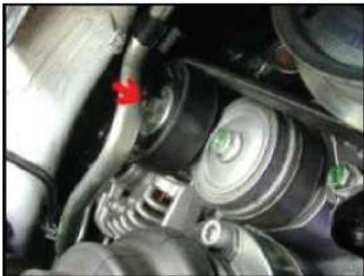
19. Sacar los 8 tornillos de la tapa de protección de la correa y sacar la tapa
