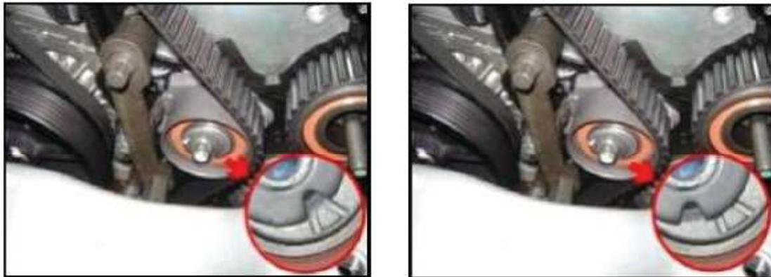
41. Aplicar el torque previsto en la tuerca del tensor
