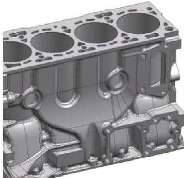
Block en hierro fundido, con el cilindro mecanizado en el propio block y tres clases de sobremedida, cinco bancadas de apoyo para el cigüeñal, siendo la última bancada de apoyo para cargas axiales con dos semicojinetes. Tapones laterales en los conductos de agua montados con interferencia. Árbol secundario instalado directamente en el block para el accionamiento de la bomba de aceite a través de una correa dentada
