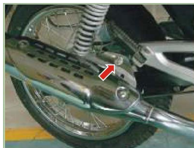
Tornillo silenciador 3.5-4.0 Kg.-m
