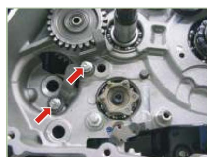
Tornillos guía de leva pedal de arranque 1.1 Kg.-m
