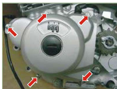
Tornillos tapa magneto 1.1 Kg.-m
