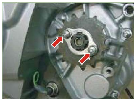
Tornillos seguro sprocket salida 1.1 Kg.-m
