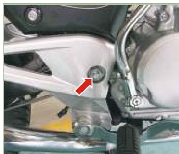
Tuerca eje basculante 8.0-10.0 Kg.-m
