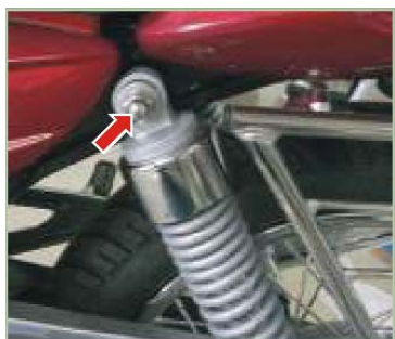
Tuerca amortiguador Trasero Arriba 3.5-4.0Kg.-m Abajo 2.7-3.0kg.-m
