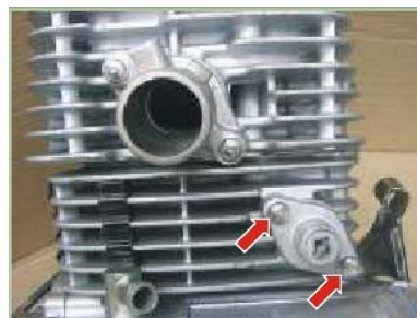
Tornillo tensor cadena 1.1 Kg.-m
