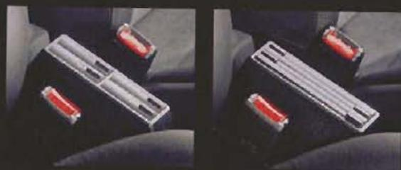
El subwoofer incorpora un altavoz cónico de 200 mm (6L1051700) y el kit de potenciación un amplificador de 600w (1M0051200).
