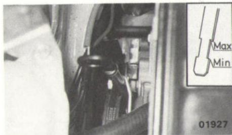
El nivel de aceite debe comprobarse con regularidad y siempre antes de un viaje. Para ello, sitúe el vehículo en terreno llano y con el motor frío extraiga la varilla indicadora de nivel; deberá estar situada entre las marcas MIN y MAX.
