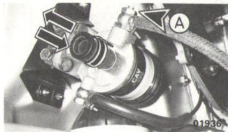
Si se ha vaciado el depósito de combustible, no será preciso purgar la instalación ya que se purga automáticamente durante el arranque; después de haber repostado combustible.
