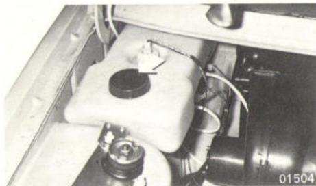
El depósito se encuentra situado en el lado derecho del compartimento del motor.
