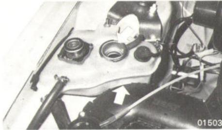
El líquido del sistema de refrigeración sale de fábrica provisto con un compuesto de agua con aditivos anticongelantes y anticorrosivos. Esta mezcla proporciona la necesaria protección anticongelante y anticorrosiva que impide la sedimentación calcárea y eleva el punto de ebullición del agua.
