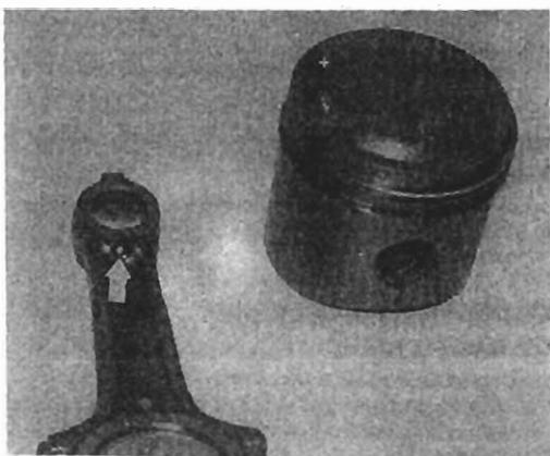
**Sentido de montaje del pistón en la biela:** con el orificio de engrase del pie de biela en el lado de la flecha de la cabeza de pistón. El signo "+" grabado en la cabeza indica el grupo de peso.
