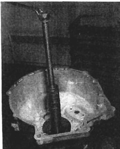
Desmontaje del cárter delantero con ayuda de herramientas especiales (caja de velocidades 260).
