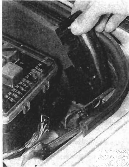
**Desmontaje del protector del conector fijado a la caja de fusibles.**
