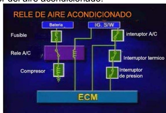
Para comprobar el relé del aire acondicionado, compruebe el funcionamiento y su condición cuando el interruptor esté encendido. Podemos comprobar si el ECM activa el relé o no con los datos de la corriente del Hi-scan. Y entonces medir el voltaje de funcionamiento al conector del compresor del aire acondicionado. El voltaje de funcionamiento debería ser el mismo que el voltaje de la batería. Si no lo es, compruebe el relé del aire acondicionado, fusible, ECM y cables relacionados.
