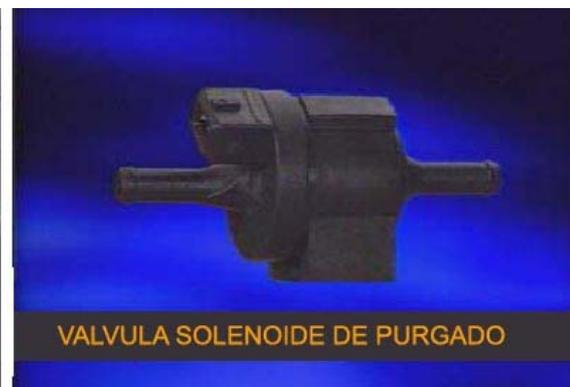
Se encuentra instalada entre el canister y el colector de admisión, dirige o corta el gas de vapor hacia el colector de admisión que es almacenado en el canister. El ECM controla la válvula solenoidal de control de purga.
