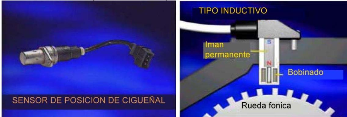
El sensor de la clase inductiva consiste en un imán permanente y una bobina captadora.
