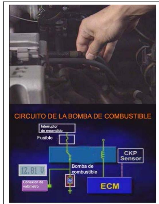
El ECM opera bomba de combustible cuando el sensor de posición del eje del cigüeñal transmite la señal. Si la bomba de combustible, inyector y chispa de encendido no operan cuando gira, compruebe el sensor de posición del eje del cigüeñal. Para la comprobación del sensor de posición del eje del cigüeñal, por favor refiérase a la sección de sensores del motor.
