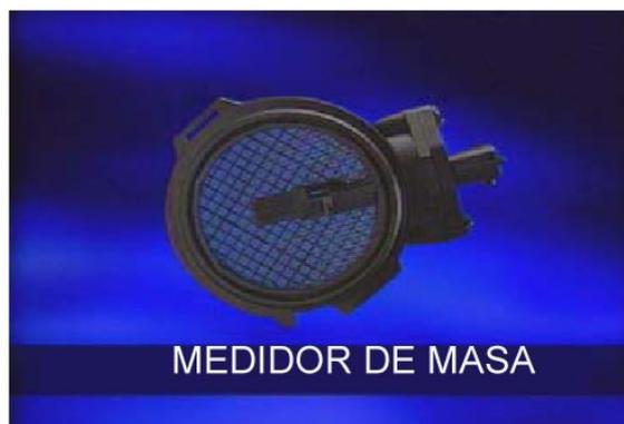
El sensor de temperatura del aire entrante puede ser integrado con el sensor MAP o con el sensor de masa de aire fluyente. Independientemente del modelo, su principio de funcionamiento y procedimientos de revisión son idénticos. Este sensor es una resistencia de Coeficiente Negativo de Temperatura (NTC) lo que significa que la resistencia del componente se reducirá a medida que aumenta la temperatura.
