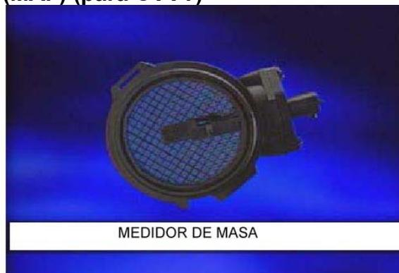
El sensor de masa de aire fluyente se encuentra ubicado entre el purificador de aire y el cuerpo del acelerador.
