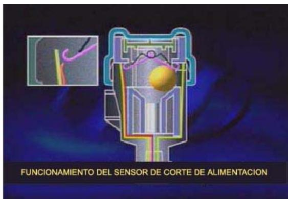
Ahora, echemos una ojeada a cómo funciona, una bola de acero se sitúa en la chapa en forma de V mediante una fuerza magnética.
