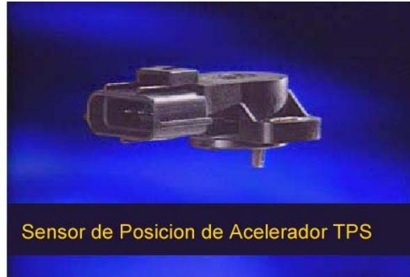
Los sensores de posición del acelerador están instalados en el cuerpo del acelerador y detectan la posición de la válvula del acelerador. En otras palabras, detectan la intención del conductor.
