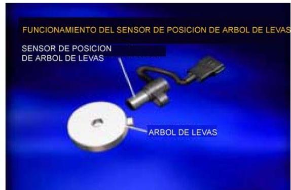
El sensor de posición del árbol de levas monitoriza la posición del árbol de levas y envía las señales al ECM. El ECM distingue el cilindro 1 y el cilindro 4 comparando la señal del sensor de posición del árbol de levas con la señal del sensor de posición del eje del cigüeñal. Conforme a ello, mejora la inyección de combustible
