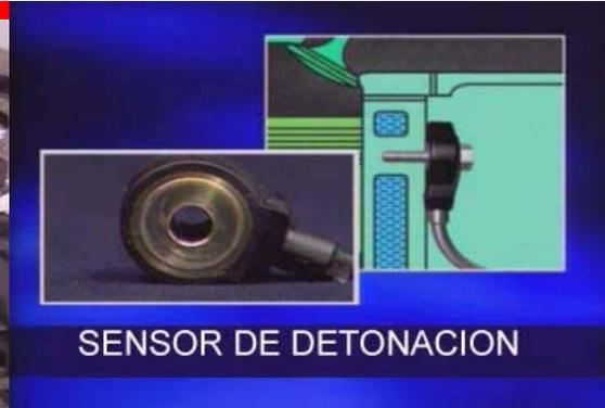
El sensor de detonación utiliza un elemento piezo-eléctrico. Monitoriza la vibración del bloque del cilindro y envía una señal al ECM. El ECM identifica la frecuencia, controla la distribución de encendido y cantidad de inyección para reducir el detonación. Cuando el código de fallo es localizado, compruebe el cableado y los sensores.
