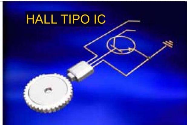
El terminal de este sensor consiste en un sensor de 12V de fuerza, una señal de 5V y tierra.
