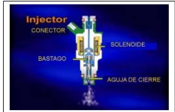
Al igual que para la comprobación de la resistencia, mida la resistencia directamente tras retirar el conector del inyector. Entonces, la condición de la bobina más interna del inyector puede ser comprobada.
