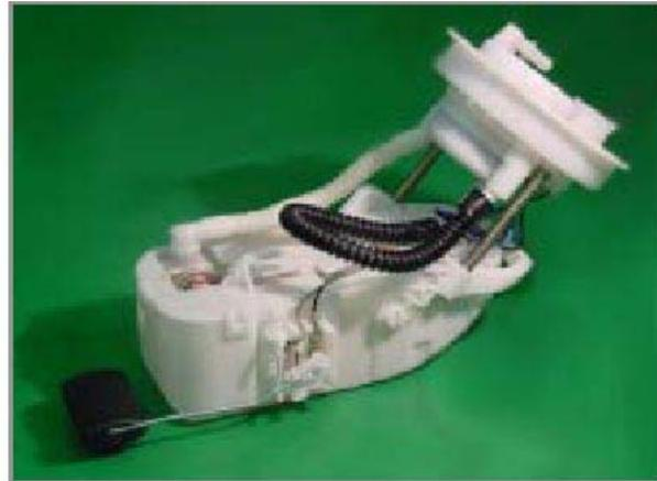
La bomba de combustible se encuentra acoplada al tanque de combustible y está sumergida en combustible. Algunas bombas están ubicadas junto a la unidad de envío de combustible y el filtro de combustible como un módulo. Al módulo de bombeo de combustible se puede acceder mediante un agujero de inspección bajo el asiento trasero.
