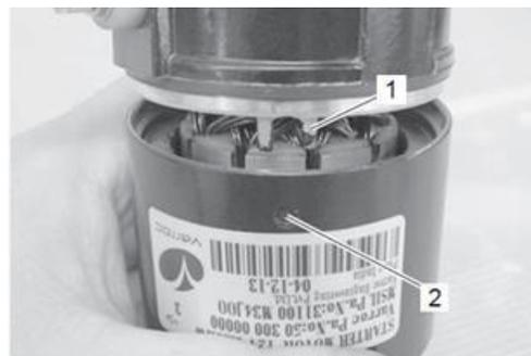
Alinee la saliente (1) en el soporte delantero con la marca grabada (2) en la carcasa del motor de arranque.
