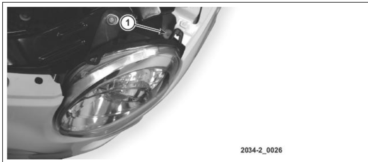
Figura 77 Ajustador de alineación vertical del faro
