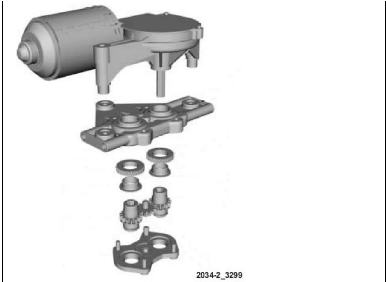
Figura 288 Mecanismo de actuación del cable Bowden
