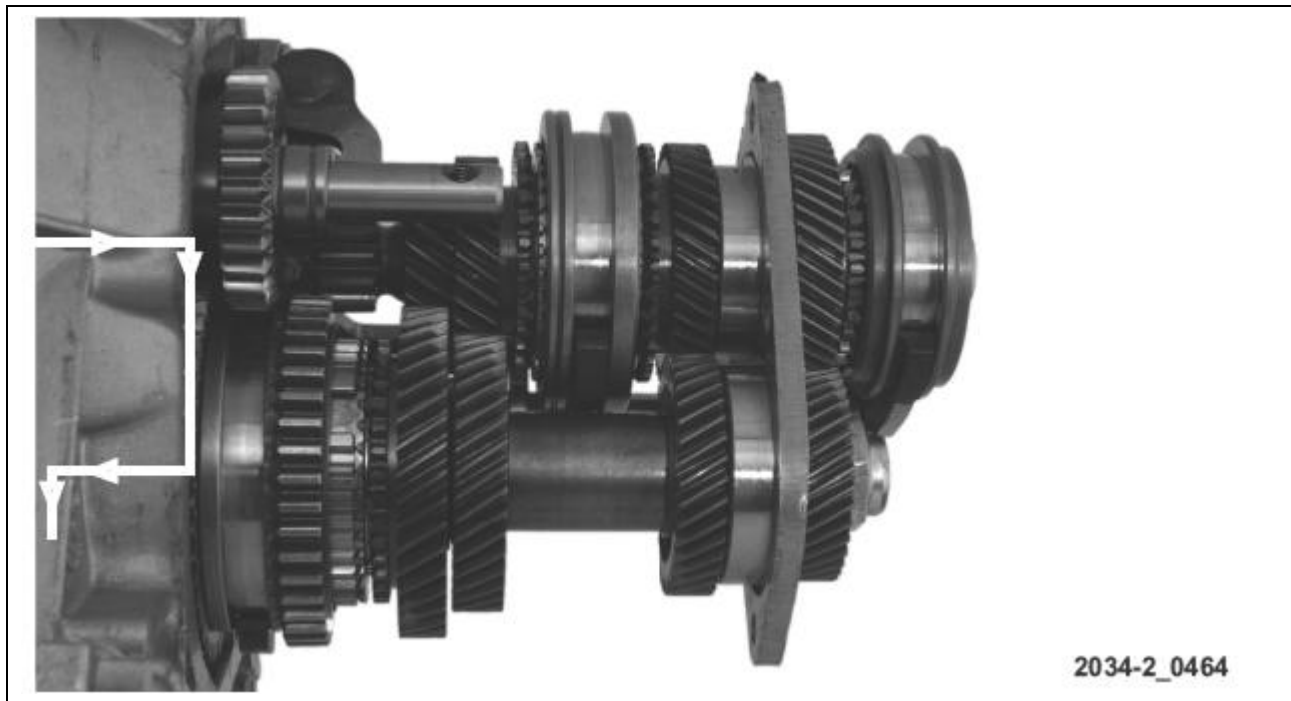
Figura 187 Flujo de potencia del engrane de 1ra
