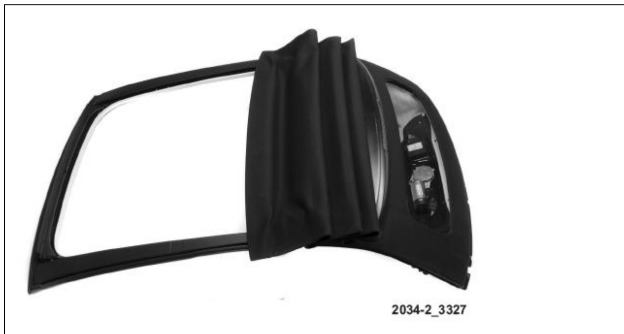
Figura 306 Posición de techo completamente abierto a techo en posición de deflector de aire
