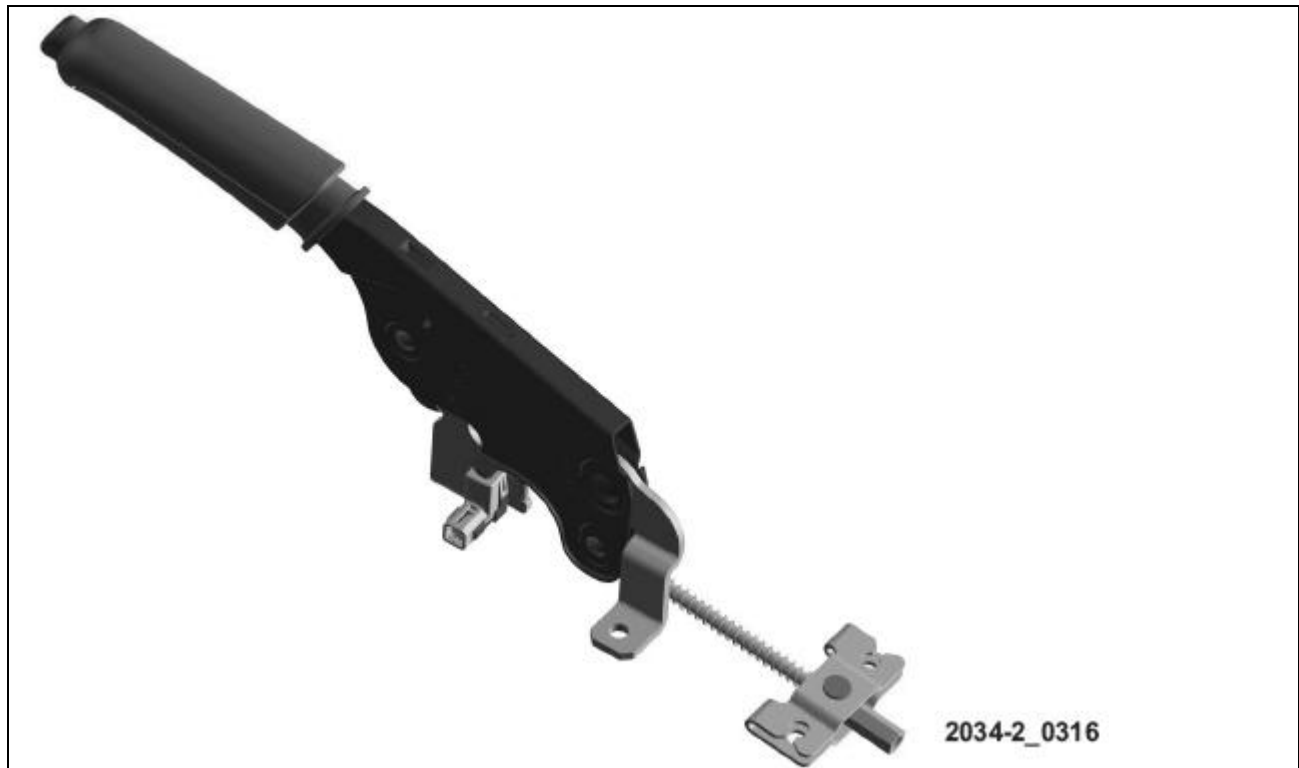
Figura 242 Palanca del freno de estacionamiento
