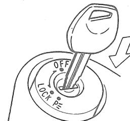
Cuando inserte la llave, alinee la posición del orificio de la tapa con la posición del orificio de la llave.
