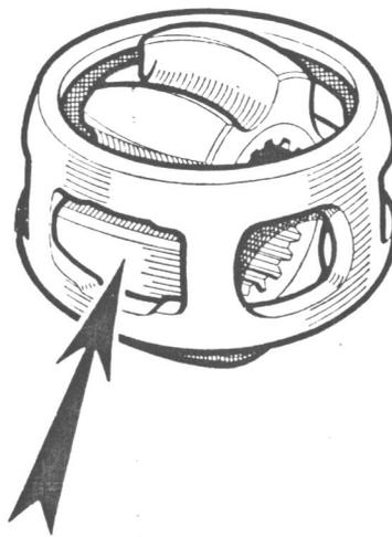
Fig. 4.4.—Modo de colocar el anillo para extraerlo de la jaula.
