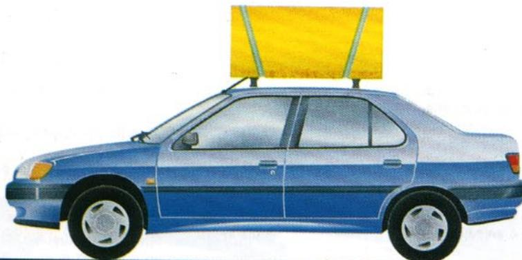
El uso de portaequipaje incrementa el consumo de combustible por la mayor resistencia aerodinámica; retirarlo tan pronto como finalice el transporte. Respetar las capacidades de carga.
