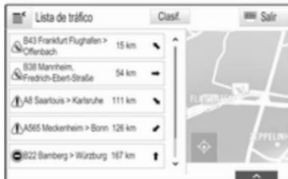
Si la conducción guiada está activa, se visualizan dos botones de pantalla: **Todos** para una lista que muestra los incidentes de tráfico y **En esta ruta** para una lista que muestra solamente aquellos incidentes de tráfico relativos a la ruta actual.
