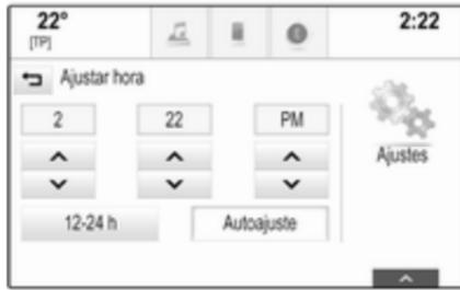
Seleccione **Autoajuste** en la parte inferior de la pantalla. Active **Activado - RDS** o **Desactivado - Manual**.
