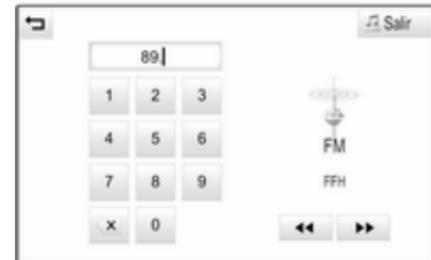
Toque el campo **Sintonización directa** y luego, entre en la frecuencia deseada. Confirme los datos.
