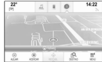
La posición actual se indica mediante un círculo con una flecha que señala hacia la dirección del trayecto.
