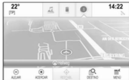
Con la barra de selección de interacción puede cambiar las diferentes vistas dentro de una aplicación o realizar acciones específicas de la aplicación, por ejemplo, iniciar una sesión de reconocimiento de voz.
