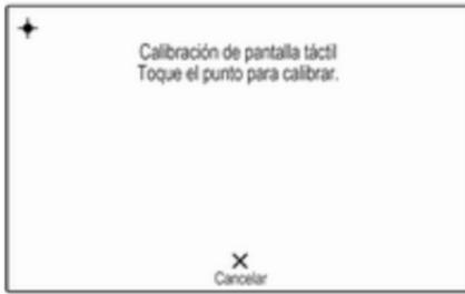
Siga las instrucciones de la pantalla, tocando los puntos correspondientes indicados. La pantalla táctil se ha calibrado.
