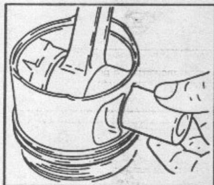
Colocar la nueva biela, el bulón de pistón (untar con aceite de motor) y el nuevo fiador de bulón de pistón.
