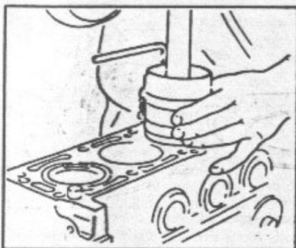
Colocar el pistón con la biela (colocar con aceite motor).
