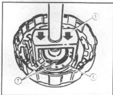
Retirar el conjunto de muelles de recuperación colocando el útil KM-698 (5) y un tubo adecuado sobre el muelle de platillo (6), presionar bajo una prensa (flechas) y con un destornillador, soltar el anillo de seguridad (7).
