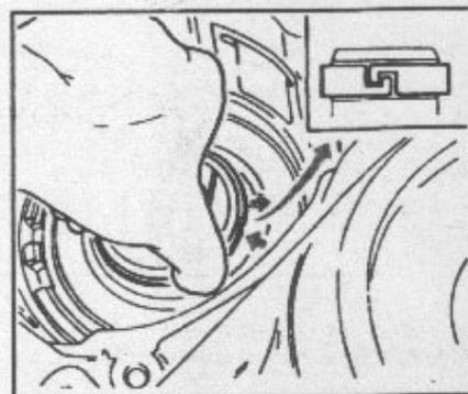
Quitar los 2 anillos de estanqueidad de trinquete de la espiga en la caja (los anillos de enganche tienen forma de L). Presionar un anillo en la ranura y enganchar el otro.
