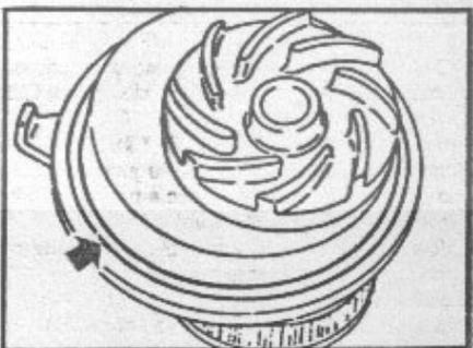
Colocar la bomba de agua con un anillo toroidal nuevo.
