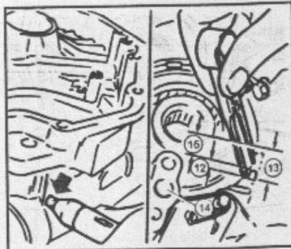
En caso necesario, corregir la carrera del émbolo, montando otro vástago y repetir la medición. Longitudes suministrables: 70,5 mm (1 ranura) y 72,0 mm (2 ranuras).
