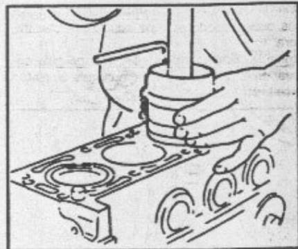
NOTA.- Prestar atención a la posición de montaje. Flecha/muesca en el fondo del pistón señala al lado del mando motor. El reborde en la biela hacia el embrague.
