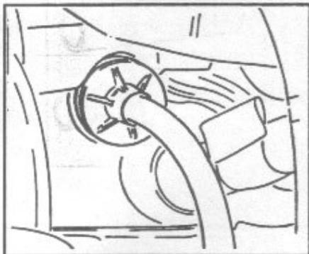
Montaje del cable de embrague
