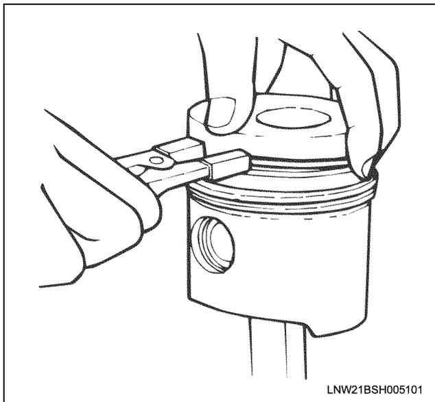
2. Desmontar los anillos elásticos de retención del bulón
