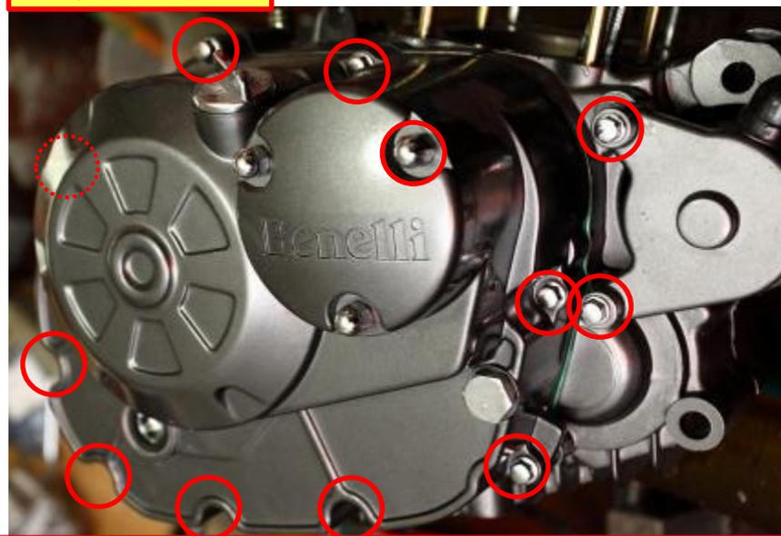
Ponga el espárrago en su lugar y apriete todos los tornillos en la cubierta derecha del cárter<sup>14</sup>
