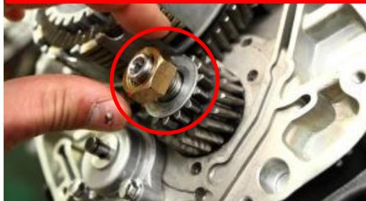
Golpear la arandela plana de seguridad para desbloquear y retirar la tuerca del engranaje de accionamiento de la bomba de aceite,
