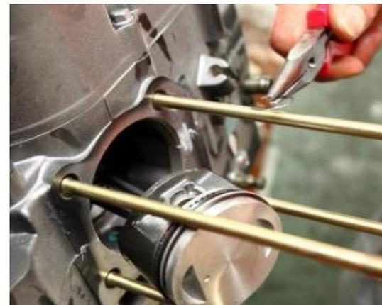
Retire el clip C, el perno de pistón y el pistón
