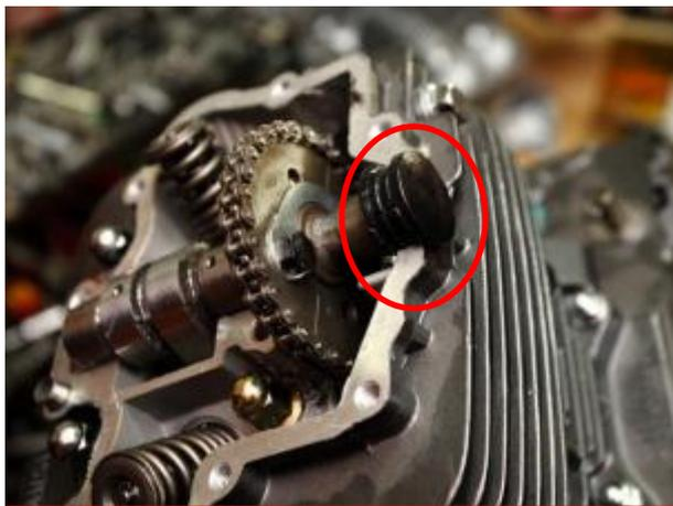
Instalar el tapón del orificio del árbol de levas, aplicar pasta de juntas moderada en todo el perímetro de la superficie de contacto
