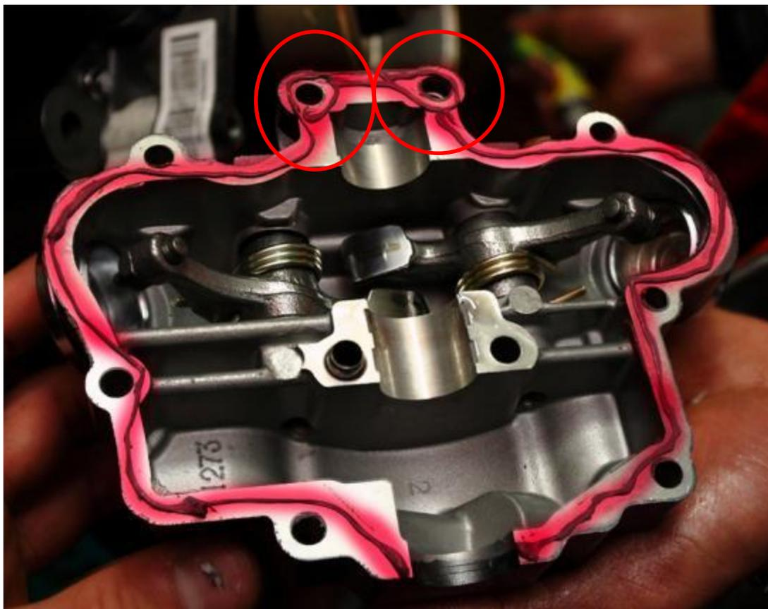
Aplicar junta líquida en la tapa de válvulas como se muestra, marcado en rojo. Tenga en cuenta el circuito de aceite en la parte superior que se muestra con los círculos rojos
