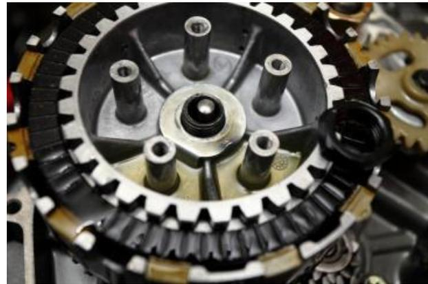
Nota: La parte plana de la arandela especial debe colocarse hacia abajo para adaptarse a la marca plana en la canasta de embrague
