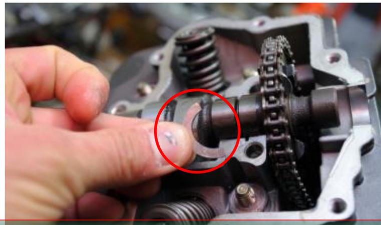
Retire la placa de fijación en forma de C del árbol de levas
