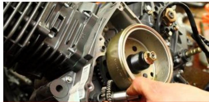
Retire cubierta lateral de carter, motor de arranque, eje y engranajes de reducción de arranque
