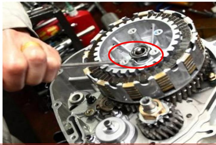
Apriete la tuerca exterior del embrague y trabe la tuerca con la arandela especial, tal como se muestra en la imagen (se recomienda cambiar esta arandela después de cada reparación)
