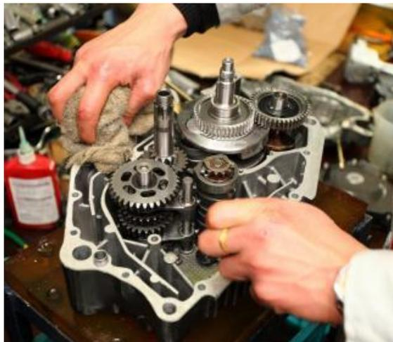
Retire toda la junta líquida antes de la instalación del motor
