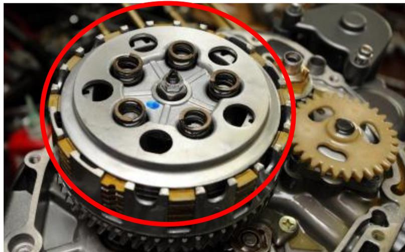
Retire el esparrago de cárter, luego, quite los tornillos de la placa de presión del embrague y desmóntela
