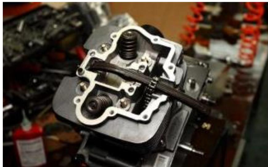
Instalar la culata y usar la guía de la cadena de distribución para evitar que la cadena se caiga hacia el interior del cárter
