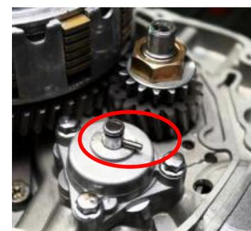
Retire el clip del engranaje plástico de la bomba de aceite, y poner juntos en una pequeña bolsa plástica junto a la espiga
