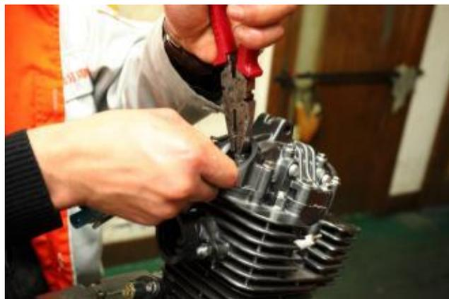
Utilice una pinza para levantar el balancín e introducir la sonda. Recuerde que los balancines tiene un resorte para evitar ruidos
