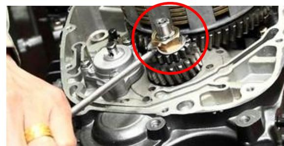
Instalar el engranaje de accionamiento de bomba de aceite, tenga en cuenta que el lado plano va hacia arriba. Apriete la tuerca con la rotación en sentido antihorario, y luego golpear la arandela de seguridad para evitar que la tuerca se afloje
