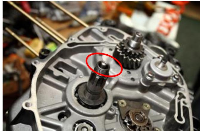
La forma correcta de posición de la varilla de empuje del embrague debe ser uniforme a la parte superior del eje secundario
