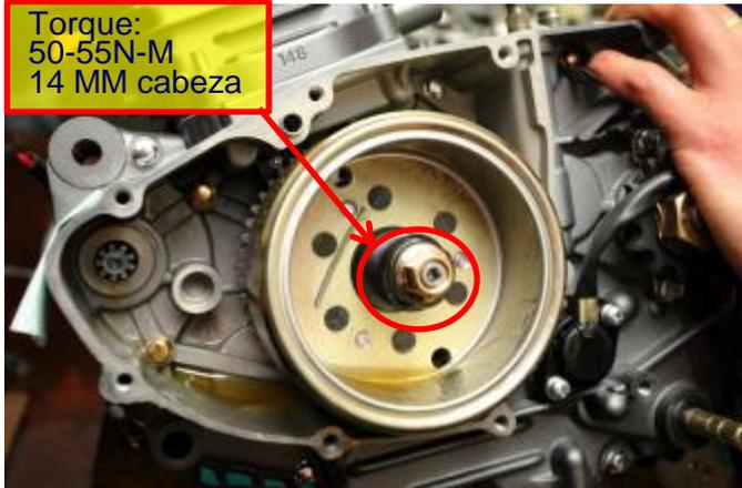
Apriete la tuerca de fijación del volante magnético
