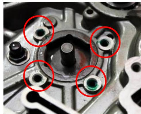
Sólo una gota de Loctite, si suficiente, el tapón de engranaje del neutro será pegado, apretado y de tener problema en el ajuste, cambiar
