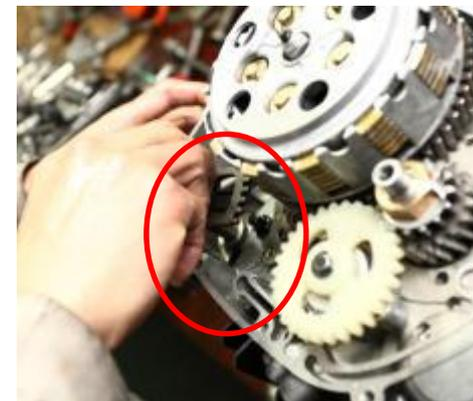
Retire el eje de selectora de cambios
