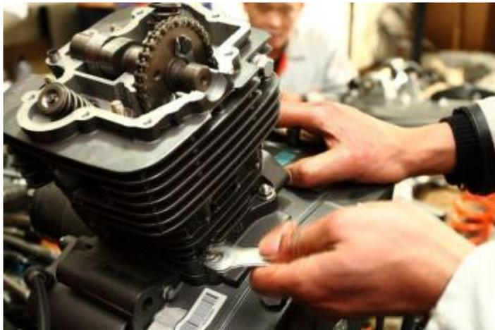
Retire las tuercas de fijación del cilindro
