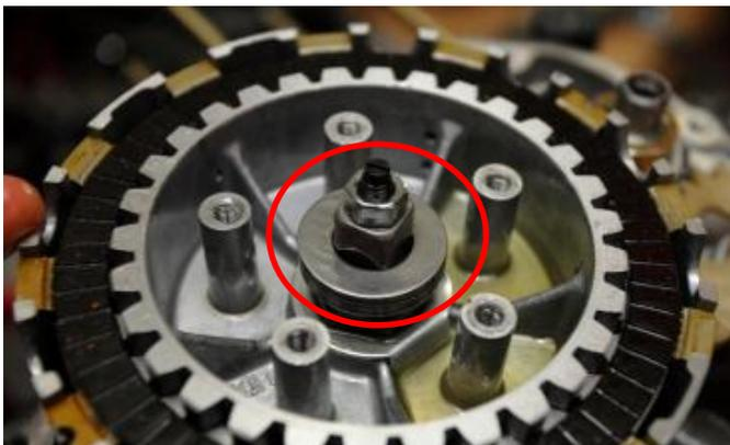
Después de retirar la placa de presión del embrague y el acople de varilla de empuje
