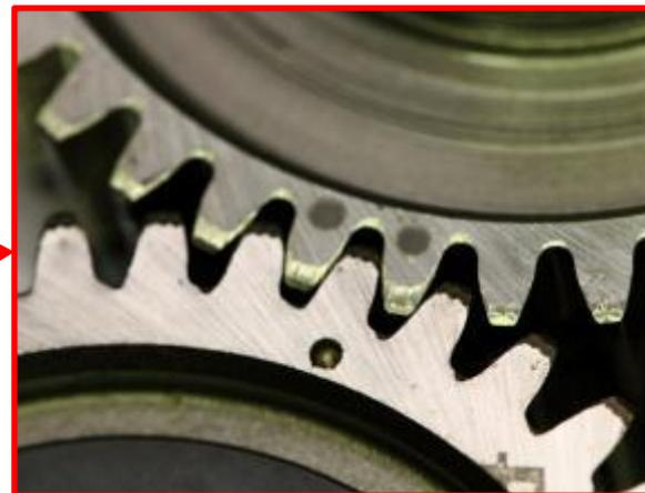
Compruebe la marca de alineación del eje balanceador (dos puntos en el cigüeñal y un punto en el balanceador) deben coincidir entre sí. A continuación, girar el cigüeñal para ver si resulta bien. También por favor retire el balanceador para comprobar si había cualquier tipo de daños en la superficie.
