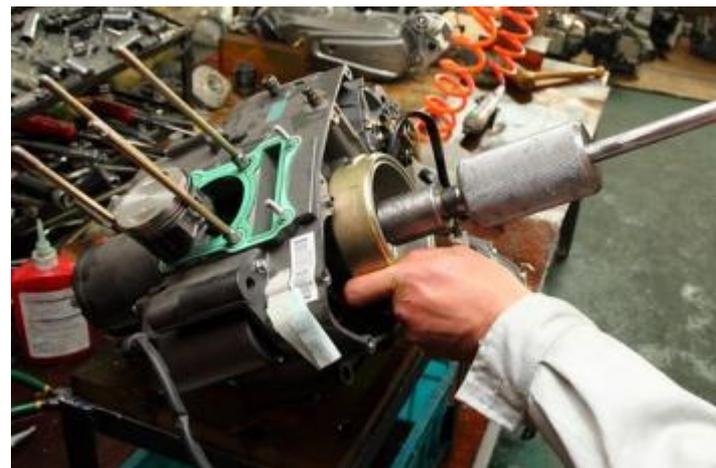
Extraiga el volante magnético con herramienta de tracción especial
