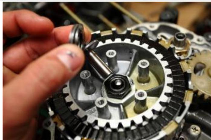
El acoplamiento la varilla de empuje se puede sacar libremente. Para evitar la confusión del orden de instalación, puede atar el 2 arandelas, del rodamientos de empuje con un alambre.
