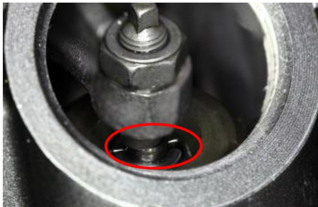
Holgura de válvulas: AD / ES: 0,05 ~ 0,08 mm con el motor en frío
