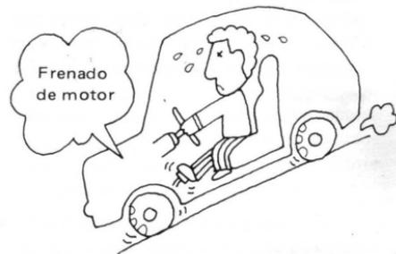
Si usted se vale solamente de los frenos de servicio, pueden fallar eventualmente los mismos. Además, el uso excesivo de solamente los frenos de servicio por largo período es muy peligroso. Asegúrese de usar también el freno de motor.
