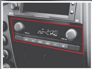
Panel de control del aire acondicionado / calefacción
