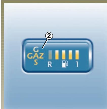
El testigo **2** del indicador de nivel de gas, ubicado en el centro del panel de instrumentos, indica el modo seleccionado.
