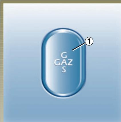
Su vehículo puede desarrollar un óptimo funcionamiento tanto con nafta como con GNC. La tecla de selección de combustible **1**, ubicada en el panel de instrumentos a la izquierda del volante, permite pasar de un combustible al otro.
