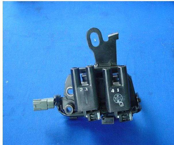
Bobina primaria :  $0.5\Omega \pm 0.05\Omega$
