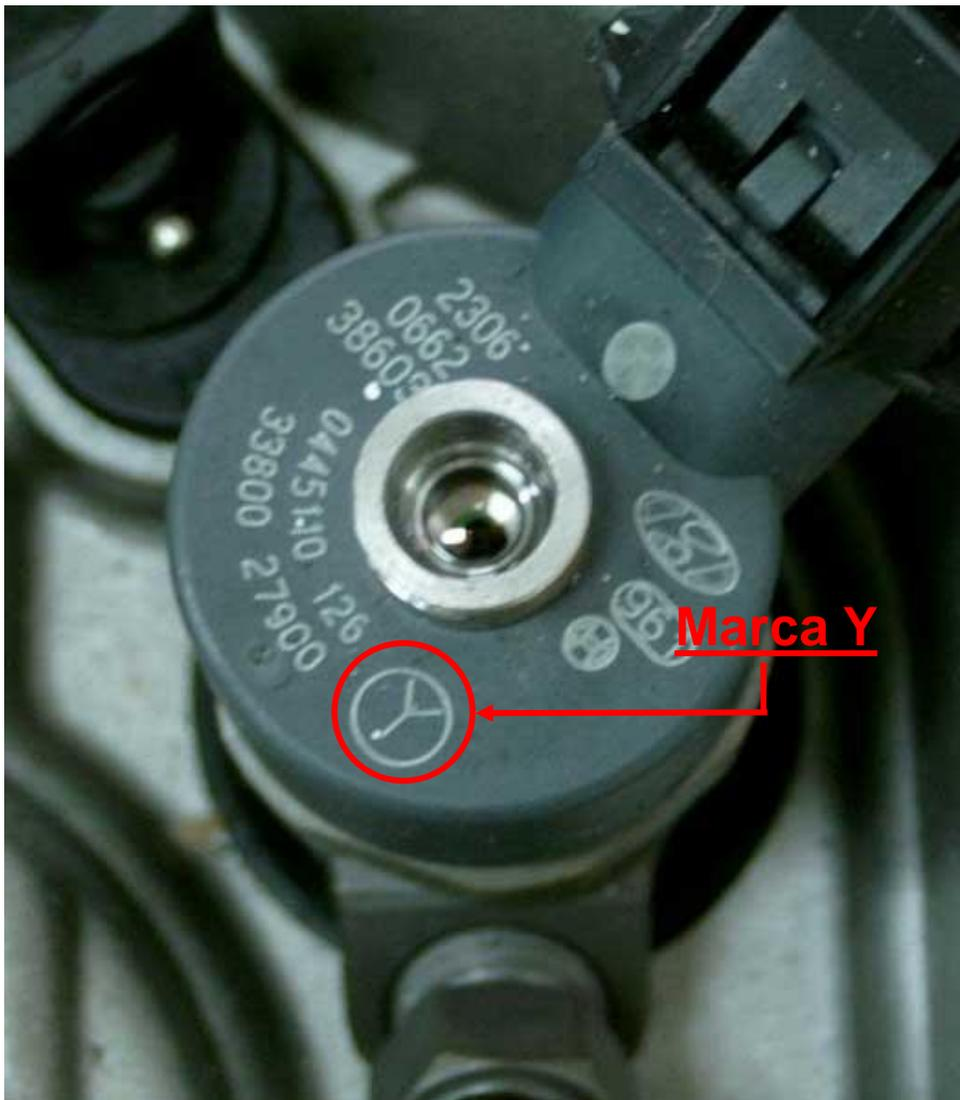
Fig. Inyector graduado
