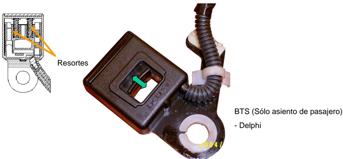
Este sensor es utilizado para el sistema de retención de niños (CRS). Sí se instala un asiento de niño en el asiento del pasajero delantero, la carga es sensada por la ampolla sensora pero no exactamente, porque el asiento del pasajero puede ser comprimido inicialmente al instalar el asiento de niño. Para compensar esta precarga del asiento de niño, este valor inicial de tensión es sustituida por la PODS-B ECU para una situación más exacta en el asiento del pasajero.
