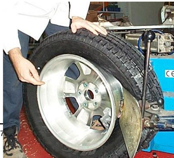
Al introducir el brazo de desmontaje desde el lado trasero se mueve sobre el aro y puede hacer contacto con el sensor en esta posición. TRW recomendaría que el sensor sea instalado aproximadamente a 180° cuando se desmonta el neumático por la parte trasera.
