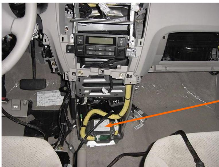
La ACU está en la parte central longitudinal debajo del ensamble de la consola central.
