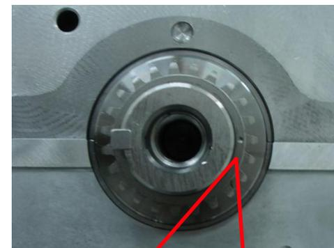
Marca en el piñón del cigüeñal alineada con la unión entre block y tapa de bancada
