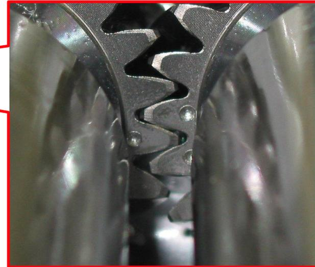
Para la sincronización de los ejes contra rotantes entre si, debe hacer coincidir las marcas en los engranajes como se muestra en la figura.
