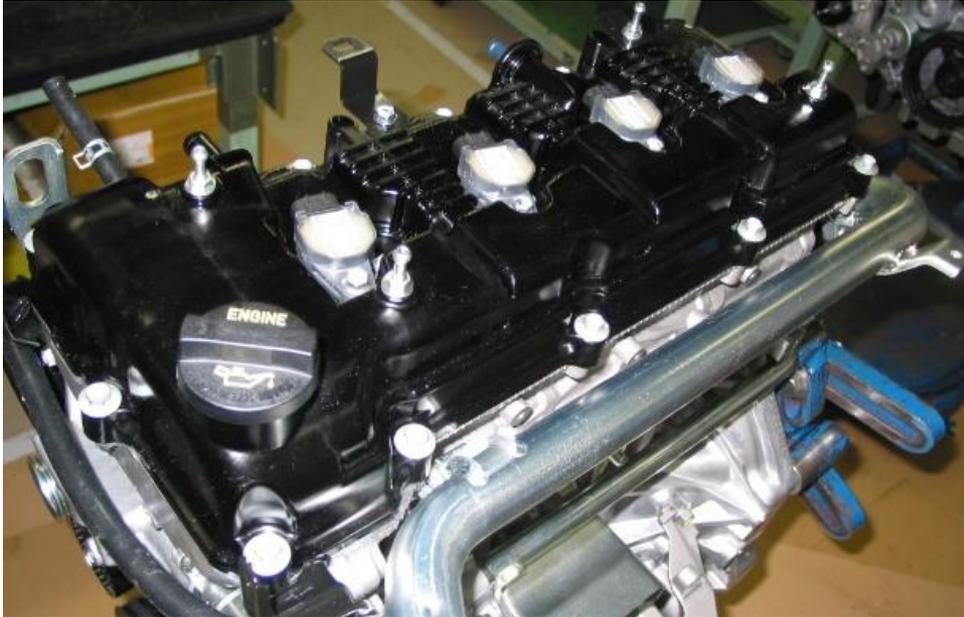
La tapa de válvulas esta constituida en resina plástica para mejorar la insonorización del motor.
