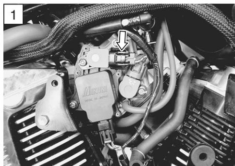
**DATA** Tensión de entrada del sensor STP: 4,5 – 5,5 V
