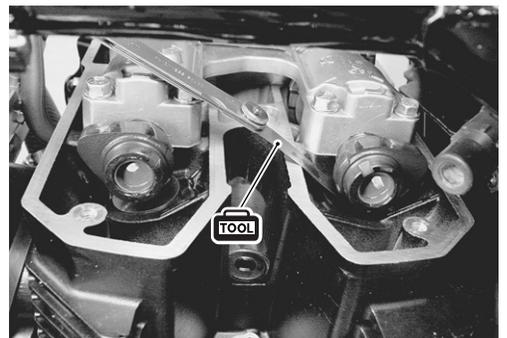
**2-10 MANTENIMIENTO PERIÓDICO****AJUSTE DE LA HOLGURA DE VÁLVULAS**
