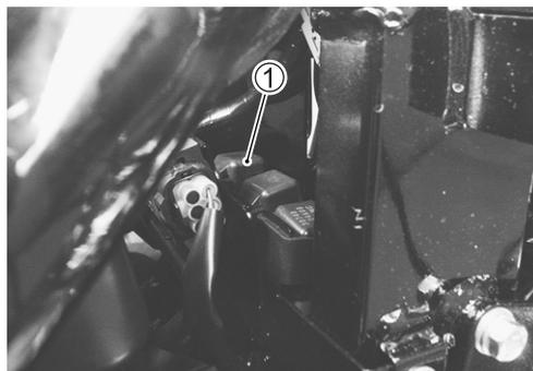
Compruebe primero el aislamiento entre terminales A y B con el polímetro. Aplique a continuación 12 voltios a los terminales C y D, + a C y - a D, y compruebe la continuidad entre A y B.
