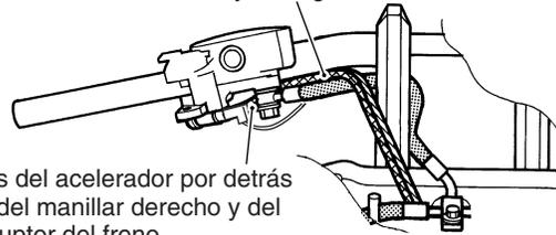
Pase los cables del acelerador por detrás del interruptor del manillar derecho y del cable del interruptor del freno.
