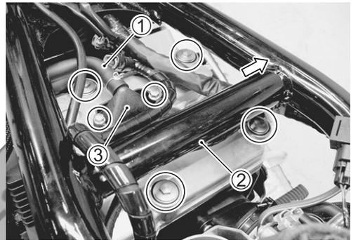
El valor especificado de la holgura de válvulas es distinto para las válvulas de admisión y las de escape. La holgura de válvulas debe comprobarse y ajustarse: 1) en las revisiones periódicas; 2) en las reparaciones del mecanismo de las válvulas; y 3) cuando se extraigan los árboles de levas para su mantenimiento.
