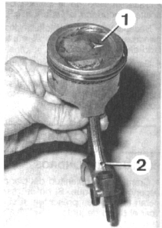
Sentido de montaje de biela y pistón 1. Flecha hacia la distribución - 2. Surtidor de aceite.
