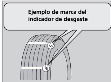
La ranura en la que está situado el indicador de desgaste es 1,6 mm menos profunda que cualquier otro punto del neumático. Si la banda está desgastada y el indicador queda visible, sustituya el neumático. **Los neumáticos desgastados presentan una tracción deficiente en calzadas mojadas.**
