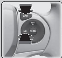
Si se enciende un testigo diferente, pulse el botón **LIM** para cambiar al limitador ajustable de velocidad.
