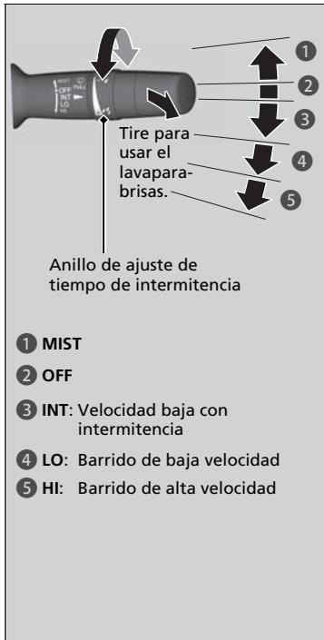
Los limpiaparabrisas y lavaparabrisas se pueden utilizar cuando el interruptor de encendido está en la posición de CONTACTO \*1.
