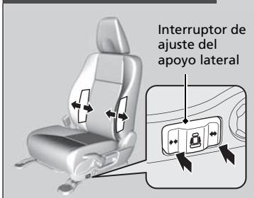
■ **Interruptor de ajuste del apoyo lateral\***
