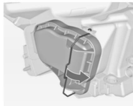
1. Desenclave el clip de alambre y desmonte la tapa protectora **1**.
