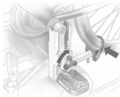
Apriete al máximo manualmente el tornillo de la fijación para la biela.
