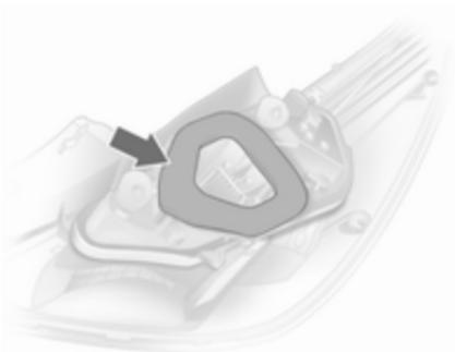
8. Asegúrese de que la junta del portalámparas esté colocada como en la ilustración.
