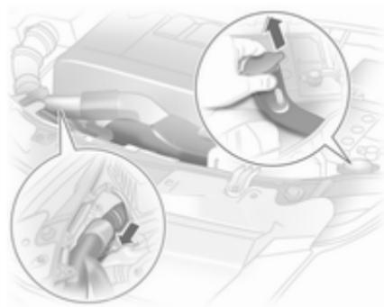
Para sustituir las bombillas en el lado derecho del compartimento del motor, desacople el tubo flexible del filtro de aire.
