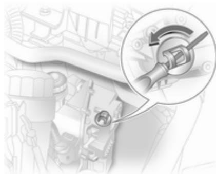
Si hay que retirar el vehículo de la calzada para no obstaculizar el tráfico, suelte el embrague del siguiente modo:
