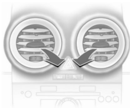
Oriente el flujo de aire girando la rueda de ajuste de derecha a izquierda y levantando o bajando las aletas horizontales.
