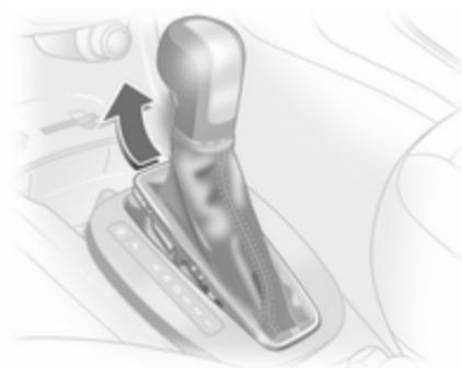
2. Suelte el revestimiento de la palanca selectora por la parte delantera de la consola central, levántelo y gírelo hacia la izquierda.
