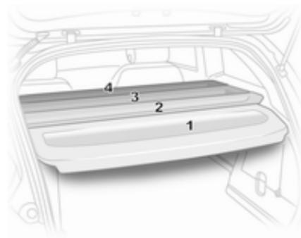
La cubierta del compartimento de carga consta de cuatro segmentos que se pueden extraer o insertar individualmente.
