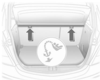
Fije los sistemas de retención infantil con anclaje superior a las argollas en la parte posterior del asiento trasero y al carril del asiento del acompañante en la zona reposapiés trasera. La correa debe pasar entre las dos varillas guía del reposacabezas.
