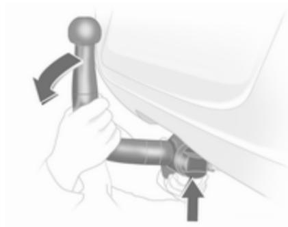
Inserte la barra de rótula tensada en la abertura y presione con fuerza hacia arriba, hasta que enclave de forma audible.
