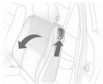
Levante la palanca de desbloqueo e incline el respaldo hacia delante. Baje la palanca de desbloqueo y el respaldo se enclava en posición abatida. Deslice el asiento hacia delante.
