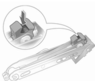
4. Ajuste el gato a la altura necesaria. Coloque el gato directamente debajo del punto de elevación, de modo que no pueda resbalar.
