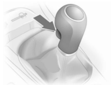
Para engranar la marcha atrás: con el vehículo parado, espere 3 segundos después de pisar el pedal de embrague, luego pulse el botón de desbloqueo en la palanca selectora y engrane la marcha.
