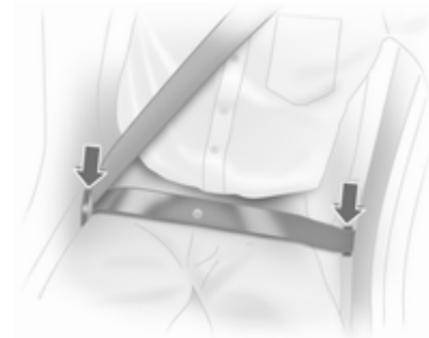
En caso de colisiones frontales y traseras, a partir de una determinada gravedad, se tensan los cinturones de seguridad delanteros.
