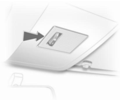
1. Desenclave el difusor con un destornillador en la posición indicada en la ilustración y desmóntelo.
