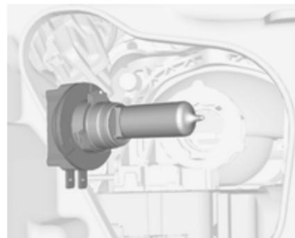
3. Inserte la bombilla nueva en el reflector de modo que la lengüeta de fijación del portalámparas quede alineada con el rebaje del reflector.
