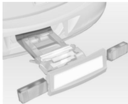
Compruebe la correcta colocación de los cables y la posición de las luces.
