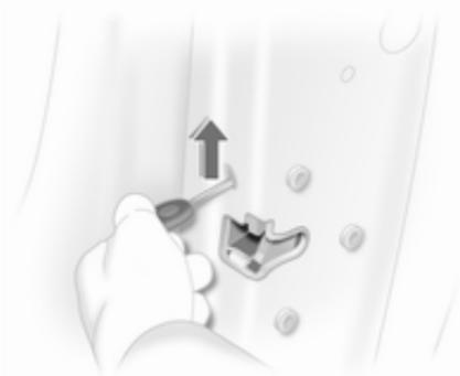
Inserte la llave en la abertura situada encima de la cerradura, en el interior de la puerta, y accione el bloqueo presionando hasta que haga clic. Luego cierre la puerta. El procedimiento debe realizarse para cada puerta. La puerta del conductor también se puede bloquear desde el exterior con la llave. La tapa del depósito de combustible y el portón trasero no se pueden bloquear.
