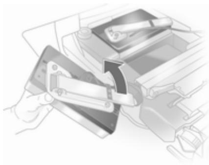
Despliegue completamente los soportes que hay en la parte posterior de la luz trasera hasta que enclaven.
