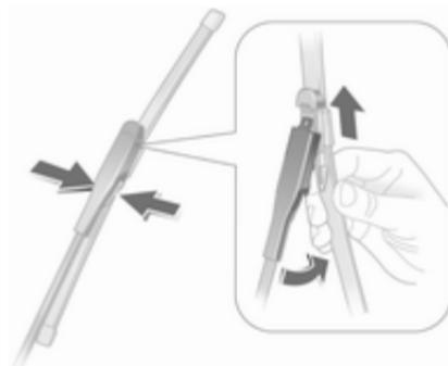
Levante el brazo del limpiaparabrisas, incline la escobilla 90° respecto al brazo del limpiaparabrisas y desmóntela hacia el lado.
