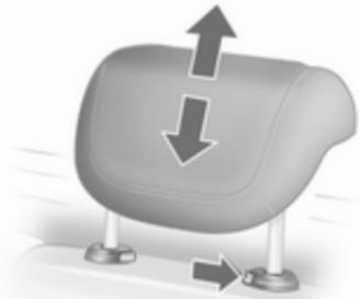
La altura de los reposacabezas puede ajustarse en dos posiciones. Para ajustarlo en la primera posición, tire del reposacabezas hacia arriba; para la segunda posición, pulse el resorte marcado en la ilustración y levante el reposacabezas a tope hasta arriba. Para bajarlo, pulse el resorte marcado en la ilustración y empuje el reposacabezas hacia abajo.
