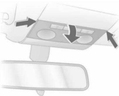
1. Desenclave el difusor, presione ligeramente hacia abajo y desmóntelo inclinado hacia abajo.
