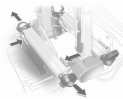
Pulse la palanca de desbloqueo y extraiga los alojamientos para las ruedas.
