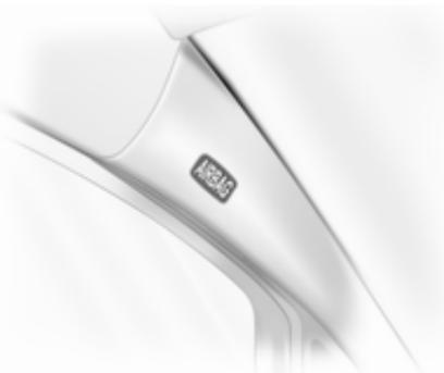
El sistema de airbags de cortina se compone de un airbag en el marco del techo a cada lado. Se pueden identificar por el rótulo **AIRBAG** en los pilares del techo.
