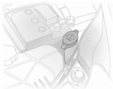
Llene el depósito con agua limpia mezclada con una cantidad adecuada de líquido lavaparabrisas que contenga anticongelante. Para la relación correcta de la mezcla, consulte el depósito del líquido de lavado.
