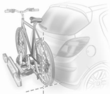
Alinee la bicicleta en sentido longitudinal respecto al vehículo. Afloje ligeramente la fijación para la biela.
