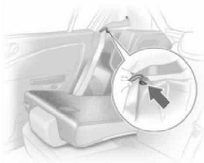
Enderece los respaldos del asiento trasero y deje que los mecanismos de bloqueo enclaven audiblemente en ambos lados. Una vez bloqueados los respaldos, ya no debe sobresalir la marca roja.
