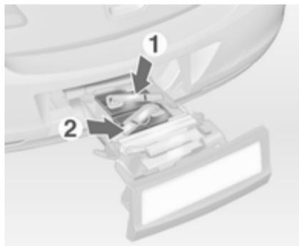
Pliegue los soportes en la parte posterior de las luces traseras.
