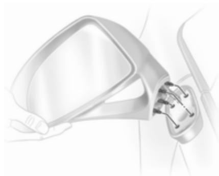
Corsa OPC: Para mayor seguridad de los peatones, los retrovisores exteriores del Corsa OPC se sueltan de su soporte en caso de colisión. Coloque la carcasa del retrovisor en el soporte con las lengüetas y enclave con un golpe suave.
