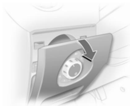
La caja de fusibles está detrás del conmutador de las luces. Tire del borde superior del panel y bájelo.
