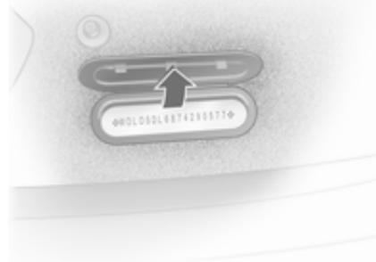
El número de identificación del vehículo está estampado en la placa de características y en el panel del piso, debajo de la cubierta del piso, visible bajo una tapa.
