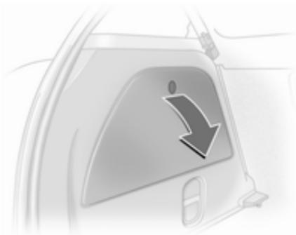
La caja de fusibles está en el lado izquierdo del compartimento de carga, detrás de una tapa. Desmonte la tapa.
