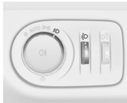
Para adaptar el alcance de los faros a la carga del vehículo y evitar el deslumbramiento: Gire la rueda de ajuste ⇨ hasta que aparezca el ajuste deseado en la pantalla del cuentakilómetros.
