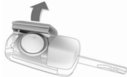
Despliegue la llave y abra la unidad. Sustituya la pila (tipo CR 2032), prestando atención a la posición de montaje. Cierre la unidad y sincronice el mando a distancia.
