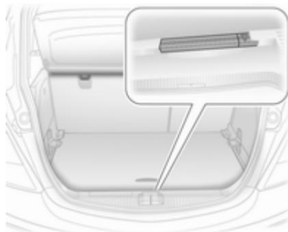
Guarde el triángulo de advertencia en la pared trasera del compartimento de carga: coloque primero el triángulo de advertencia en el rebaje de la izquierda y luego insértelo en la guía de la derecha.
