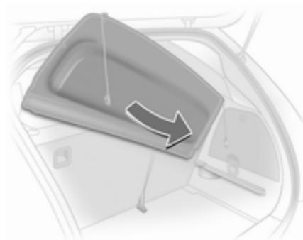
Levante la cubierta hacia atrás, hasta que se desenclave, inclínela y luego desmóntela.
