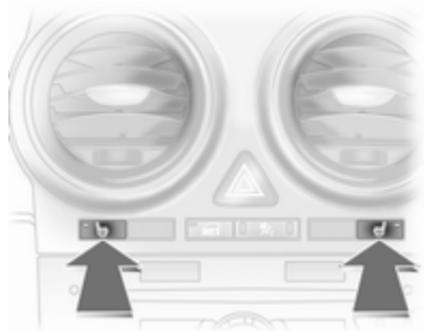
Con el encendido conectado, pulse el botón
