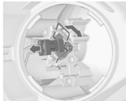
3. Desenclave el clip elástico de la sujeción moviéndolo y girándolo a un lado.
