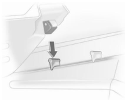
Para el desmontaje de los otros tres segmentos (orden del 2 al 4), se debe levantar el segmento por detrás, desenclavarlo, girarlo y sacarlo.
