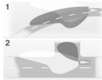
El haz de luz gira dependiendo de la posición del volante y de la velocidad.
