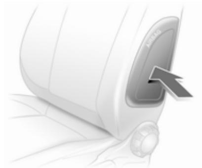
El sistema de airbags laterales se compone de un airbag en cada respaldo de los asientos delanteros y uno en los respaldos de los asientos exteriores traseros. Se pueden identificar por el rótulo **AIRBAG**.
