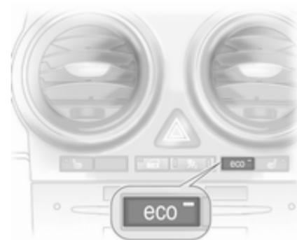
Desactive manualmente el sistema stop-start pulsando el botón **eco**. Para indicar la desactivación, se apaga el LED del botón.
