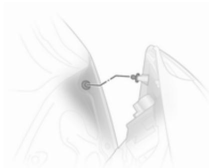
9. Inserte la caja en la carrocería del vehículo y apriete las tuercas de fijación a mano. Enchufe el conector. Cierre la tapa.
