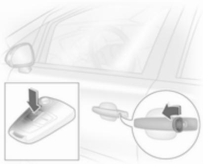
Para desbloquear las puertas y el compartimento de carga, gire hacia delante la llave en la cerradura de la puerta del conductor o pulse el botón . Abra las puertas tirando de la manilla correspondiente. Para abrir el portón trasero, accione el botón situado debajo de la moldura.
