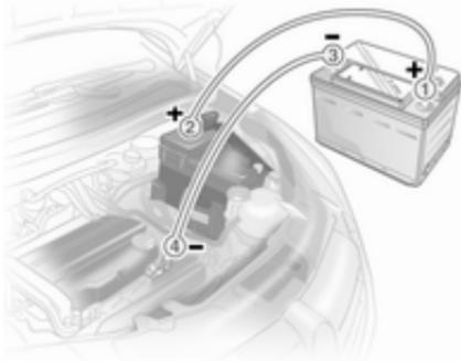
Sitúe los cables de forma que no puedan engancharse en piezas giratorias del compartimento del motor.
