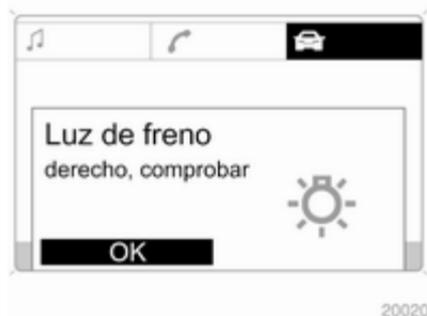
La luz averiada se indica en la pantalla de información o bien aparece **InSP2** en la pantalla del tablero de instrumentos.
