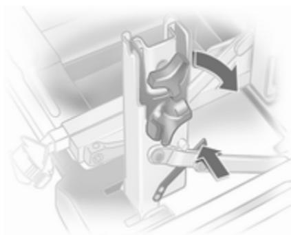
Desenclave la palanca de bloqueo en el apoyo diagonal y pliegue hacia abajo los alojamientos para la biela.
