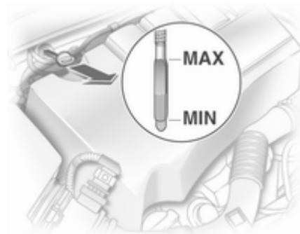
Rellene aceite de motor cuando el nivel haya descendido hasta la marca MIN.
