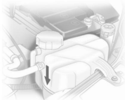
Con el sistema de refrigeración frío, el nivel del refrigerante debe estar por encima de la marca **KALT/COLD**. Rellene si el nivel es más bajo.
