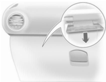
En los vehículos con volante a la derecha, la caja de fusibles está situada detrás de una tapa en la guantera. Abra la guantera y desmonte la tapa. Para cerrarla, coloque primero la tapa y luego enclávela en su posición.
