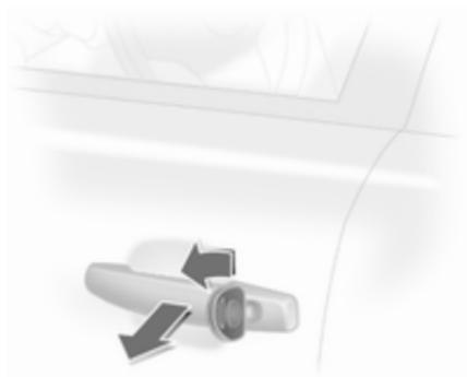
Gire hacia delante la llave en la cerradura de la puerta del conductor.
