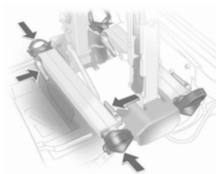
Pulse la palanca de desbloqueo e inserte los alojamientos para las ruedas completamente, hasta el tope.
