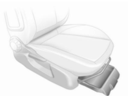
Levante por el rebaje del borde y extraígalo. Carga máxima: 1,5 kg. Para cerrarlo, presione y enclave.
