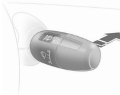
Presione la palanca hacia delante. El limpiacristales funciona a intervalos. Para desconectarlo, vuelva a presionar la palanca hacia delante.
