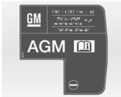
Las baterías AGM se pueden identificar por la etiqueta en la batería. Le recomendamos el uso de una batería original Opel.
