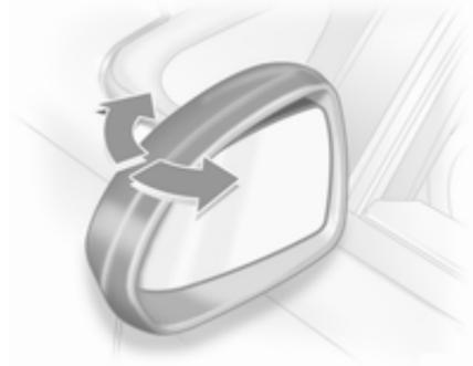
Para la seguridad de los peatones, los retrovisores exteriores basculan de su posición de montaje normal al recibir impactos de una determinada fuerza. Vuelva a colocar el retrovisor en su posición presionando ligeramente sobre la carcasa.
