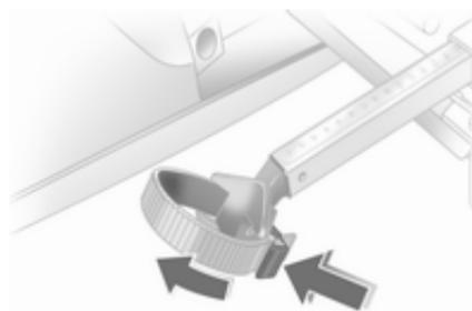
Pulse la palanca de desbloqueo de la cinta de sujeción y saque la cinta.
