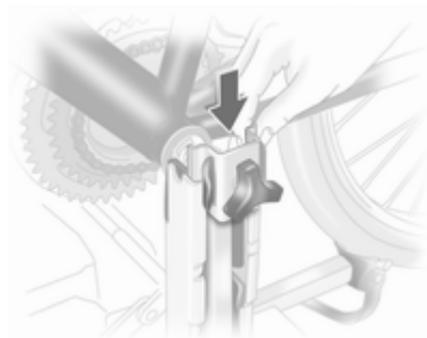
Inserte la fijación para la biela en el carril exterior del alojamiento desde arriba, y deslícela hacia abajo hasta el tope.
