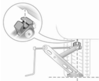
Acople la manivela del gato y, con el gato correctamente alineado, gire la manivela hasta que la rueda se despegue del suelo.
