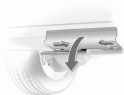
Comprima los dos pestillos hacia dentro y desmonte la tapa del para-choques.
