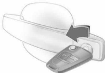
Gire hasta el tope la llave en la cerradura de la puerta del conductor. Al abrir la puerta del conductor, se desbloquea todo el vehículo. Para desbloquear las otras puertas, conecte el encendido y pulse el botón del cierre centralizado.
