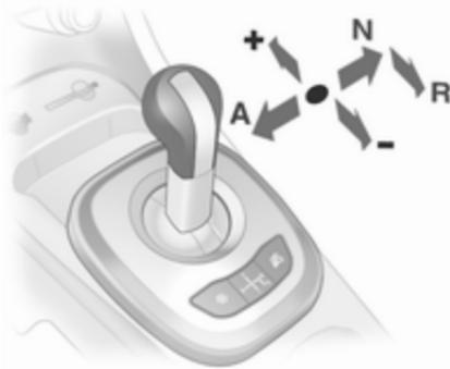
La palanca selectora siempre debe moverse en la dirección apropiada todo lo que sea posible. Una vez que la suelte, volverá automáticamente a la posición central.
