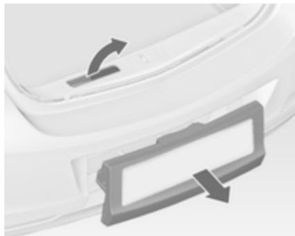
Levante la palanca de desbloqueo. El sistema se desenclava y sale rápidamente del parachoques.
