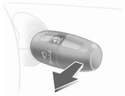
Tire de la palanca. Se pulveriza líquido de lavado sobre el parabrisas y el limpiacristales se realiza el barrido varias veces.
