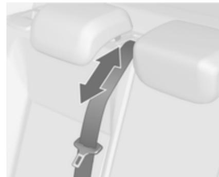
El cinturón de seguridad del asiento central podría bloquearse si el respaldo se endereza demasiado rápidamente. Para desbloquear el
