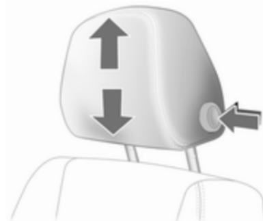
Pulse el botón de desbloqueo, ajuste la altura, enclave.
