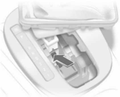
3. Con un destornillador, empuje el trinquete amarillo hacia delante y saque la palanca selectora de **P**. Si se selecciona de nuevo **P**, la palanca selectora volverá a bloquearse. Haga subsanar la causa de la interrupción de corriente en un taller.
