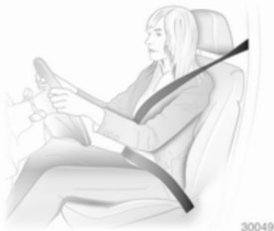
Extraiga el cinturón de seguridad y enclávelo en el cierre. El cinturón de seguridad no debe estar retorcido y debe quedar bien ajustado al cuerpo. El respaldo no debe estar demasiado inclinado hacia atrás (máximo aprox. 25°).
