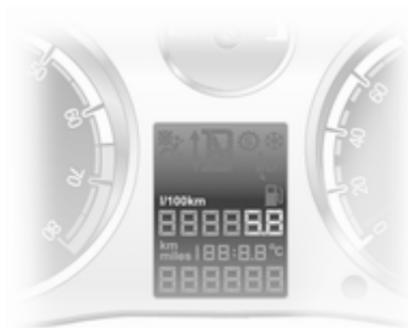
El ordenador de a bordo ofrece información sobre datos de conducción, que se registran de forma continua y se evalúan electrónicamente.
