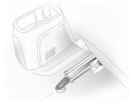
En el revestimiento del pilar en el techo trasero y en los puntos de fijación hay símbolos que indican las argollas donde montar el sistema de retención infantil.
