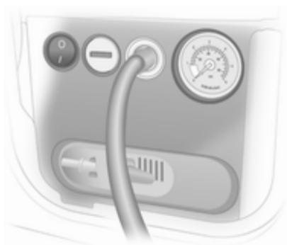
8. Pulse el interruptor de activación/desactivación del compresor. El neumático se llenará con el sellador.
