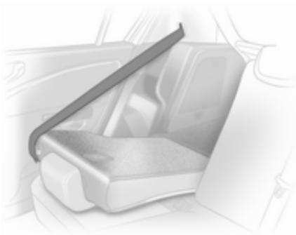
Desenclave el respaldo trasero (de una pieza o dividido), con la palanca de desbloqueo y abatirlo sobre la banqueta de asiento.
