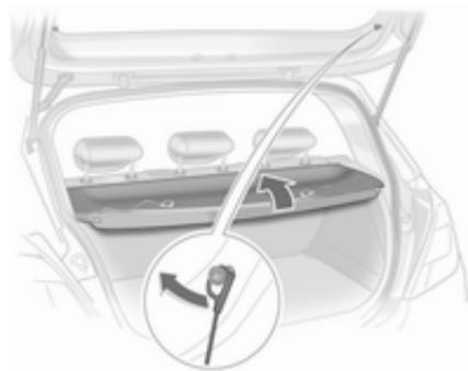
Levante la cubierta hacia atrás, hasta que se desenclave, y luego desmóntela.
