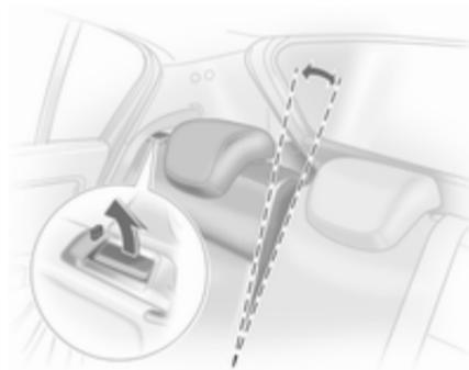
Tire de la manilla de desbloqueo, tire del respaldo hacia adelante hasta la vertical y enclávelo.
