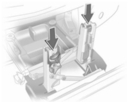
Inserte las fijaciones para las bielas en el alojamiento correspondiente como se muestra en la ilustración.
