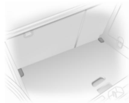
Si se monta en la posición superior, se puede utilizar el espacio entre el piso de carga y la tapa de la cavidad para la rueda de repuesto como compartimento portaobjetos.
