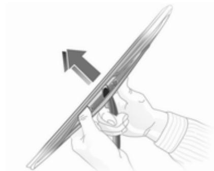
Levante el brazo del limpiaparabrisas. Desacople la escobilla como se muestra en la ilustración y desmóntela.
