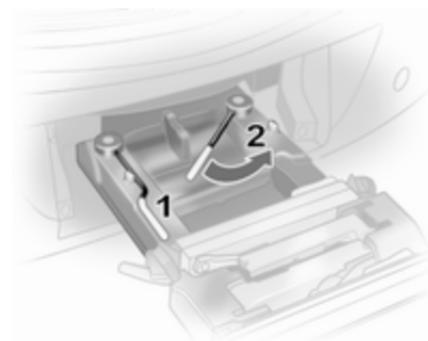
Basculen las palancas tensoras, primero la izquierda (1) y luego la derecha (2), hasta que lleguen al tope. Las dos palancas tensoras deben señalar hacia atrás; en caso contrario, no estará garantizado un funcionamiento seguro.
