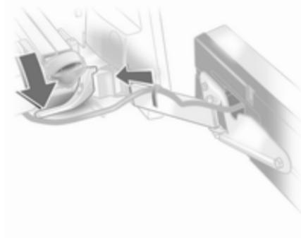
Baje la palanca tensora e inserte el soporte en el alojamiento hasta que enclave.
