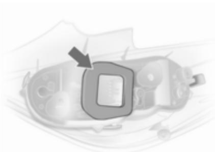
8. Asegúrese de que la junta del portalámparas esté colocada como en la ilustración. Coloque la junta redonda sobre el tornillo de fijación.
