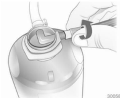
2. Desenrolle el tubo flexible del soporte y enrósquelo en la conexión del bote de sellador.
