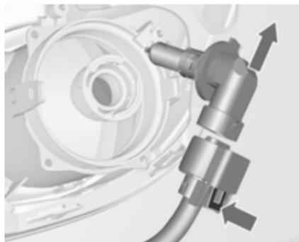
2. Separe el portalámparas del conector presionando el saliente de fijación.
