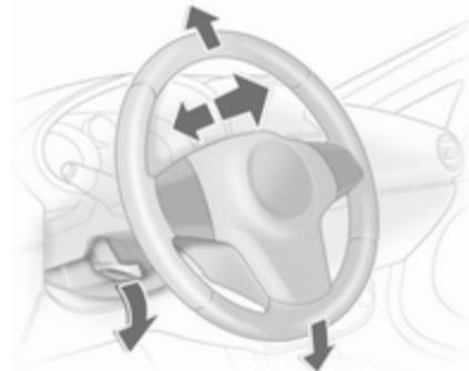
Desbloquee la palanca, ajuste el volante, luego enclave la palanca y asegúrese de que esté totalmente bloqueada. El volante sólo se debe ajustar con el vehículo parado y la dirección desbloqueada.
