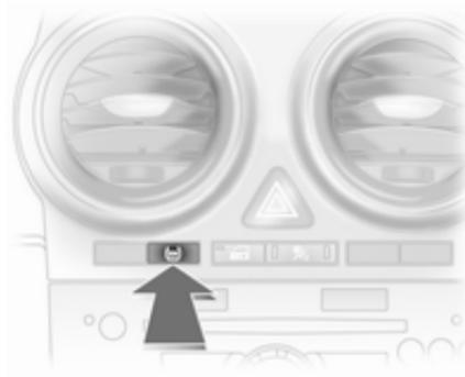
Después de corregir la presión de los neumáticos o cambiar una rueda, debe inicializarse el sistema: conecte el encendido, mantenga pulsado el botón **DDS** durante unos 4 segundos, el testigo de control (⚠) parpadeará tres veces.
