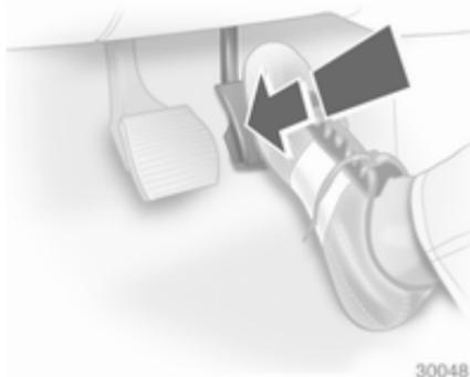
Si se pisa a fondo el acelerador, sobrepasando el punto de presión, se cambia a una marcha más corta dependiendo del régimen del motor.
