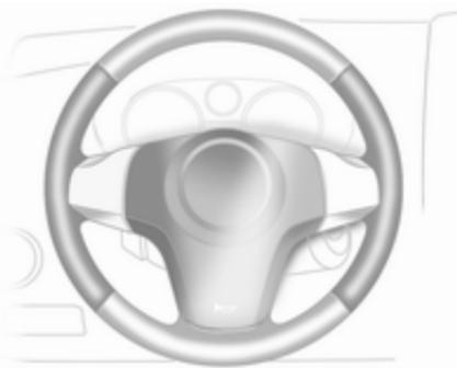
Con el motor en marcha y durante una parada automática (Autostop), se calientan las zonas del volante mostradas en la ilustración.
