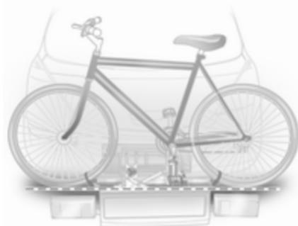
Ajuste los alojamientos para las ruedas de modo que la bicicleta quede en posición horizontal. La separación entre los pedales y el portón trasero debería ser de 5 cm como mínimo.
