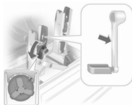
Con el asa giratoria del alojamiento, adapte aproximadamente el asiento para la biela del pedal a la inclinación de la biela.
