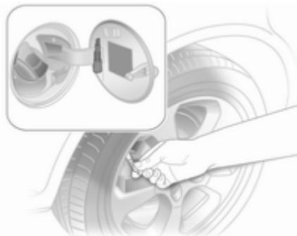
Presión de los neumáticos ⇨ 215 y en la pegatina del interior de la tapa del depósito de combustible.
