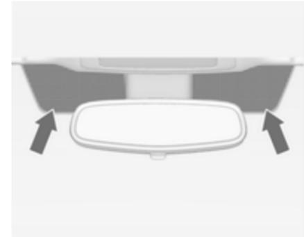
Las zonas indicadas del parabrisas por detrás del retrovisor interior no están recubiertas. Los dispositivos de registro de datos electrónicos y de
