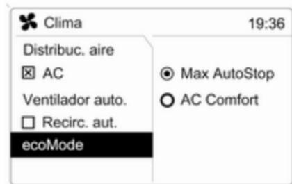
En vehículos con sistema Stop-Start, hay dos ajustes disponibles para el funcionamiento del climatizador durante una parada automática (Autostop).
