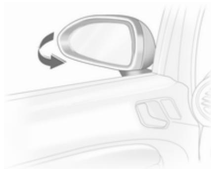
Los retrovisores exteriores pueden plegarse presionando suavemente sobre el borde exterior de la carcasa.
